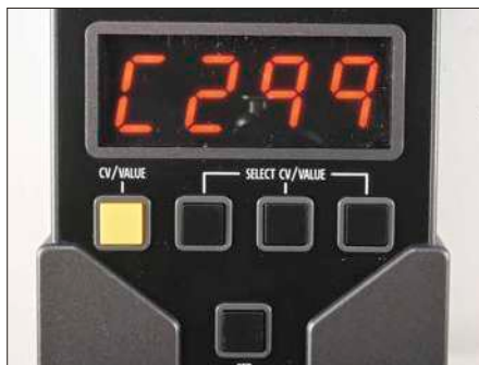
Bei 299 ist Schluss. Höhere CVs können mit dem CV Setter nicht erreicht werden.
