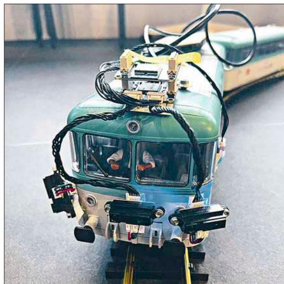
Tinkerforge-Installation mit Infrarot-Abstandssensoren zur Hinderniserkennung an einem Schienenbus in Gartenbahn-Größe
