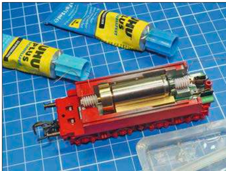
Die neuen Motoren werden mit Zweikomponentenkleber eingeklebt (44 1085).
