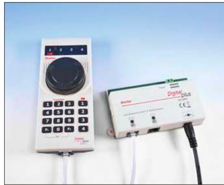
Sehr preiswert ist das Starter-System von Lenz, mit dem bis zu vier Loks mit nur 10 Funktionen gesteuert werden können. Maximal zwei Handregler sind möglich.
