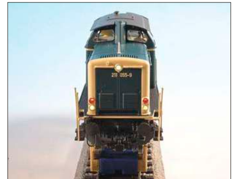
An der Lok schalten die Lampen im Modell mit leichtem Zeitversatz, sodass kurzzeitig alle Lampen leuchten.
