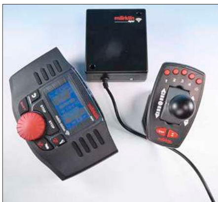
Wird die Gleisbox um die WLAN-Box 60117 erweitert, lassen sich neben der Mobile Station WLAN auch Power Control Sticks nutzen.
