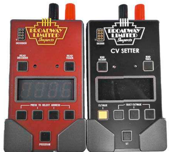
Schon länger erhältlich ist der Address Changer zum Lesen und Einstellen von ein- bis vierstelligen DCC-Adressen. Broadway Limited Imports verwendet bei beiden Geräten das gleiche Konzept und Gehäuse. Alle Fotos: Heiko Herholz
