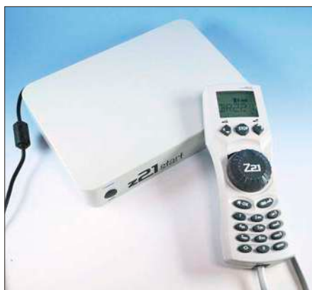
Da die Verwaltung von bis zu 100 Loks möglich ist, kann die z21start auch gut für mittlere und größere Anlagen eingesetzt werden.
