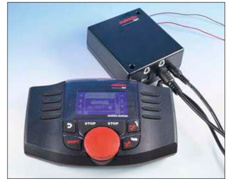
MS2 und Gleisbox von Märklin/Trix sind Multiprotokoll-Zentralen mit automatischer MFX-Anmeldung. Die MS2 kann als Handregler an der CS3 genutzt werden.
