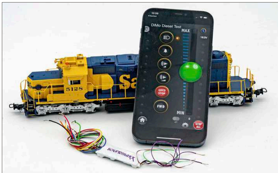
Die Steuerung einer Lok mit dem Telefon, das man ohnehin immer dabei hat, ist naheliegend. Die Systeme geben eine große Auswahl. Das Blunami-System erlaubt wahlweise eine Steuerung über das DCC-System oder direkt per App über Bluetooth. Foto: Hans-Jürgen Götz
