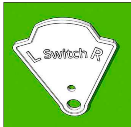
Auf diesen Plates werden die Schalter für die Weichen montiert. In der unteren Bohrung wird ein Drehschalter mit 6 mm Schaftdurchmesser eingesetzt.
