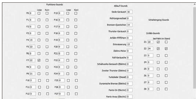
Im Programm DecoderPro lassen sich viele Dinge bequem konfigurieren, wie hier das Abspielen von Zufallsgeräuschen.
