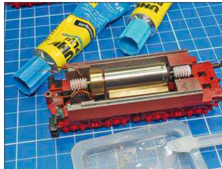
Bei der 44 1315 ist die Schwungmasse vorne angeordnet.
