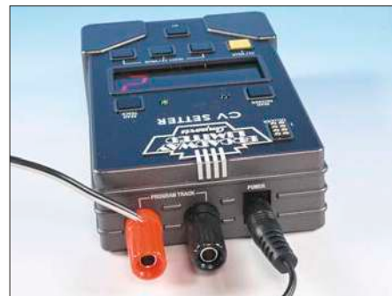
Der Gleisanschluss erfolgt durch Einklemmen von Drähten oder mit 4-mm-Steckern.
