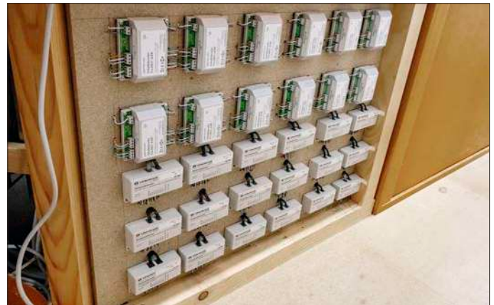
Schaltdecoder von Littfinski und Rückmeldebausteine von Uhlenbrock sind an zentraler Stelle montiert.
