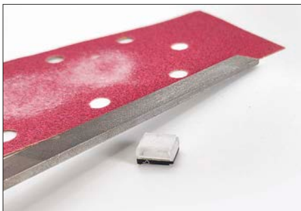
Die Seitenwände des Einbauraums haben kleine Absätze. Damit der Lautsprecher tief genug eintauchen kann, muss er beschliffen und mit Stufen versehen werden. Das geht sehr gut mit Feile und Schleifpapier.
