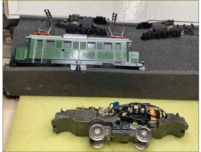
Schritt 2: Das Gehäuse ist ab. Stück für Stück wird nun die alte Antriebstechnik zerlegt.
