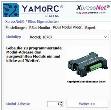
Die Adressen von R-Bus-Rückmeldern lassen sich bequem einstellen.
