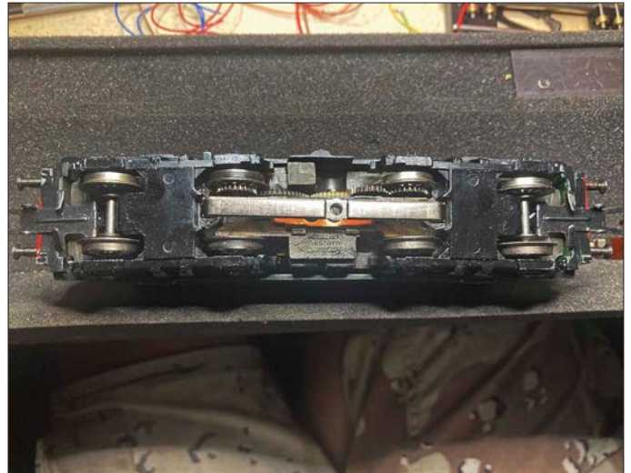
Schritt 10: Im Zuge des Umbaus sollten auch die Haftreifen und der Schleifer erneuert werden.
