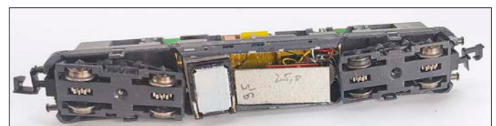
Bauteilanprobe: Links findet der Zuckerwürfel-Lautsprecher gerade so seinen Platz, daneben ist die Schablone mit den Abmessungen eines Next18-Sounddecoders eingesetzt – passt!
