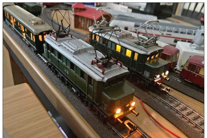
Vorne die hier umgebaute E 44 (Primex 3008). Daneben steht das ältere Märklin-Modell SET 800, das schon vor einiger Zeit eine aufwendige Digitalisierung mit vielen Funktionen und einem mit Zweifarb-LEDs realisierten weiß-roten Lichtwechsel erhalten hat.
