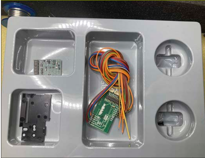
Schritt 1: Der Decoder kommt als Teil eines Einbausets mit 21mtc-Platine, Halter und Schraube.
