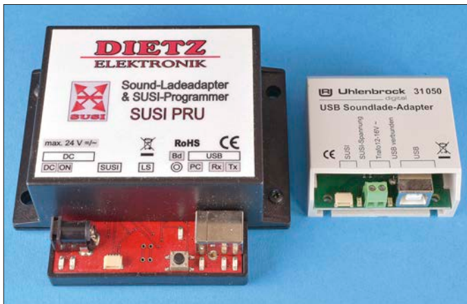
Mit den SUSI-Programmern von Dietz und Uhlenbrock lassen sich alle SUSI-Soundmodule beider Hersteller bespielen.
