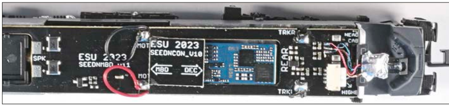
Der Decoder befindet sich in der Eurodual in einem Ausschnitt der Lokplatte direkt über dem Motor. Daher ist es notwendig, den von Sudexpress mitgelieferten Brückenadapter zu verwenden, an dem dann der Decoder auch mechanisch hängt.
