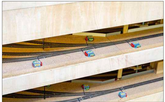
In den nicht sichtbaren Bereichen sind alle Antriebe oberflur angeordnet. Das erleichtert die Wartung enorm.
