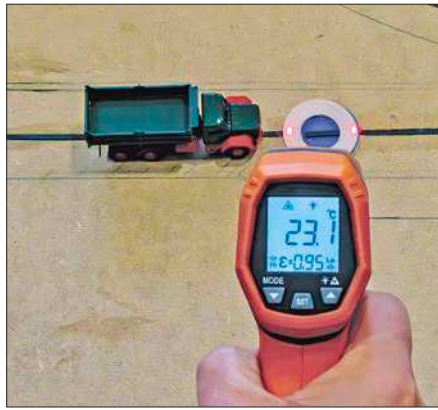
Wo elektrische Energie durch Spulen fließt entsteht auch Wärme. In einem eher kühlen Modellbahnraum heizt sich die Spule bis auf 23 Grad Celsius auf.
