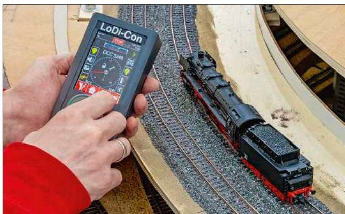
Für die Handsteuerung von Triebfahrzeugen vor allem in Rangierbereichen kommt der WLAN-Handregler LoDi-Con zum Einsatz.
