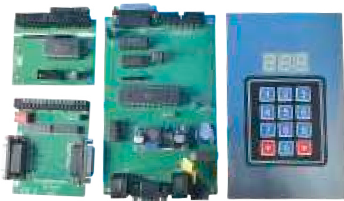
Bis auf ein Netzteil ist im Trackswitch-Startset von Digimoba alles enthalten, was man braucht, um acht Weichen anzusteuern.
