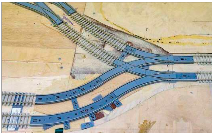
Auf der gesamten Anlage sind Gleise von Tillig verbaut. Bei den Tram-Gleisen kommt das Luna-System von Tillig zum Einsatz.
