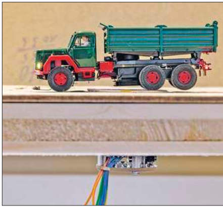
Durch passende Positionierung der Steuerungsmagneten und etwas elektronische Intelligenz wird der Lkw korrekt auf der Spule positioniert.
