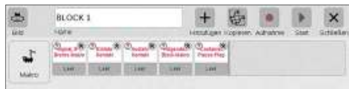
Ablaufleiste des geöffneten Blockmakros zur Gleisabschnittssteuerung mit den fünf noch leeren Containern
