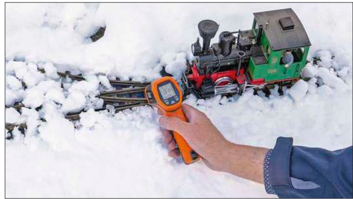
Im Betrieb steigt die Temperatur an der Weiche auf 31,4 Grad Celsius. Das reicht für eine sichere Funktion der Weiche.
