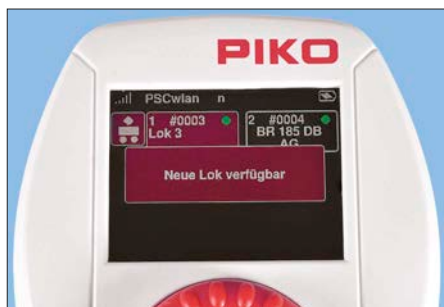
Die Lok mit der Adresse 3 ist ab Werk eingestellt. Die 185 wurde schon vom System gefunden und jetzt hat sich gerade mit der 218 die zweite Lok angemeldet.
