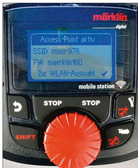
Findet die MSW kein WLAN, so spannt sie zur Konfiguration ihr eigenes auf.
