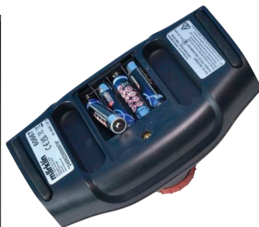
Die MSW wird mit vier Batterien oder Akkus der gängigen Größe AAA betrieben. Märklin hat bei Versuchen eine Laufzeit von bis zu 60 Stunden mit einer Batteriefüllung erreicht. Der verwendete Batterietyp ist im Menü einstellbar.
