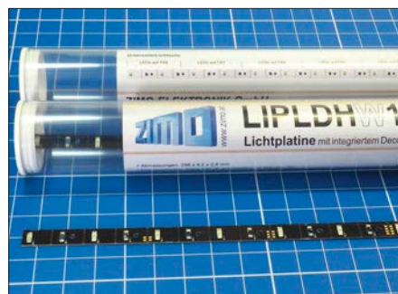
Die Beleuchtungsplatinen von Zimo haben einen integrierten Funktionsdecoder.
