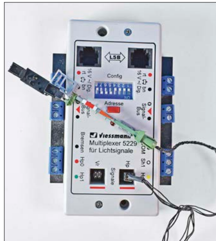
Für die Multiplex-Signale von Viessmann sind spezielle Multiplex-Decoder erforderlich.
