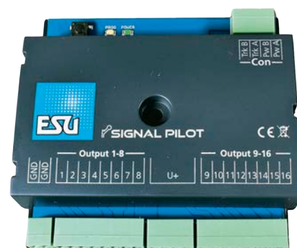
Der Signalpilot von ESU ist ein Decoder, der auch die Erzeugung komplexer Signalbilder ermöglicht.
