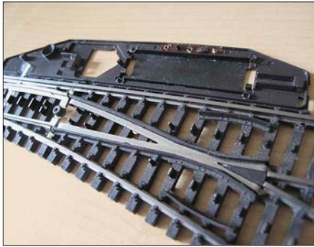
Die kurze Weiche 2261 nach der Entfernung der Spule.
