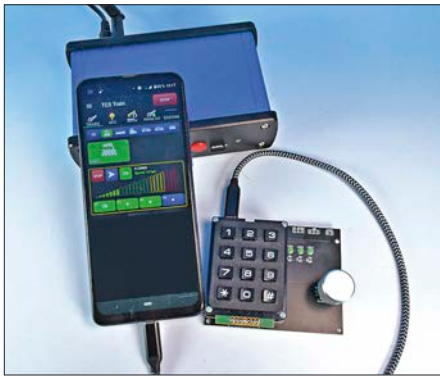
Das Gerät wird per USB mit dem Smartphone verbunden und ist ein Add-On zur TCS-App für die TCS-2-Zentrale (hinten).
