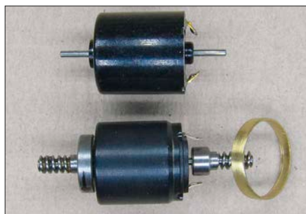
Deutlich sichtbar ist der Unterschied zwischen Originalmotor oben und dem Faulhabermotor. Zum Ausgleich wird hier ein Messring aufgesetzt.
