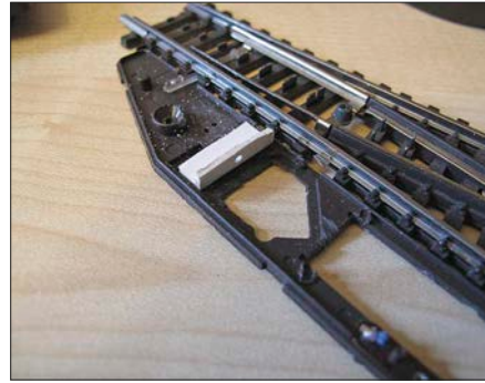
Der „Drehpunkt“ besteht aus einem Polystyrol-Winkel und wird eingeklebt.
