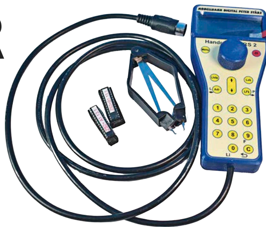
Mit neuem Handregler und Chip-Tuning bleibt das Stärz-Digitalsystem immer auf dem aktuellen Stand. Alle Fotos: Heiko Herholz
