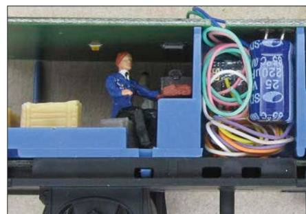
Ein Elektrolytkondensator wird als zusätzlicher Pufferkondensator eingelötet und findet seinen Platz im WC-Raum. Dieser begrenzt dabei auch die Größe des Elkos.
