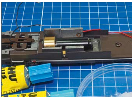
Der Originalmotor weicht einem Faulhaber-Motor mit Schwunghasse von sb-Modellbau.
