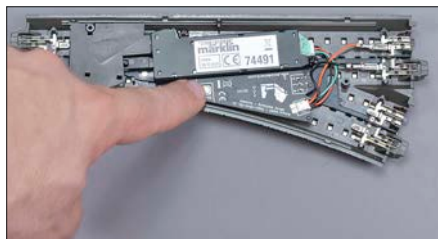
Der Decoder von Decoderwerk.de passt perfekt in die C-Gleis-Weiche und lässt sich per Programmiertastermethode einstellen.
