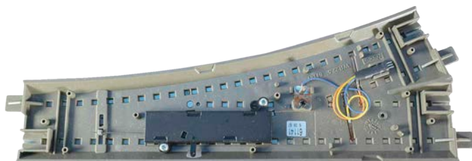
Handweichen im geoLine-System von Roco sind tatsächlich mit einem mechanischen Antriebskasten ausgestattet. Grundsätzlich bietet sich hier die Aufrüstung zu einem digitalen Antrieb an, ...
