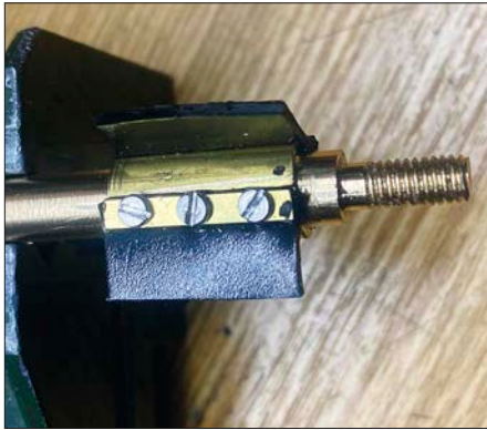
Das Zellrad besteht aus drei Zellen mit jeweils einem Hartgummistreifen, der mit einem Messingblech auf einer Achse befestigt ist.
