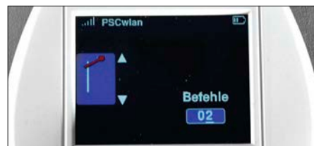
Das System erlaubt die Benutzung des erweiterten Zubehördecoderformats, bei dem Signalbegriffe gesendet werden.
