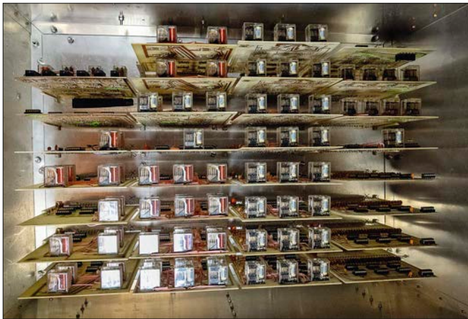
Das CMOS-Rechenwerk für die Automatiksteuerung der Anlage stammt aus einer Zeit, als es noch keine Programme wie Win-Digipet, iTrain und TrainController gab.
