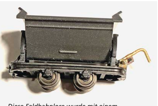
Diese Feldbahnlore wurde mit einem beweglichen Haken als Kupplung modifiziert. Im gekuppelten Zustand greift der Haken in einen Bügel an der Lok. Direkt unter dem Haken sitzt ein kleiner Permanentmagnet, der beim Entkuppeln durch einen Elektromagneten unter dem Gleis abgestoßen wird.
