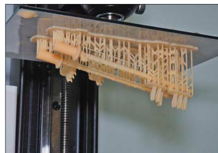
Nach dem Ausdruck tropfen die Modelle noch eine Weile ab.
