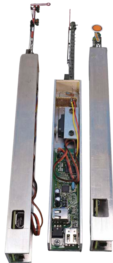
Die Wattenscheider Signalträger sind wirklich so lang, wie sie aussehen. In der Mitte ist der Wattidecoder mit LotusNet-Anschluss zu erkennen. Alle Fotos: Heiko Herholz
