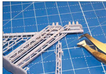
Im Slicer (links) werden die Signale so angeordnet, dass sie sich sicher drucken lassen. Die Stützen (Supports), die das Modell an der Druckplatte halten, müssen sehr vorsichtig entfernt werden (unten).
