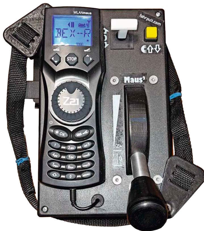
Die WlanMaus benötigt einen kleinen Umbau und wird auf dem StillerTec-Pult befestigt. Die Maus dient nur zur Lokauswahl und zur Funktionssteuerung. Die Fahrbremssteuerung erfolgt mit den StillerTec-Hebeln.
