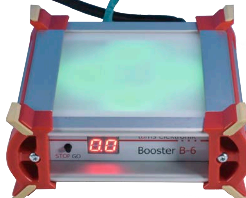
Der Booster B-6 bringt eine zweistellige LED-Anzeige mit, die im Betriebsmodus den Stromverbrauch am Gleis Ausgang anzeigt.
