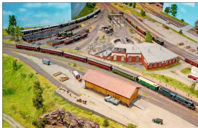
Die Königskurve am Bahnhof Brötzingen bildet ein Gleisdreieck, in dessen Mitte das Bahnbetriebswerk liegt. Die Kurzschlussverhinderung im Gleisdreieck übernimmt ein Kehrschleifenmodul LK200 von Lenz.
