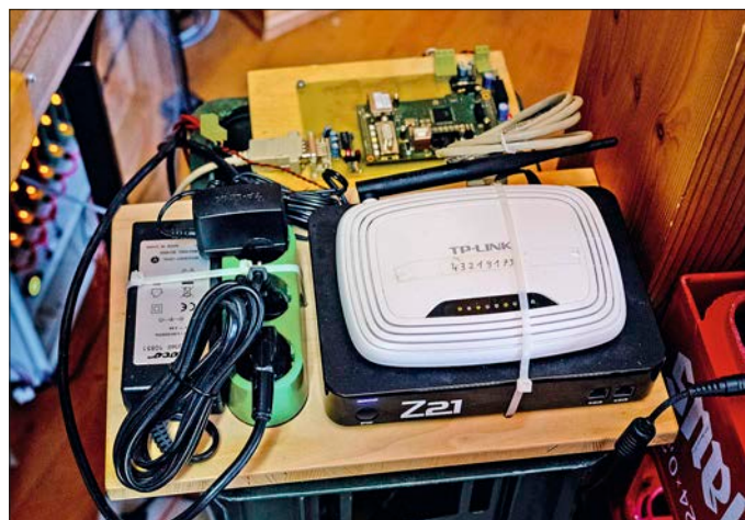
Als Digitalzentrale kommt eine schwarze Z21 zum Einsatz, da viele Komponenten mit LocoNet angeschlossen sind.
