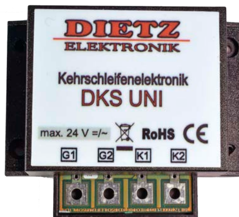
Das Dietz-Kehrschleifenmodul bietet zum Übertragen großer Ströme robuste Anschlüsse. Foto: Heiko Herholz
