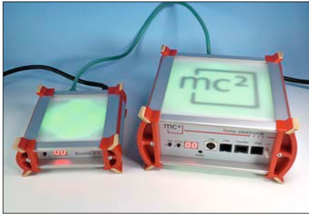
Die RGB-LEDs in der mc² und dem Booster geben Auskunft über den Status der Geräte. Ist alles grün, liegt Spannung am Gleis an.
