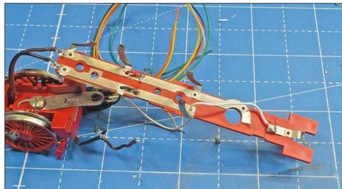
Der Anschluss des weißen Kabels für das Spitzenlicht liegt auf der Unterseite der Leiterplatte.
