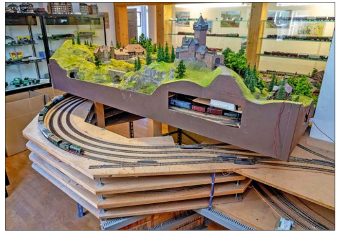
Nach dem Umbau der Anlage werden Gleiswendeln von RocRail komplett automatisch gesteuert.
