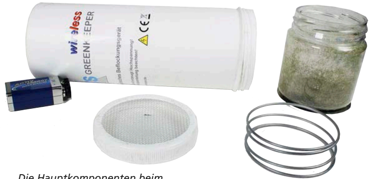
Die Hauptkomponenten beim RTS Greenkeeper wireless sind das weiße Gerät selbst, eine 9-V-Blockbatterie, ein zum Flock passendes Schraubgitter, ein Flockbecher und eine Feder zur Übertragung des Ladungsüberschusses aus dem Gerät auf den Becherboden.
