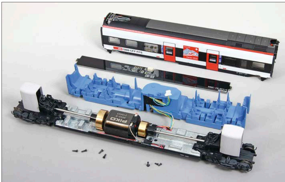
Der Aufbau der Giruno-Wagen basiert auf einem Chassis, welches auf den Jakobsdrehgestellen ruht. Unter Abdeckungen und der Inneneinrichtung sind die Platinen und der Zugbus verbaut. Die Beleuchtungs-LED der Zugzielanzeiger befinden sich im Chassis (hier neben dem Motor), Lichtleiter sorgen für die Illumination der Anzeiger. Auf der Inneneinrichtung ist die Beleuchtungsplatine verbaut. Bei der Montage der Modelle sollte man darauf achten, dass die Drähte nicht gequetscht und beschädigt werden. Fotos: Sebastian Koch
