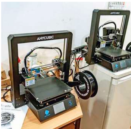
In Bispingen kommen mehrere 3D-Drucker zum Einsatz. Gedruckt werden hier unter anderem Ersatzteile für Fahrzeuge sowie Gehäuse und Halterungen aller Art.
