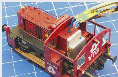
Die Litzen werden durch eine vorhandene Bohrung ins Führerhaus gelegt und an den Speicherbaustein gelötet.
