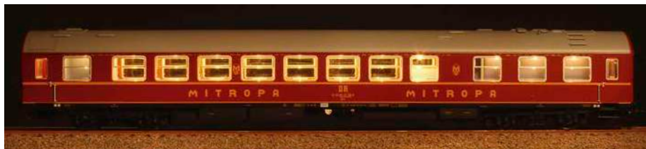
Der Wagen verfügt über eine warmweiße Beleuchtung. Speiseraum, Küche, Kassenbereich und Gang sind separat beleuchtet. Die Fensterrahmen sind bedruckt, an den Übersetzfenstern wurden sogar die Befestigungsschrauben nachgebildet.
