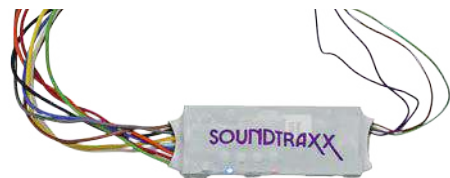
Eine blaue und eine rote LED zeigen den Decoder-Status an und dienen zur Schnell-diagnose von Fehlern.
