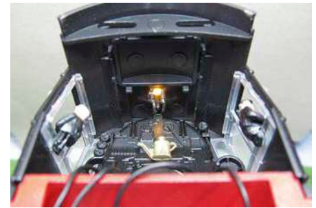
Die bereits im Führerhausdach montierte Führerstands-LED samt ihrer Anschlusslitzen. Die beiden anderen Litzen führen zum Lautsprecher.
