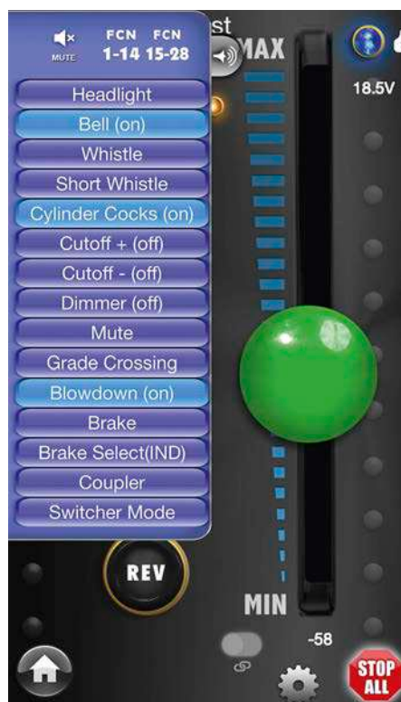
Die Bedienung der App ist intuitiv. Alle Hauptfunktionen sind direkt erreichbar. Für zusätzliche Funktionen wird ein Menü ausgeklappt.
