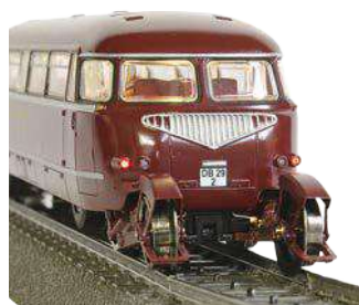
Die Beleuchtung wurde komplettiert. V.l.n.r.: Scheinwerfer vorne, Rückleuchten; bei Rückwärtsfahrt: rote Leuchten vorn, weiße hinten
