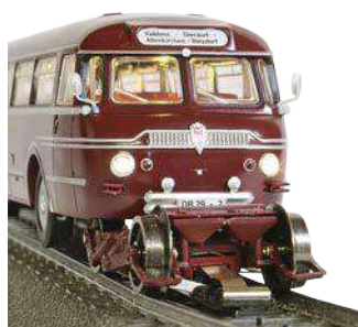
Die Beleuchtung wurde komplettiert. V.l.n.r.: Scheinwerfer vorne, Rückleuchten; bei Rückwärtsfahrt: rote Leuchten vorn, weiße hinten
