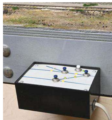
Bei diesem Stellpult wird ein ATmega328 verwendet. Das Pult wird aus dem LocoNet versorgt und mit einer Schraubzwinge an der Modulseitenwand befestigt.
