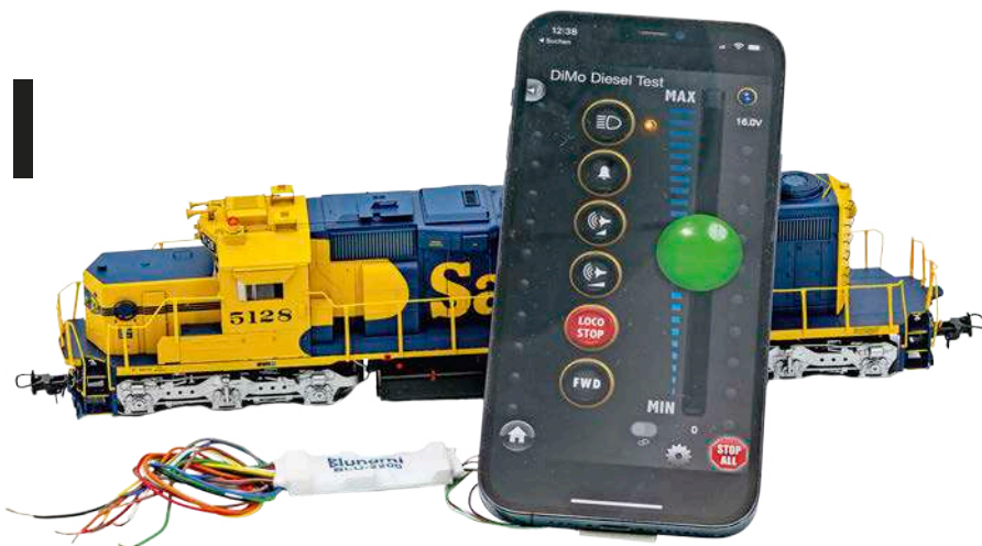
Der Blunami-Decoder ist für US-Loks gedacht und bietet neben Sound die Möglichkeit der direkten Steuerung mit einer App über eine Bluetooth-Verbindung. Alle Fotos: Hans-Jürgen Götz
