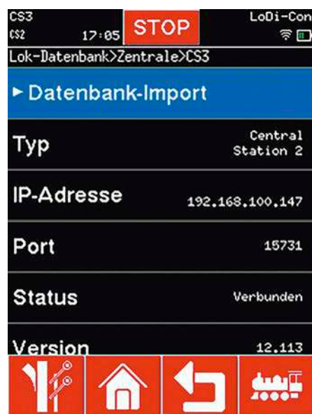
LoDi-Con kann alle nötigen Daten aus der CS2 und CS3 importieren.
