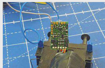
Die Litzen zum Speicherbaustein werden vorsichtig an den Decoder gelötet.
