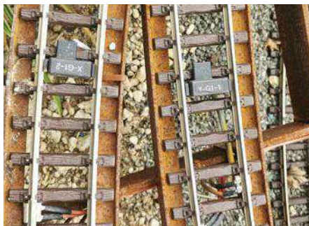
Für Belegtmeldungen sind die Fahrzeuge mit Magneten und die Gleise mit Reedkontakten ausgestattet. Die Auswertung erfolgt durch MKTW-Melder.
