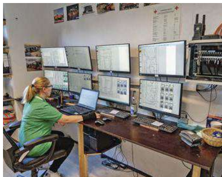
Im Steuerstand sind zahlreiche Monitore vorhanden. Von hier aus werden alle Anlagenteile gesteuert. Die Anbindung der Anlagen erfolgt über lange XpressNet-Kabel.
