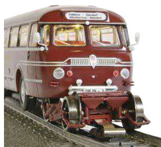
Die Beleuchtung wurde komplettiert. V.l.n.r.: Scheinwerfer vorne, Rückleuchten; bei Rückwärtsfahrt: rote Leuchten vorn, weiße hinten
