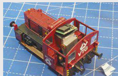
Der Speicherbaustein wird mit einem Stück Powerstrip fixiert; er beeinträchtigt den Führerhausdurchblick nicht.
