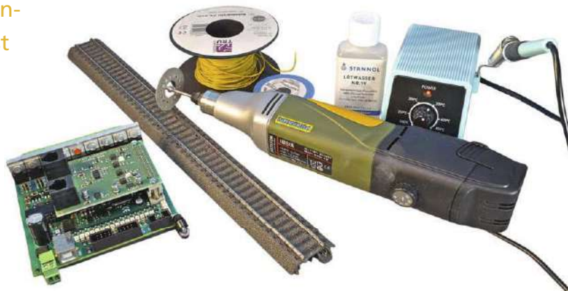
Mit einem Diamantblatt auf einer Kleinbohrmaschine lassen sich kaum sichtbare Isolierlücken in Märklin-Gleise schneiden. Foto: Heiko Herholz
