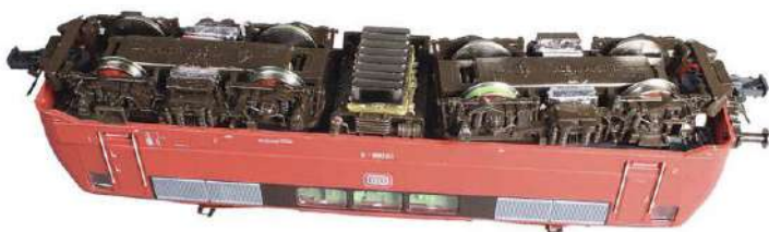
Insgesamt zwölf Magnete – je zwei hinter den Wangen der Drehgestelle und acht in der Mitte zwischen den Drehgestellen – sorgen für einen hinreichenden Anpressdruck auf dem Gleis, durch den das Kunststück vom Aufmacherbild möglich wurde.
