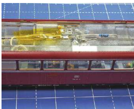
LEDs und Widerstände finden innerhalb des Beleuchtungskörpers Platz.
