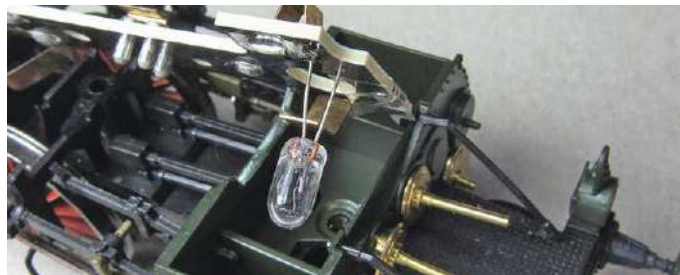
Zuerst habe ich die Glühlämpchen in Lok und Tender durch LEDs ersetzt. Dabei müssen die langen Beine der Glühlämpchen durch Platinenstreifen gleicher Länge ersetzt werden.
