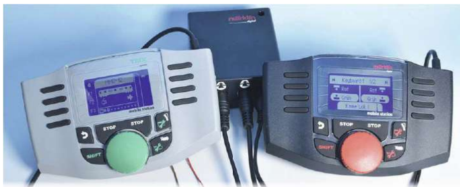
Trix und Märklins Mobile Station II sind identisch. Zwei MS II lassen sich direkt an der Gleisbox betreiben. Über Adapter lassen sich bis zu acht weitere MS II anschließen.
