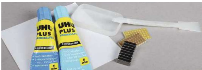
Klebstoff, Platinenstücke als Unterfütterung und ein Block aus acht Magneten nutzen den Platz unter der Lok optimal aus.
