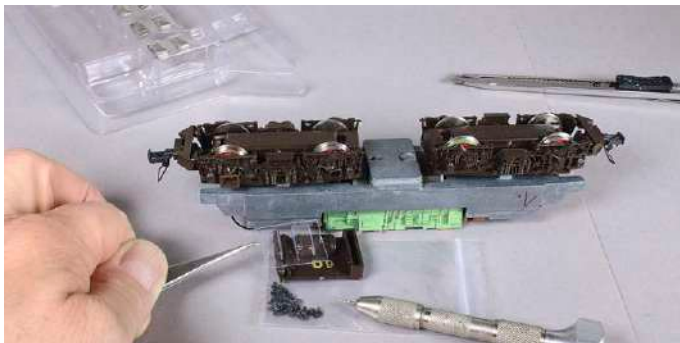
Der Hersteller sieht vor, die tiefgezogenen Halteschalen der Magnete für deren Montage an der Lok zu verwenden. Dazu werden kleine Schrauben und ein 0,9-mm-Bohrer mitgeliefert.
