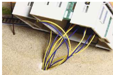
Die Lichtkästen werden in unterschiedlichen Größen aus gedrucktem Kunststoff geliefert. Man befreit sie von Angüssen und klebt die LED-Platinen am oberen Rand ein.
