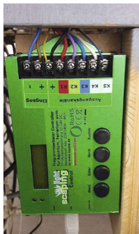
Der TC420-Controller bringt mit einem Ausgangsstrom von 4 Ampere je Kanal mehr als genug Leistung. Die Schraubklemmen müssen gut angezogen werden, da hier erhebliche Ströme fließen können.
