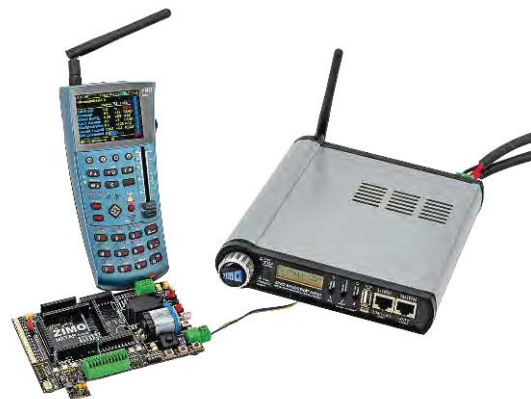
Auch die Zimo-Zentrale MX10(EC) unterstützt das Programmieren von Decodern über den Handregler MX32(FU) und via LAN-Schnittstelle durch das Programm ZCS.
