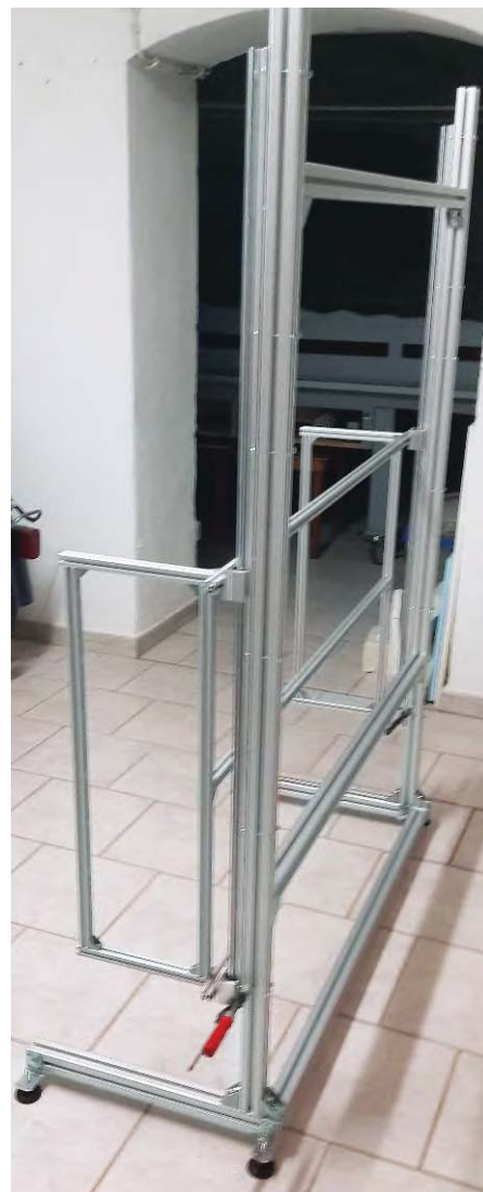
Das Grundgestell besteht aus Alu-Profilen 40 x 40 mm.
