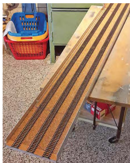
Die einzelnen Ebenen bestehen aus Multiplex-Platten mit Alu-Winkeln an den Längsseiten. Die Gleise liegen auf Kork, an den Enden auf 3-mm-HDF-Streifen.
