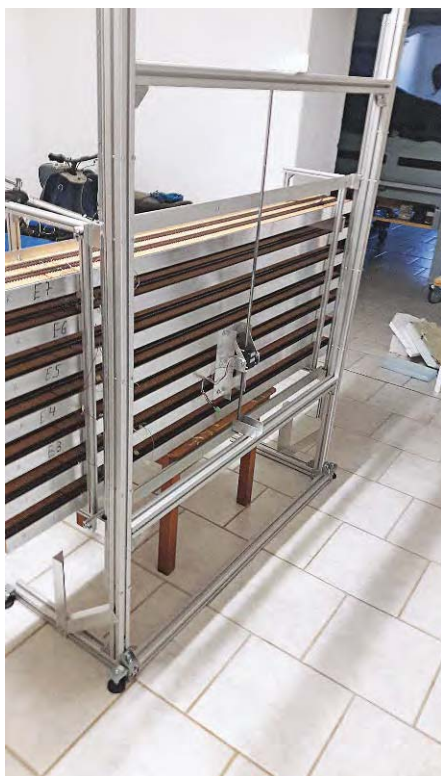
Motor und Spindel sind eingebaut und ausgerichtet. Nun sollen die Gleisebenen zum ersten Mal gehoben werden.
