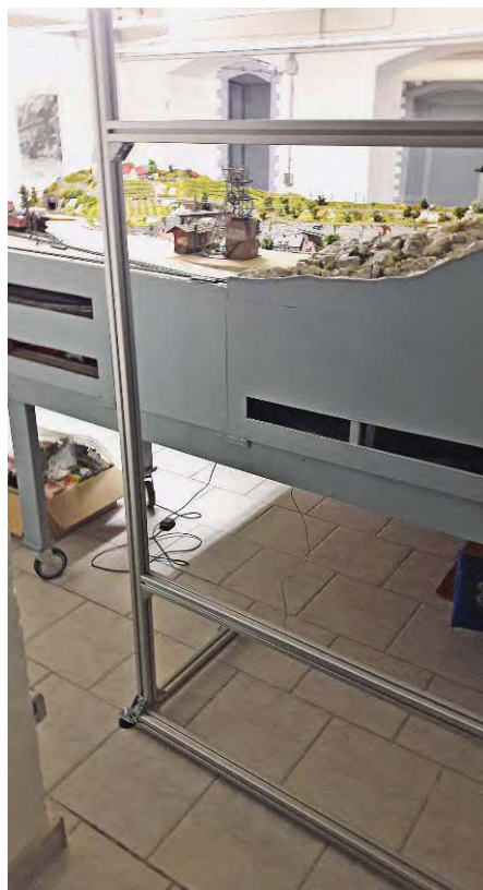
Das Grundgestell besteht aus Alu-Profilen 40 x 40 mm.
