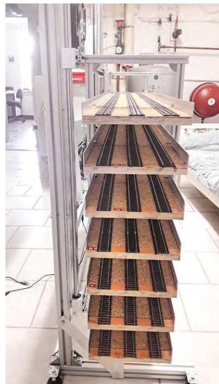
Hier sind die Ebenen provisorisch montiert. Es zeigte sich, dass der Rahmen noch eine Versteifung gegen diagonale Verschiebungen über die lange Strecke benötigte.
