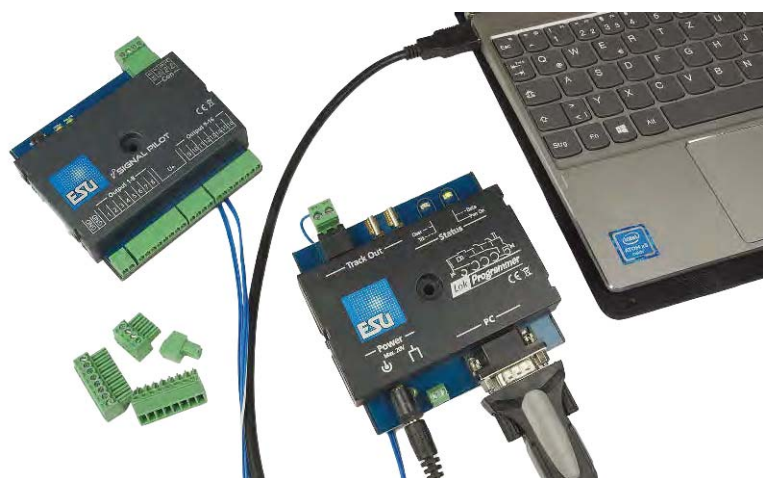
Zur komfortablen Konfiguration des Esu SignalPilot wird der LokProgrammer aus gleichem Hause empfohlen. In Verbindung mit einem PC gestattet dieser eine übersichtliche Einstellung aller Funktionen und eine unkomplizierte Inbetriebnahme.
