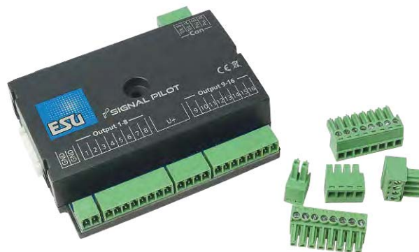
Der Esu SignalPilot verfügt über 16 Transistorausgänge und gestattet neben dem Anschluss von LED Signalen auch den Betrieb von motorischen Signal- und Weichenantrieben oder Glühlampen.
