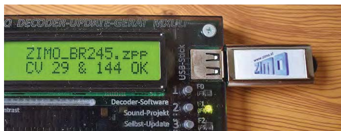
Decoder-Update ohne PC geht mit dem MXULFA von Zimo. Die benötigten Daten kommen auf einem USB-Stick zum Gerät.
