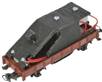
Der einsatzbereite Kamerawagen mit M5stack ESP32-Kamera
