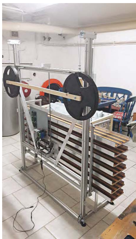
Die fast fertige Konstruktion mit den (Gegen-)Gewichtsscheiben. Hier erkennt man auch die Diagonalversteifung des Rahmens mit den Gleistrassen.
