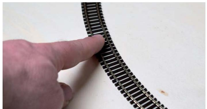
Nach dem Zusammenstecken sollte man nochmal mit dem Finger über den Schienenkopf fahren. Ist alles eben, dann ist alles richtig zusammengesteckt.
