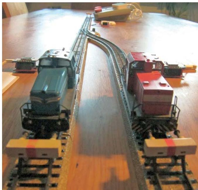
CS2 mit angeschlossenem Router und einer Pendelstrecke mit drei WLAN-Meldern. Die Loks L1 und L2 stehen startbereit mit dem Heck zur Weiche mit eingestellter Fahrtrichtung „rückwärts“. Die Gleislängen sind beliebig und können jederzeit verändert werden. Da WLAN-Melder am Gleis zum Einsatz kommen und sich der Weichendecoder unter der Weiche befindet, gibt es nur ein Kabel zur Zentrale.
