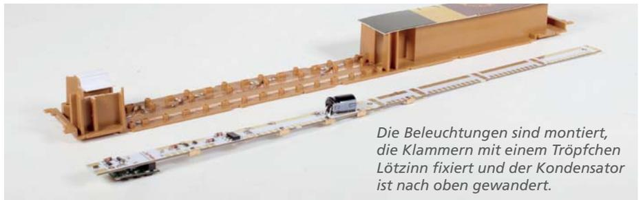
Die Beleuchtungen sind montiert, die Klammern mit einem Tröpfchen Lötzinn fixiert und der Kondensator ist nach oben gewandert.
