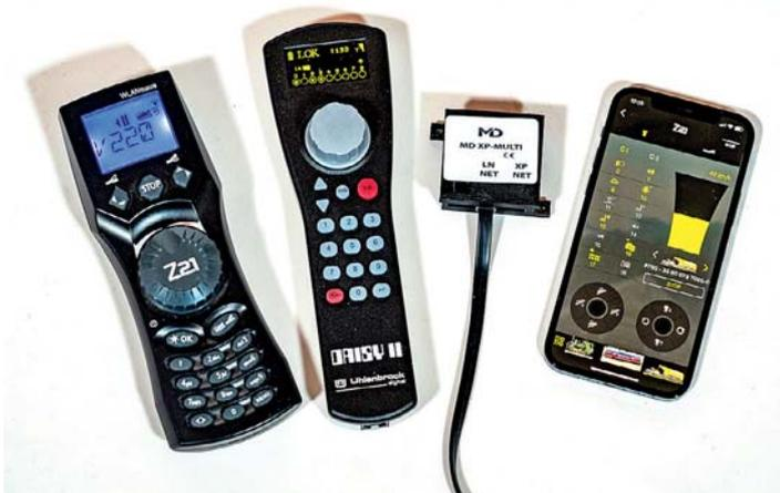
Von Haus aus kann die MZSpro Zentrale via WLAN mit Rocos WLAN-Maus oder der Z21-App bedient werden. Sobald man das XP-Multi am XpressNet anschließt, können zusätzlich auch LocoNet Regler wie die Daisy II von Uhlenbrock verwendet werden.
