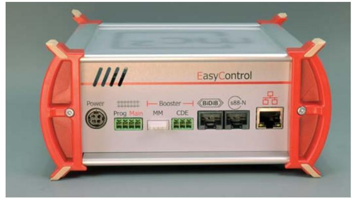
Auf der Rückseite sind Anschlüsse für Gleisgänge, Booster, BiDiB, S88-N und Netzwerk vorhanden. Der Power-Stecker entspricht dem, was Märklin derzeit verwendet.
