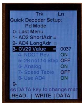
Das Decoder-Setup ist weitgehend selbsterklärend: Würde man nun die Taste „5“ drücken, würde auf den 28-Fahrstufenmodus umgeschaltet („ON“), ein weiterer Druck auf „5“ schaltet zurück auf 14 Fahrstufen.
