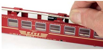
Der Kondensator ragt in den Speiseraum und kollidiert mit einer Querverstrebung.
