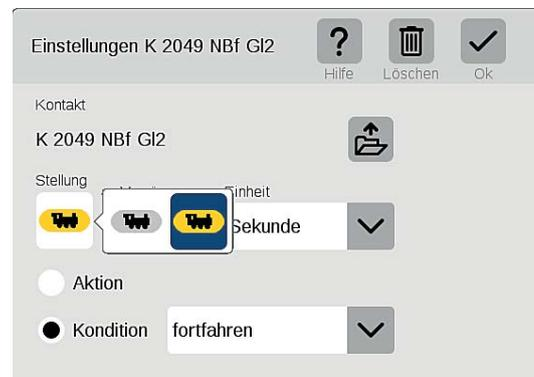
(13) Nunmehr ist unter „Stellung“ noch die Auswahl des richtigen Icons erforderlich. Damit auf dem Display der CS3 die Lokanzeige angezeigt wird, wird die belegt meldende Lok, also das gelbe Icon, herangezogen. Bei „Kondition“ muss ein Button und das Listenauswahlfeld auf „fortfahren“ gesetzt werden.
