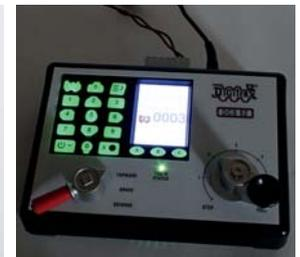
Das DCS52 von Digitrax bietet haptische Bedienelemente. Besonders charmant: Man kann hier einen analogen Regler anschließen!
