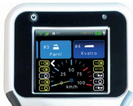
*Blick auf das Display des Handreglers: Die Piktogramme in der Kopfzeile sind selbsterklärend. In der Zeile darunter stehen alle angelegten Triebfahrzeuge zur Auswahl. Die Geschwindigkeits- und Funktionsanzeige ist ebenfalls selbsterklärend. Die höheren Funktionsnummern lassen sich einblenden.*
