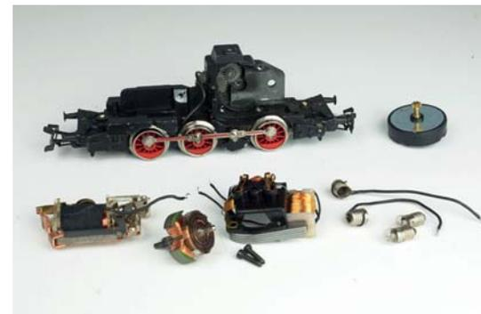
Der kleine Scheibenkollektormotor, der mechanische Fahrtrichtungsumschalter sowie die alten Glühlampen wurden komplett entfernt. Der neue Flachläufermotor liegt schon bereit (im Bild rechts neben dem Fahrgestell).
