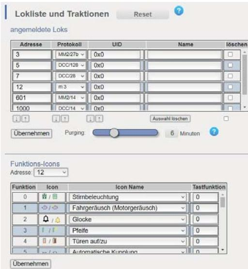
InfinityCube und mc<sup>2</sup> sind intern großzügig mit Speicher ausgestattet. Über das Web-Interface lassen sich umfangreiche Einstellungen an den Fahrzeugen vornehmen. Neben Protokoll-Einstellungen lassen sich auch Namen, Funktionstasten und Funktionssymbole bearbeiten. Selbst das Anlegen von Doppeltraktionen ist hier möglich.
