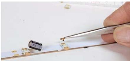
Die LED-Platinchen werden mit Klammern befestigt, die gleichzeitig die elektrische Verbindung herstellen.
