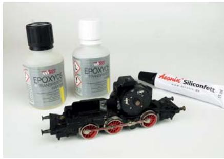
Der neue Antrieb wird mit 2K-Epoxy-Kleber einfach mit dem Getriebegehäuse verklebt. Zuvor sollten selbstverständlich alle beweglichen Teile gründlich gereinigt und leicht gefettet werden.
