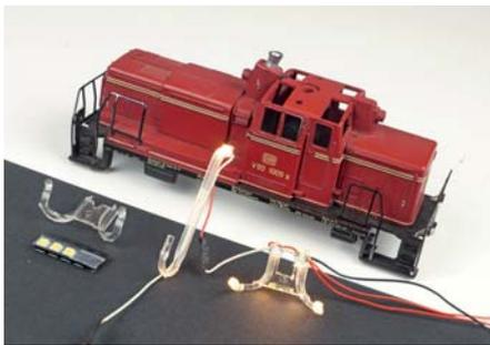
Für den rot/weißen Lichtwechsel sorgen Duo-LEDs in warmweißer/roter Farbe. Sie können mit Kabeln versehen direkt hinter den originalen Lichtleitern verklebt werden.
