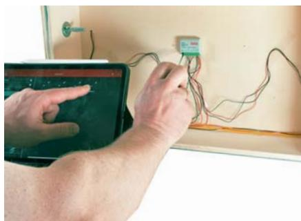
*Smarte Konfiguration: Die Weichendecoder brauchen noch Adressen. Dazu werden die Decoder per Taster in den Programmiermodus gebracht und in der SmartProgrammer-App die passende Weiche geschaltet.*
