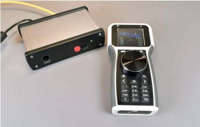
Die beste Umgebung für den neuen Handregler ist die TCS-Digitalzentrale von Zavavov. Hier funktioniert auch die ziemlich coole Nutzerverwaltung.
