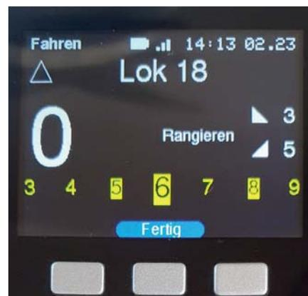
Modus „Lokfunktionen ändern“: Aktiv sind die Funktionen 5, 6 und 8 (weitere können durch Drehen erreicht werden) und 6 ist die durch Drücken des Drehreglers setzbare Funktion.
