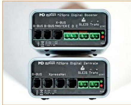
Die beste Verbindung zwischen Booster (oben) und der Zentrale ist der B-Bus.
