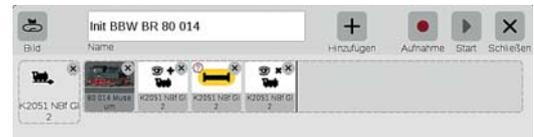
(12) Für die Initialisierung holt man sich dasselbe Kontaktgleis ein zweites Mal. Wer möchte, dass sich die Anzeige nach einer gewissen Dauer wieder ausblendet, setzt das Element ein drittes Mal ein; der Zeitverschub wird im zweiten Icon eingetragen. Und wer die Baureihenbezeichnung nach einem Klick auf das Kontaktgleis-Icon im Gleisbild ablesen möchte, holt sich den Rückmelder ein viertes Mal in die Ablaufleiste (Handbetrieb).
