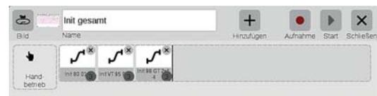
(14) Um die gleichzeitige Initialisierung sämtlicher Loks, für die die Standortabfrage relevant sein soll, zu erreichen, müssen zuletzt noch alle Positionsergebnisse in einem weiteren „Ereignis“ zusammengefasst werden. Hierzu werden die drei Lokereignisse in die Ablaufleiste gezogen.
