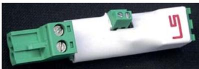
Ein fertig aufgebauter Boosterviewer, der direkt in den Booster gesteckt werden kann. Oben die Anschlüsse für die Masse – in und out.
