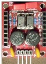
So sieht die Stromfühlerplatine bestückt aus. Eine bebilderte Anleitung zum Löten der Strom-
