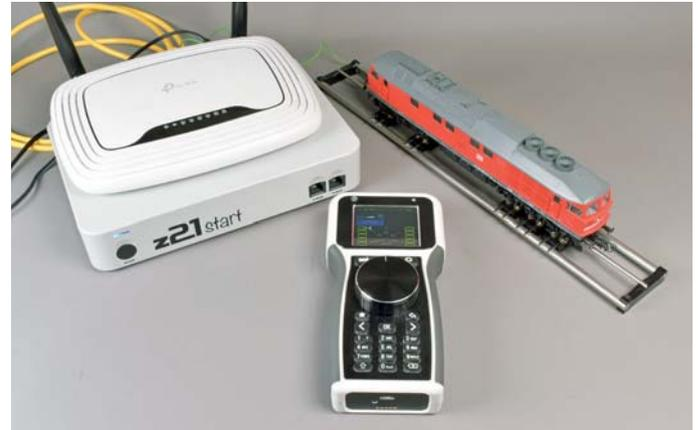
Der Handregler lässt sich auch an allen Digitalzentralen betreiben, die das Z21-Netzwerkprotokoll unterstützen. Dank des guten Bedienkonzepts ist der TCS-RC eine interessante Alternative.
