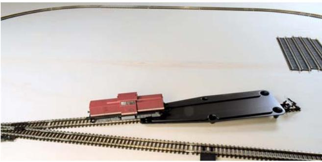
Die Aufgleishilfe macht das erste Aufgleisen der Fahrzeuge super einfach: Die Fahrzeuge werden einfach heruntergeschoben und stehen dann richtig auf dem Gleis.
