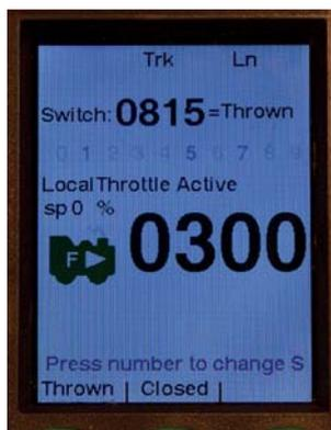
Die Anzeige ist sehr informativ: Die gewählte Lokadresse ist die 300, die Funktionen 1, 5, 7 sind eingeschaltet. Die aktuelle Schaltadresse ist die 0815 im Zustand „Thrown“ (als Gegenstück zu „Closed“) mit den Tasten A und B schaltet man den gewünschten Zustand. Ganz oben „Trk“ sagt, der Gleisanschluss ist aktiv.
