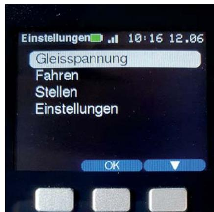
Das Menü kann durch langes Drücken des Drehreglers erreicht werden.
