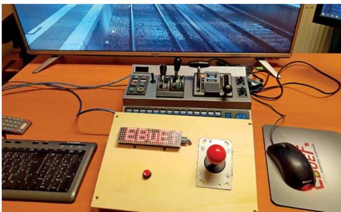
Für eine Untersuchung zur Haptik brachte das EBUf ein selbstgebautes Fahrpult und einen RailDriver mit.
