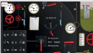
Die Central Station 3 bietet als Multiprotokoll-Steuergerät, mit ihrem hochauflösendem, modernen Farb-Touchscreen, den 2 Fahrreglern sowie dem integrierten zentralen Gleisbildstellpult, die Möglichkeit zum einfachen und komfortablen Steuern der Lokomotiven und der gesamten Anlage. Bei Lokomotiven lassen sich bis zu 32 Funktionen schalten, bei Zubehörartikeln sind bis zu 320 Motorola bzw. 2048 DCC-Magnetartikel möglich.
