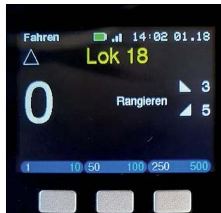
Im Modus „Adresse wählen“ wechseln die Softkeys die Funktion: Die Schrittweite, mit der das Drehen eine Adressänderung bewirkt, kann über die Tasten verändert werden - da keine 10 Tasten zur Zifferneingabe vorhanden sind, ist das die gewählte Methode, schneller zur gewünschten Adresse zu kommen. Mit Links- oder Rechtsdrehung des Drehreglers wird die Adresse um die gewählte Schrittweite erniedrigt oder erhöht.
