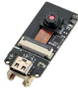
*M5Stack ESP32-CAM von M5Stack: WLAN und USB sind on board.*
