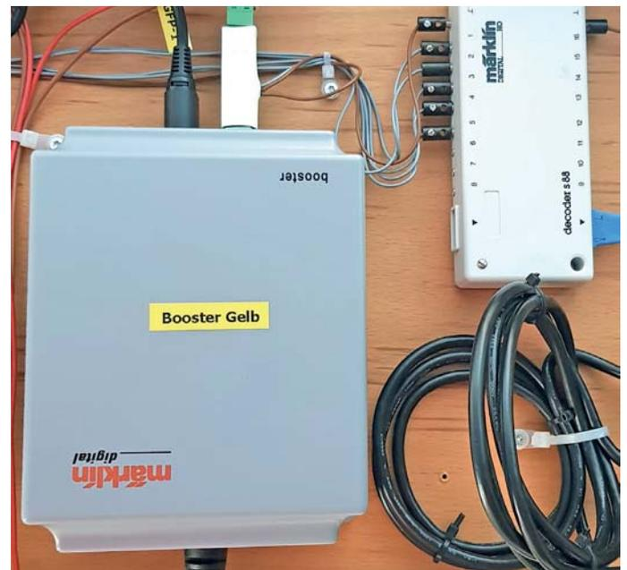
Booster mit Viewer und Rückmeldemodul. Masse (braun) wird vom Rückmeldemodul bezogen. Die grauen Kabel sind die Rückmeldungen der fünf Booster.
