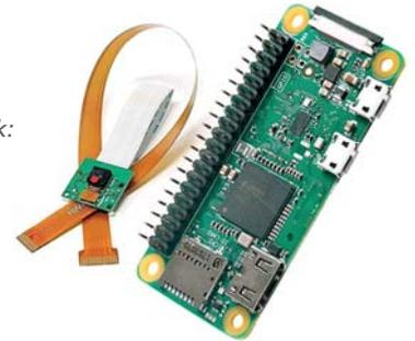
*Raspberry Pi ZERO wh mit Raspberry Pi V1.3 Kamera – WLAN und USB sind dabei.*
