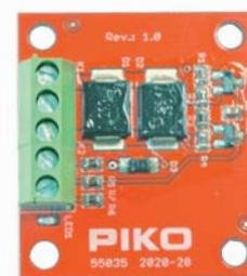
*Piko-Gleisbesetzmelder für die Benutzung mit dem SmartProgrammer. Den Belegzustand zeigt auch eine LED auf der Platine an.*
