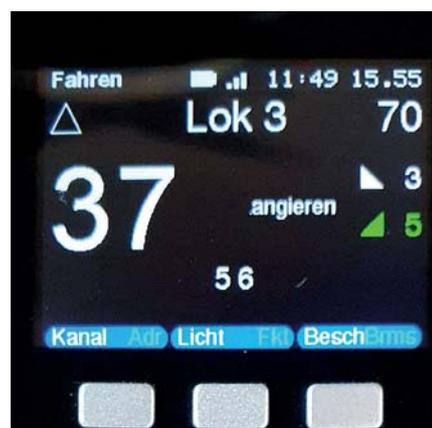
... und während des Beschleunigens (Zielfahrstufe 70 wird angezeigt und auch die Grünausleuchtung relevanter Daten wie Beschleunigungsrate 5).
