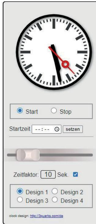
In die neuen Zentralen ist eine Modellzeit-Uhr integriert. Die Steuerung und Anzeige erfolgt über den Browser. Zusätzlich wird die Zeit auf dem DCC ausgegeben.
