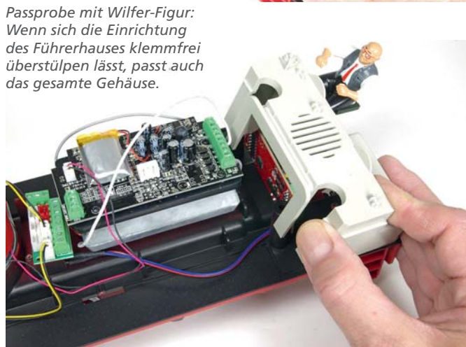
Damit der Geräuschbaustein weiterhin funktioniert, muss er natürlich mit den Schienen verbunden bleiben. Das weiße und das graue Kabel stellen die Verbindung zu den Schienen her.
