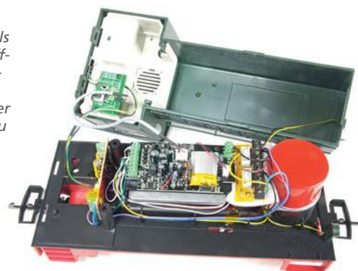
Im Inneren enden die Reed-Schalter-Anschlusskabel an einer dreipoligen Schraubklemme auf der Hauptplatine.
