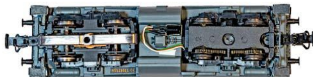
Hier ist der IR-Empfänger in der Mitte des Fahrzeugs zwischen den Drehgestellen aufgeklebt worden.
