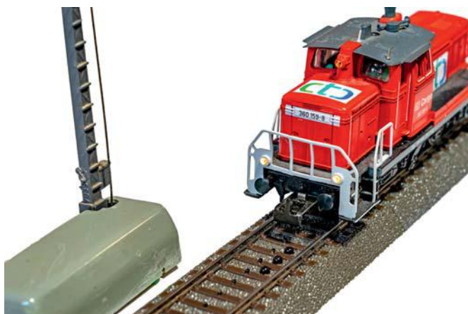
Gleich drei IR-Sender sind hier demonstrationshalber hintereinander im Gleis eingebaut. Im Normalfall reicht eine Sende-LED, nur bei schwierigen Empfangsverhältnissen kann es nötig sein, die Sendeleistung zu erhöhen.
