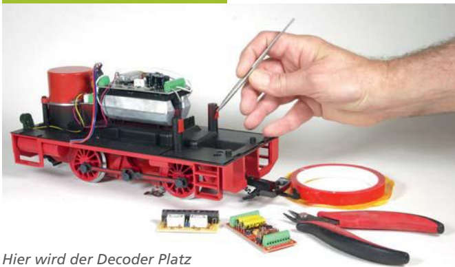
Hier wird der Decoder Platz finden. Fixiert wird er mit Abschnitten von einem dicken Montageklebeband.
