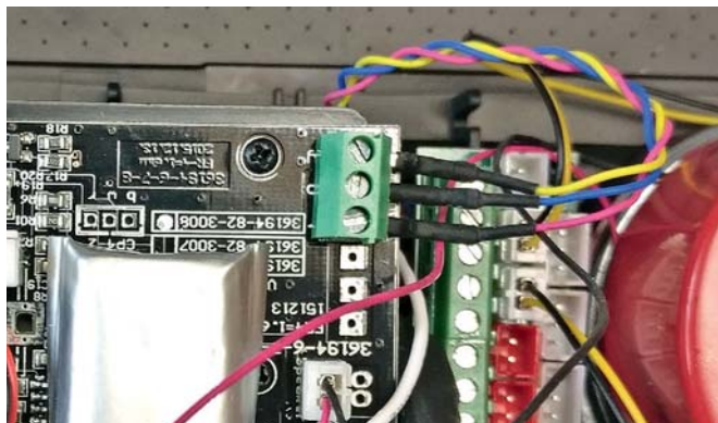
Im Inneren enden die Reed-Schalter-Anschlusskabel an einer dreipoligen Schraubklemme auf der Hauptplatine.
