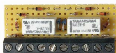
Unter- und Oberseite der bestückten Platine. Auch die geschlossenen Ruhekontakte bei den Relais sind erreichbar, vielleicht braucht man sie mal irgendwann (siehe auch Schaltplan).
