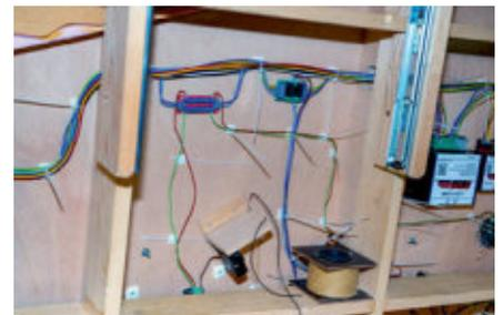
Unter der Anlage sind an vielen Stellen Lautsprecher eingebaut, die – gesteuert von iTrain – direkt vor Ort passende Hintergrundgeräusche abgeben.
