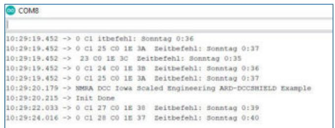
Die Suche nach der richtigen Nachricht im DCC-Datenstrom ist relativ einfach. So sieht die Modellzeit im Arduino-Monitor aus.
