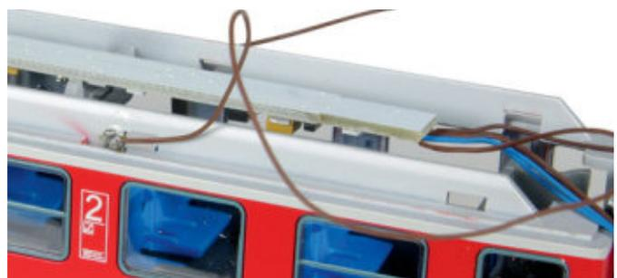
Êsu hat kleine Blechösen zur Stromübertragung vorbereitet. Hier soll die Beleuchtung angelötet werden. Selbst bei schnellem Lötens schmilzt der Kunststoff ein klein wenig!
