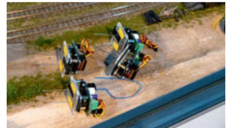
Die neuen Servo-Antriebe von Fritz Senn mit den angeschlossenen LoDi-Servo-Decodern vor dem Einbau unter der Anlage
