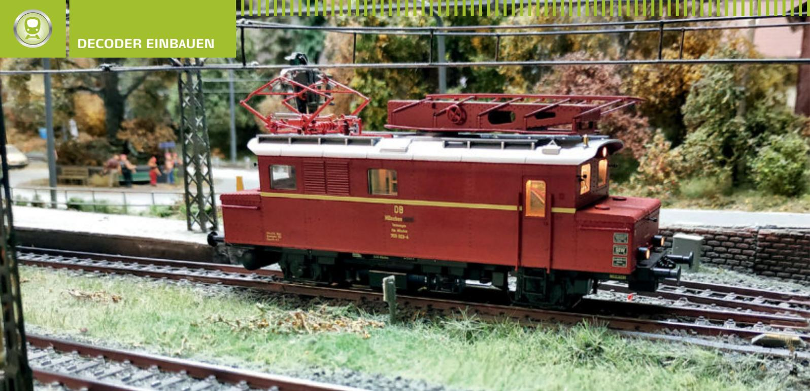
Liliputs Akkuturmtriebwagen mit Esu Loksound 5 und beweglichem Pantografen
