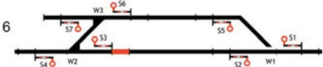
6 Die „frei“-Prüfung von Belegtmelder 2 hebt die Verriegelung von W1 auf und die gelbe Ausleuchtung wird zurückgenommen.
