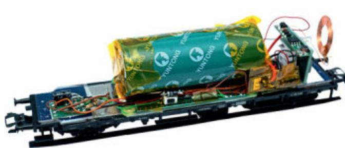
Kompletter Aufbau des Prototypen ohne Chassis mit Isolation der stromführenden Teile
