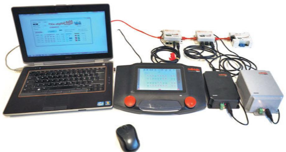
Verschiedene Booster an der Central Station werden über einen StromSnifferXL überwacht.
