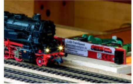
Das automatische Einmessen einer Lok mit dem LoDi-Train-Speed Modul im Schattenbahnhof
