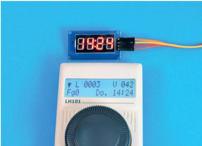
Mit der aktuellen Firmware zeigt der Lenz-Handregler LH101 den Wochentag und die Uhrzeit an, wenn er an einer Zentrale LZW200 betrieben wird. Mit dem Handregler werden auch die Einstellungen für die Uhrzeit vorgenommen. Das kleine TM1637-Display ist eine gut erkennbare Anzeige für die Uhrzeit.
