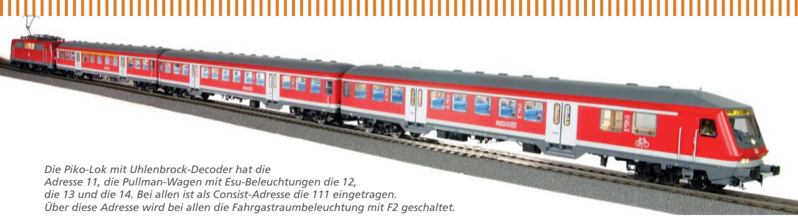
Die Piko-Lok mit Uhlenbrock-Decoder hat die Adresse 11, die Pullman-Wagen mit Esu-Beleuchtungen die 12, die 13 und die 14. Bei allen ist als Consist-Adresse die 111 eingetragen. Über diese Adresse wird bei allen die Fahrgastraumbeleuchtung mit F2 geschaltet.
