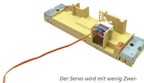
Der Servo wird mit wenig Zweikomponentenkleber befestigt.
