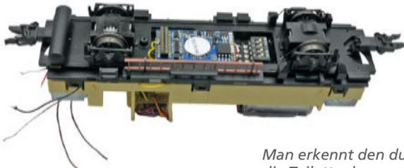
Man erkennt den durch die Toilettenkammer nach unten führenden Weg des gelben Servo-Steuerkabels. Der Anschluss erfolgt an einem Lötpad direkt an der Schnittstelle.
