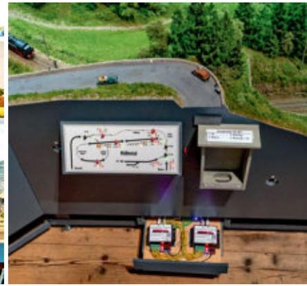
Blick ins Höllental mit dem zugehörigen Gleisbildstellpult: Zur Wartung herausgezogen ist eine Schublade mit zwei LoDi-Operator-Modulen zur Steuerung der Weichen und Signale vor Ort.
