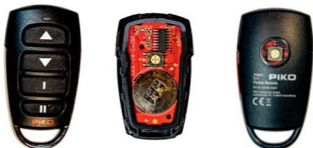
Unter einer kleinen Gummi-Abdeckung auf der Rückseite des Senders kann man einen der acht Kanäle einstellen (rechts). Nur zum Wechseln der Batterie muss man das ganze Gehäuse öffnen (Mitte).
