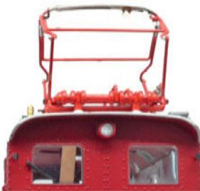
Eine Öse zur Befestigung der Zugsehnur wurde an das Schleifstück des Pantografen angeklebt.
