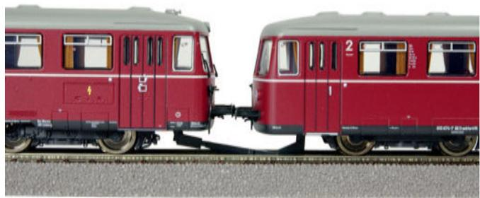
Die Aufhängungen der Kupplungsschächte sind so weich, dass sie sich beim Versuch, die Fahrzeuge auf dem Gleis zusammenzuschieben, verbiegen.
