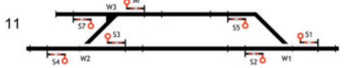
11 Signal S3 in Haltstellung, Verriegelung W2 aufheben, Ausleuchtung Gelb zurücknehmen
