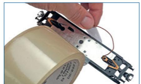
Stromleitende Teile wie das Gewicht zum Beschweren des Wagens werden isoliert. Zusätzlich verbessert dies die Stabilität.
