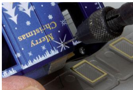
Der Bohrer misst 0,5 mm und wird langsam von Hand gedreht.
