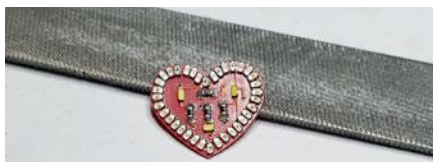
Die Kreise wurden zu Herzchen weiterentwickelt. Die drei zentralen weiß leuchtenden LEDs können jeweils getrennt angesteuert werden, um z.B. durch Blitzen Aufmerksamkeit zu erregen.
