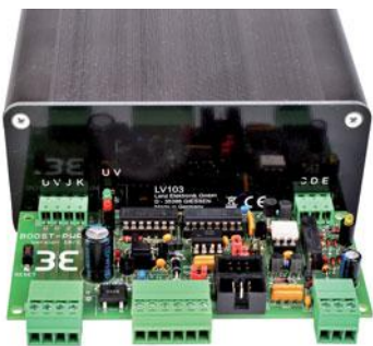
Lenz-Aufsatz: Das Booster-Powermanagement-Modul ist so konstruiert, dass es einfach hinten auf einen Lenz-Booster aufgesteckt werden kann. Das aktuelle Modell passt bei LV102 und LV103.
