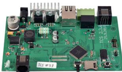
Aufgeschraubt und reingeschaut: Augenscheinlich habe ich die Zentrale mit der Nummer 33 erwischt. Der große NXP-Prozessor bietet Leistungsreserven.
