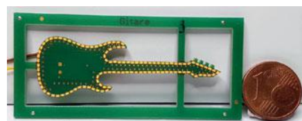
Der Platinenhersteller hat die Konturen perfekt ausgefräst und auch die Bestückung mit 0402-LEDs hat geklappt.
