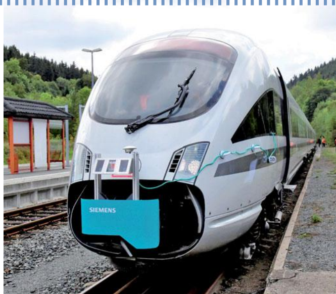
Der Diesel-ICE wird im Erzgebirge zum Advanced Train Lab. Hier wird gerade ein System zur Hinderniserkennung erprobt.
