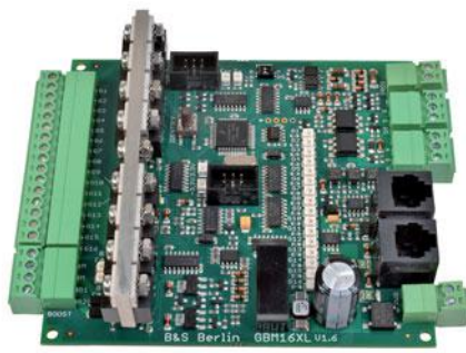
GBM16XL: Auf der linken Seite werden die Booster und die Gleisabschnitte angeschlossen. Auf der rechten Seite befinden sich die Anschlüsse Programmierung, RS-Bus, LocoNet, Betriebsspannungseinspeisung. Der Besetztzustand der Kanäle wird durch 16 LEDs in der Mitte angezeigt.
