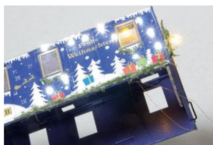
Probeleuchten der ersten LED-Gruppe: Man sieht den LED-Farbunterschied gut.
