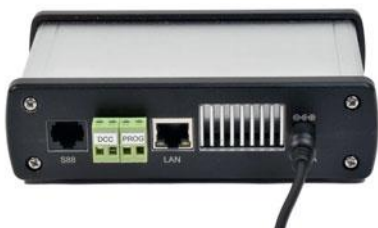
S88, Hauptgleis, Programmiergleis, Netzwerk und Stromversorgung sind die Anschlüsse auf der Rückseite der Digitalzentrale.
