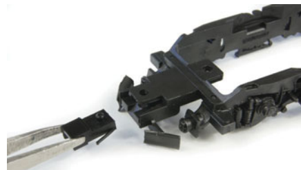
Das Modell lässt sich relativ einfach auf eine andere Kupplungsvariante umrüsten. Märklin hält entsprechende Bauelemente als Ersatzteile bereit.
