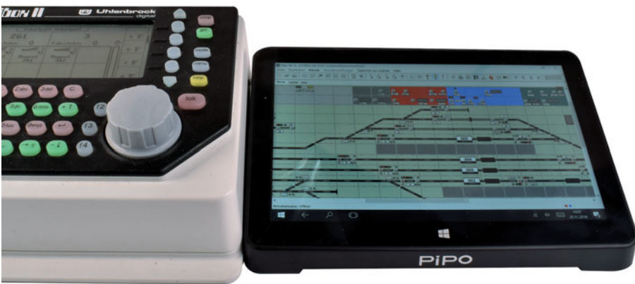
Das Pipó-Tablet neben einer Intellibox. Es sieht aus, als würde die beiden schon immer zusammengehören... Auf dem Tablet läuft ESTWJ. Die Intellibox ist über USB angeschlossen.
