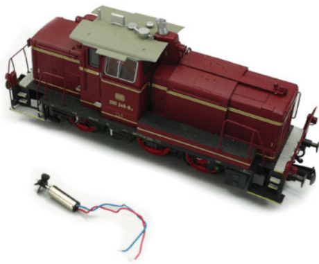
Der Ersatzmotor vor der zu reparierenden Lok mit schon aufgestecktem Lüfterrad und angelöteten Kabeln
