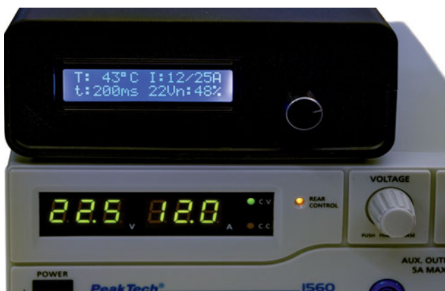
22,5 V und 12 A – die Anzeigen vom Labornetzgerät und vom Booster passen zusammen. Der Lüfter im Booster hat gut zu tun, um die Temperatur von 43° zu halten.
