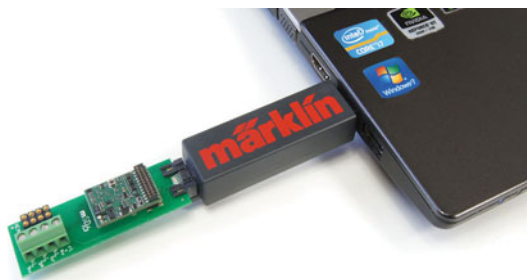
Der Märklin-Decoderprogrammer wird in einen USB-Anschluss eines PCs gesteckt. Am gegenüberliegenden Ende nimmt er den einzustellenden Decoder auf.
