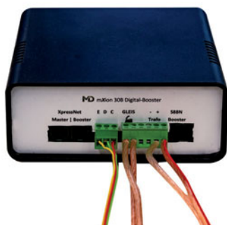
Die Anschlüsse sind steckbar ausgeführt. Das Steckersystem wurde passend zu den hohen Strömen ausgewählt.
