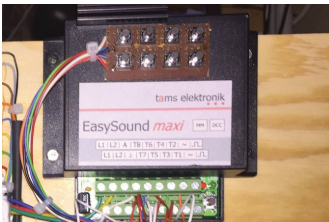
Auf dem EasySound-Modul ist eine Platine mit acht Tastern angebracht, um die fest verdrahteten acht Geräusche abrufen zu können
