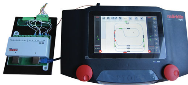
Märklin-CS3 plus mit s88DC, an dem die sieben Testanlagen-Abschnitte angeschlossen sind
