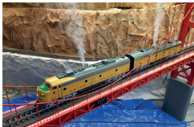
Eine Doppelunit wie hier die EMD E8(A) genehmigt sich mit eingeschalteten Raucherzeugern bis zu 9 A! Hat man nun noch eine zusätzliche Verstärkungsunit im Zug, überschreitet der Strombedarf schnell die Lieferfähigkeit bisheriger Booster.
