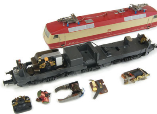
Das Modell hat einen neuen Antrieb bekommen. Vorne die ausgebauten alten Teile. Rechts das Stromstoßumschaltrelais.
