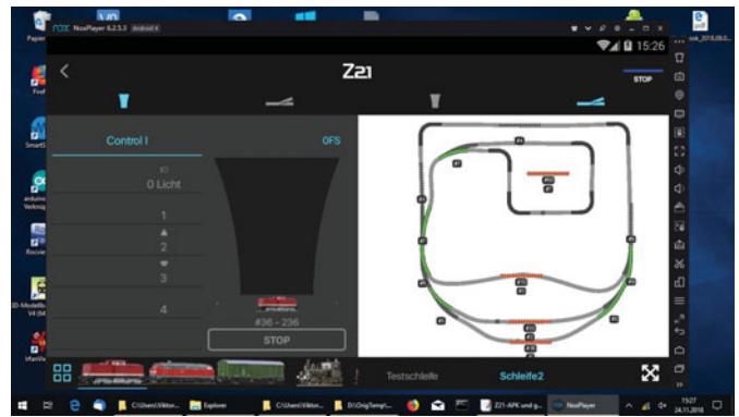
Im Gleisplan der Z21-APP können – passende Melder vorausgesetzt – die DCC-Adressen der belegenden Loks angezeigt werden.
