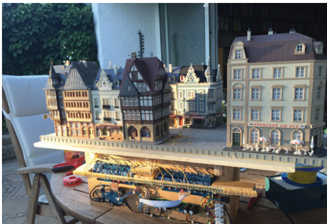
Der gesamte Altstadtbereich inklusive der darunter angeordneten Steuerelektronik kann herausgenommen und separat bearbeitet werden.
