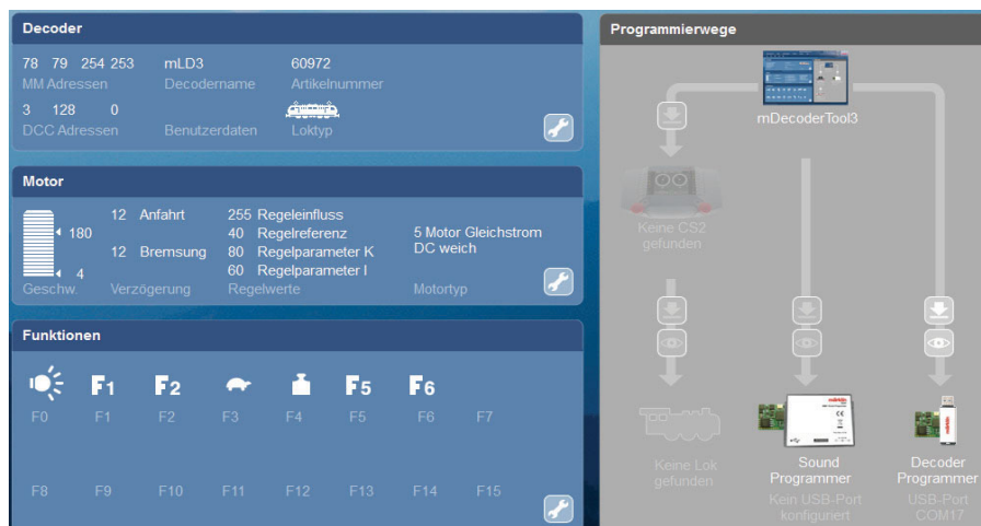
Die passende Software zum Märklin Decoder-Tool nennt sich „mDT3“ und kann kostenlos von der Märklin-Homepage heruntergeladen werden. Dank übersichtlicher Bildschirmenüs gelingt die Konfiguration eigener Projekte auch dem Neueinsteiger.
