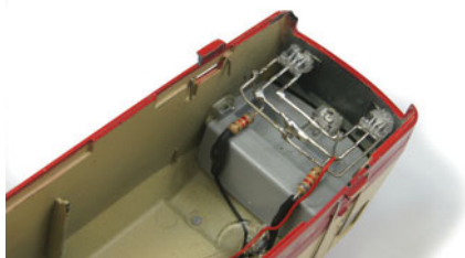
Man soll es ja eigentlich nicht tun: LEDs direkt parallelschalten. Bei den hier eingestellten geringen Strömen (ca. 0,3 mA!) überleben aber alle LEDs den Betrieb ohne Probleme.
