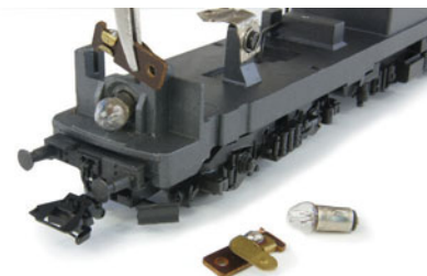
Auch die Lampen werden demontiert
