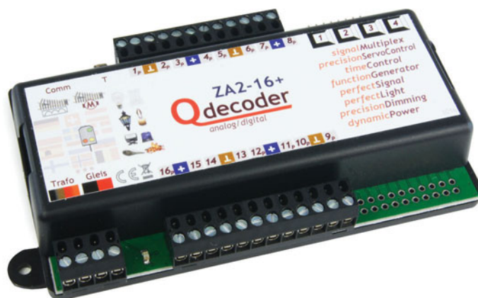
Der Qdecoder ZA2-16+ kann viele denkbaren Aufgaben auf der Modellbahn erfüllen. Ganz nebenbei steuert er auch vier Viessmann Multiplexsignale an.
