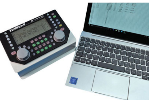
Bei einigen Tablets sind die Unterschiede zum Laptop kaum feststellbar. Bei diesem Lenovo Miix handelt es sich eigentlich um ein Windows-10-Tablet mit einer angesteckten Tastatur. Hier läuft gerade das IB2-Tool zur Fahrstraßen-Programmierung auf der Intellibox.
