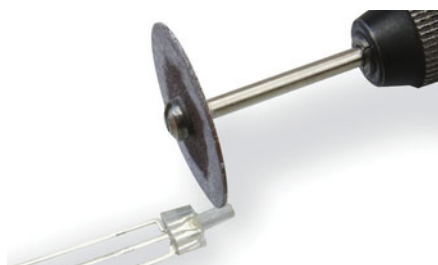
Die LEDs werden mit der Minitrengscheibe passend gekürzt.
