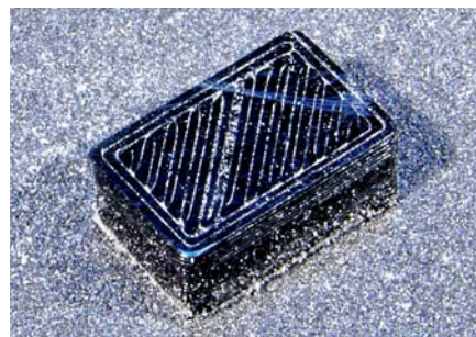
Schneller und präziser ist man, wenn man die Schallbox auf einem feinen Schleifpapier hin- und herschiebt..
