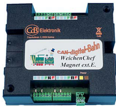
Die „WeichenChefs“ des CAN-digital-Bahn-Projektes für den ZCAN haben externe Eingänge, an die Endschalter angeschlossen werden können, die dann als Sensoren dienen und die echte Schaltstellung erfassen und in den Bus melden.
