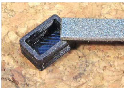
Der Kunststoff ist weich-zäh und lässt sich mit normalen Feilen nur mühsam bearbeiten. Mit einer Saphierfeile geht es hingegen recht gut.
