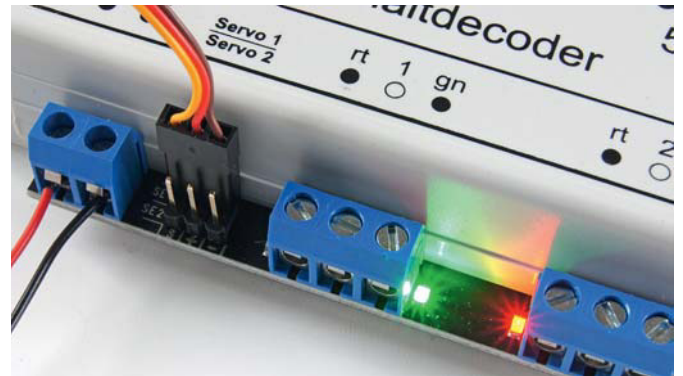
Für jeden Ausgang sind beim Viessmann Decoder einzelne Kontroll-Leds vorhanden. Sie zeigen den letzten erhaltenen Schaltbefehl an. Die beiden Servos werden jeweils über einen dreipoligen Stecker angeschlossen.
