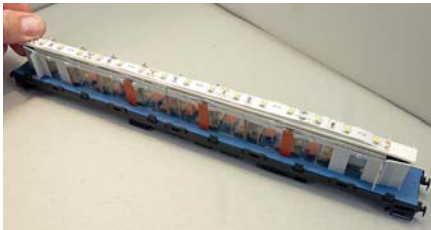
Die Länge des Polystyrolträgers und des LED-Bands wird den Wageninnenabmessungen angepasst.
