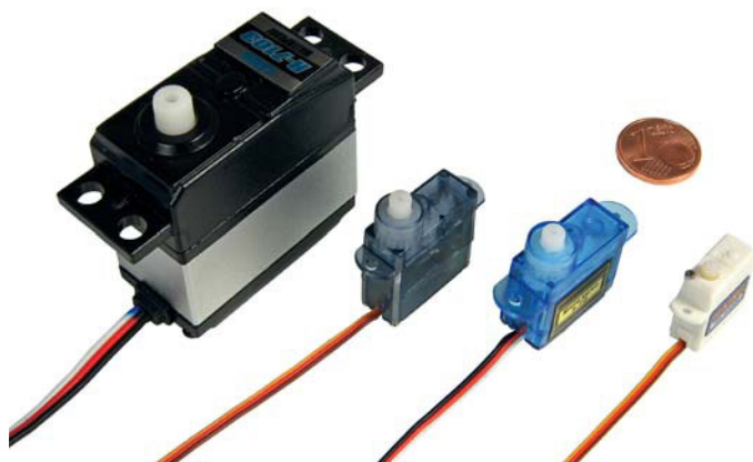
Servos werden heute von vielen Herstellern in unterschiedlichen Größen und mit unterschiedlichen Stellkräften angeboten.
