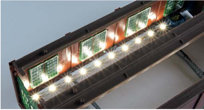
Zur Beleuchtung des Lokschuppens eignen sich gut Waggon-Innenbeleuchtungen auf LED Basis. Da das Dach später abnehmbar bleiben soll, werden sie am besten an den Querträgern zwischen den Wänden verklebt.
