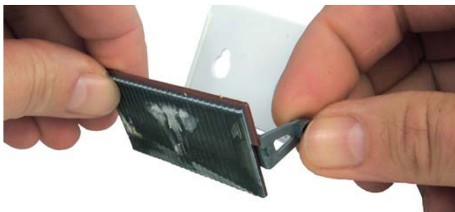
Der Servoarm wird am Tor eingeklippt und trägt dieses später.
