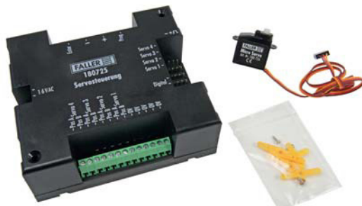
Sowohl das Microservo 180726 als auch die Servosteuerung 180725 kommen von Faller. Die Steuerung erlaubt auch den Anschluss von gängigen Servos anderer Hersteller.
