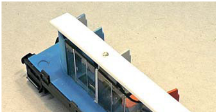
Die Nase auf der Innenwand greift in das soeben hergestellte Loch in LED-Band und Trägerplatte: Es passt alles wie gewünscht.
