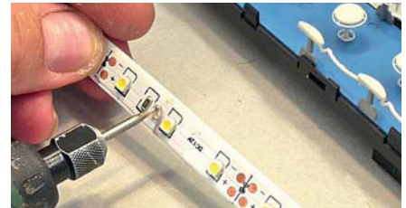
Je Wagenende weist eine der Innenwände oben eine Nase auf. Für diese entsteht ein Loch in LED-Band und Trägerplatte.
