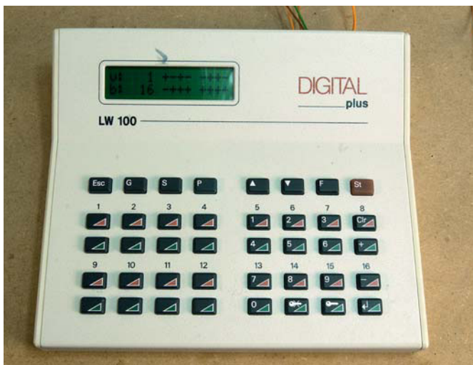
Ein historisch anmutendes LW100-Gerät von Lenz. Digitalzentralen-Sammler zahlen für dieses Gerät Liebhaberpreise. Neben der direkten Bedienung durch die eingebauten Tasten lassen sich auch noch LW120 Tastenmodule und LW130 Anzeigemodule anschließen.
