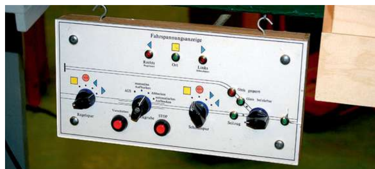
H0e-Analogstellpult der Rollbockgrube von Uwe Stehr: Über die Drehschalter kann man zwischen dem im örtlichen Bahnhof eingesteckten Regler (gelbes Quadrat) oder dem im linken, bzw. rechten benachbarten Bahnhof eingesteckten Regler auswählen. Der rote Punkt bedeutet ausgeschaltet.
