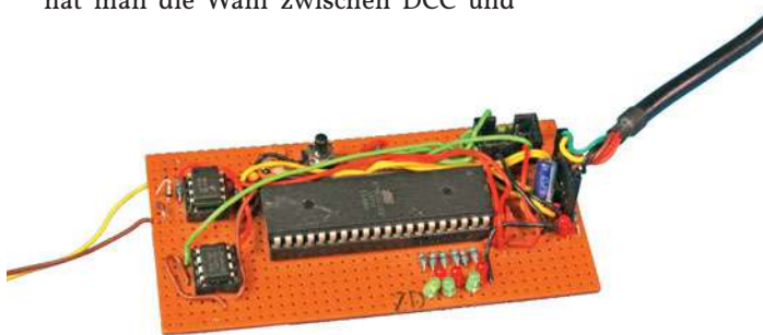
Lochraster-Aufbau eines DCC-Sniffers nach dem Schaltplan von Wolfgang Kufer. Die USB-Anbindung auf der rechten Seite übernimmt ein sogenanntes FTDI-Kabel.
