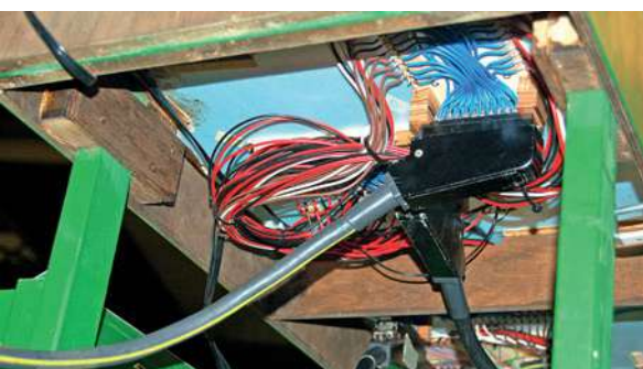
Bei der früheren Analogtechnik entstand regelmäßig ein solcher geordneter „Kabelverhau“. Jeder Fahrabschnitt brauchte seinen eigenen Kabelsatz, um ihn unabhängig einem Regler zuordnen zu können.
