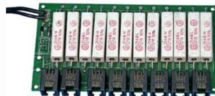
Ein RSCLD: Links an den Kabeln wird ein Booster oder der Gleis Ausgang einer geeigneten Zentrale angeschlossen. An den beiden linken LocoNet-Buchsen wird das LocoNet aus der Zentrale angeschlossen, an den 6 rechten Buchsen wird das LocoNet sternförmig in das FREMO-Arrangement verteilt. Die dicken Widerstände dienen zur Strombegrenzung.
