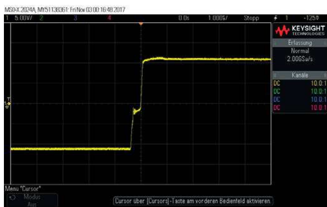
Wenn man tief in das von der Zentrale erzeugte Signal hineinzoomt, dann kann man die für einen Motortreiber typische Stufe im DCC-Signal sehen. In der Praxis sollte das aber keine negativen Auswirkungen auf den Betrieb haben.
