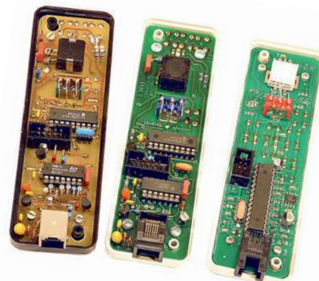
FREDS von innen: Links V0.2 aus der Nullserie mit handgeätzter Platine und ausschließlich bedrahteten Bauteilen von 1997. In der Mitte die Serienversion von 2004, bei der ein paar Widerstände in SMD-Bauform auftauchen. Rechts ein aktueller FREDi von 2016, dessen Bestückung fast nur noch mit SMD-Bausteinen erfolgt.
