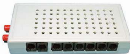
Dieser RSCLD hat ein Gehäuse bekommen. Der Boosteranschluss links ist in Form von zwei 4-mm-Bananenbuchsen ausgeführt. Hier erkennt man die Trennung von LocoNet-in (links 2x) und LocoNet-out (rechts 6x) sehr schön. Die Löcher im Gehäuse dienen der Wärmeabfuhr der Widerstände.
