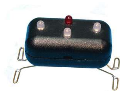
Ein schwarzes Polei mit kunstvoll gebogenen und verlöteten Drahtkontakten
