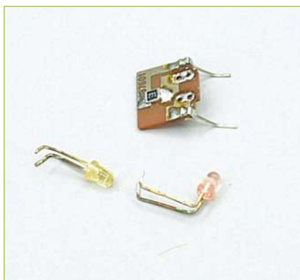
Die alten LEDs sind ausgebaut. Nun gilt es, die Platine für die digitale Verwendung vorzubereiten. Dazu muss auch noch der Widerstand verschwinden.
