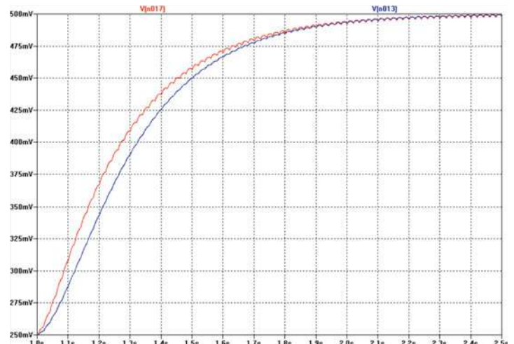
Bild 4: Spannungsverlauf an C2 bei einem Sprung der Impulsdauer von 1 ms auf 2 ms.
