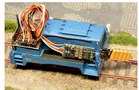
Testfahrt mit provisorisch eingebauten Decoder
