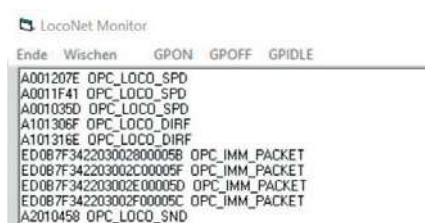
Im LocoNet-Monitor lässt sich die Kommunikation auf dem Bus mitverfolgen.
