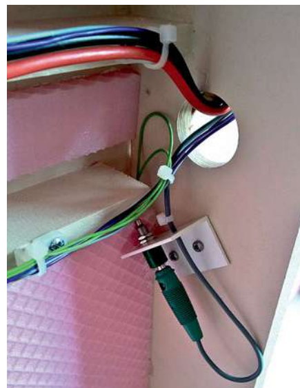
Am Verstärkungsbrett in der Mitte ist ein Winkel montiert, der eine grüne Buchse-Kabel-Stecker-Kombination für wahlfrei einzuschleifende Meldeabschnitte enthält.
