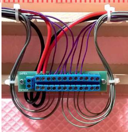
Ein zentraler Klemmenblock nimmt die Kabel auf. Links erkennt man die DCC-Speiseleitung in Form des dicken roten und schwarzen 2,5-mm 2 -Kabels.
