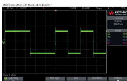
Die Booster-Trennstelle mit dem Oszilloskop betrachtet. Hier liegen die gelbe und die grüne Linie nahezu direkt übereinander. Die beiden Booster haben die gleiche Phasenlage. So soll es sein.
