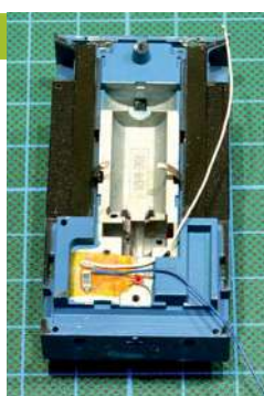
Der Vorwiderstand der LED für die Fahrwerksbeleuchtung wird auf einem Stück Kapton-Klebeband freiverdrahtet
