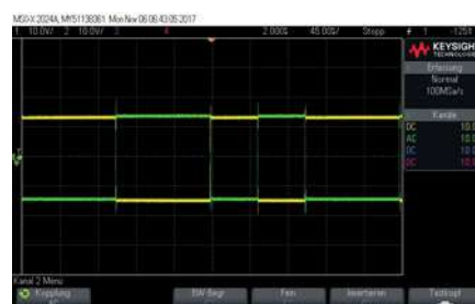
Hier sieht man die grüne und die gelbe Linie deutlich in verschiedenen zeitlichen Bereichen. Die Phasenlage ist verdreht, einer der Booster muss umgepolt werden.
