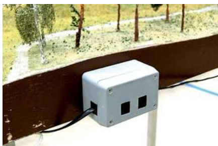
Eine LocoNet-Box dient zum Anschluss von Handregler und als Verbindung zweier LocoNet-Kabel. LocoNet-Boxen werden meistens im Abstand von 3 bis 5 m an den Modulaußenwänden mit einer Schraubzwinge befestigt. Die Seitenwand des Moduls hier könnte mal einen neuen Anstrich vertragen...
