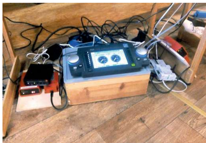
Eine ECoS als DCC-Zentrale im FREMO. Das LocoNet wird vom L.Net-Adapter aufgespannt. Zusätzlich sind hier noch DAISY-II-Funkadapter von Uhlenbrock und eine multiZentralePro von ROCO angeschlossen.
