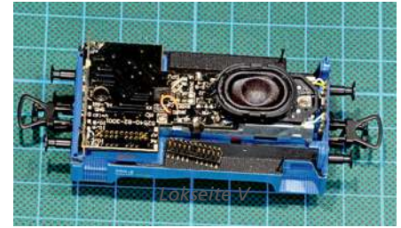
Lok offen mit PluX22-Stiftleiste
