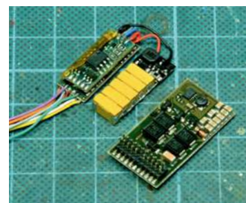
Decoderpack im Vergleich zum PluX22-Decoder von D&H. Der PluX22-Decoder hat ungefähr die gleiche Grundfläche.
