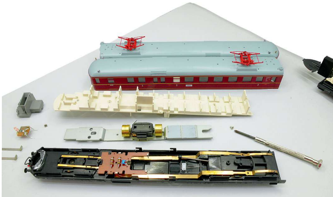
Der Triebwagen ist vollständig zerlegt. Vorne das Chassis vom Motorwagen mit Messing-Kontaktschienen und Fahrzeugplatine. In der nächsten Reihe der Motor, gefolgt von der Inneneinrichtung und beiden Gehäusen. Hier sind die Dächer noch auf den Fahrzeugwänden aufgesetzt. Links eine Frontlichtplatine und ein Führerstand.
