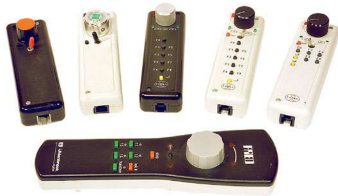
Alle bisher gefertigten FRED-Bauarten auf einem Bild: In der oberen Reihe sieht man von links nach rechts einen FRED V0.2; einen FRED mit Poti mit F0, F1, F2; einen FREDi mit Inkrementalgeber und einen FREDi mit Poti, beide bis F8 sowie einen FREDi mit zwei Shift-Tasten bis F12. Vorne liegt der kommerziell gefertigte Uhlenbrock-FRED.
