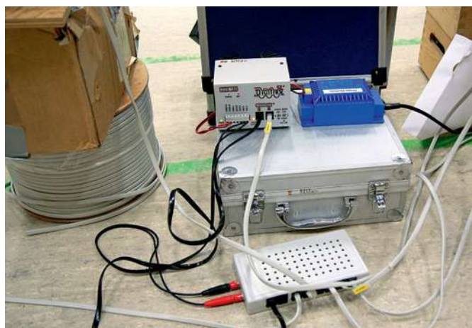
Ein typischer Digitalaufbau: In dem weißen Kästchen mit den vielen Löchern befindet sich ein RSCLD. Die Löcher dienen der Wärmeabfuhr. Transportiert werden Chief, Trafo und RSCLD in dem kleinen Schminkköfferchen. Links im Bild ist noch eine 200m Rolle mit LocoNet-Kabeln in AWG-26-Qualität.
