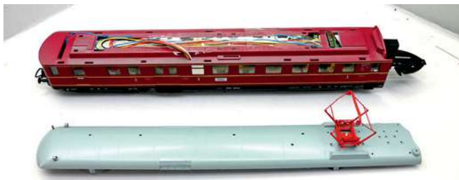
Trennt man das graue Dach von den Seitenwänden, kann man die Kabel sauber verlegen.
