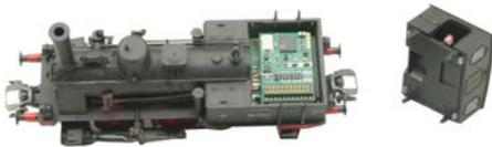
Das Führerhaus wird ausgeklipst, dann dessen Boden entfernt.
