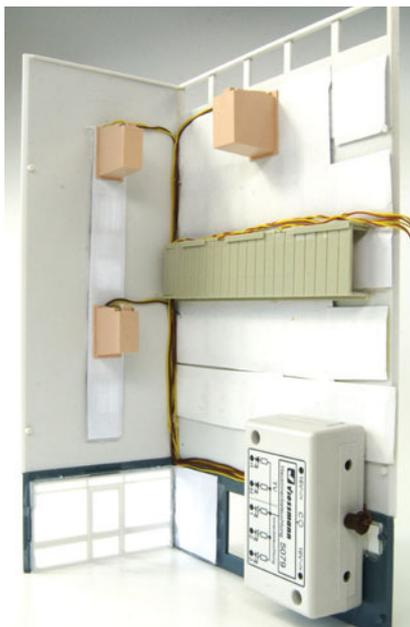
Neben der Etageninnenbeleuchtung kommt von Viessmann auch eine LED-Hausinnenbeleuchtung mit Steuerelektronik (5079) zum Einsatz. Die Elektronikbaugruppe wird in die Verteilerleiste der 16-V-Wechselspannung eingesteckt – über fünf separate Ausgänge am Steuermodul werden einzelne Fenster getrennt beleuchtet und sorgen durch automatisches Ein- und Ausschalten für „Leben“ in den Räumen.
