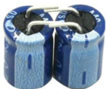
Die zwei 220-µF-Kondensatoren werden direkt parallel geschaltet und bieten so eine Kapazität von 440 µF.
