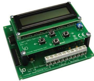
Das Basismodul ist der „Kopf“ der Lichtsteuerung. Es muss im funktionsfähigen System immer mit wenigstens einem Light-Modul (Light-Display oder Light-Power) ergänzt werden. Zusätzliche Anschlussklemmen erlauben den Anschluss von Tastern oder Schaltern und die Einspeisung eines DCC-Digitalsignals.
