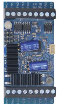
Bei Großbahnen der Spuren 1 und II m nutzen viele Modellbahner die Faustformel, dass für jeden Motor 1,5 Ampere Leistung benötigt werden. In vielen Fällen reicht diese Faustformel aus. Für alle anderen hat Massoth mit dem eMOTION XXL II einen neuen Hochleistungs-Lokdecoder auf den Markt gebracht, der allein dem Motor 6 A zur Verfügung stellen kann.
