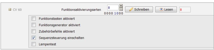
Für die Aktivierung der Sequenzsteuerung unserer Verkehrsampel muss CV 60 auf den Wert 8 gestellt werden. Die Einstellung kann natürlich auch manuell über eine Digitalzentrale gesetzt werden.
