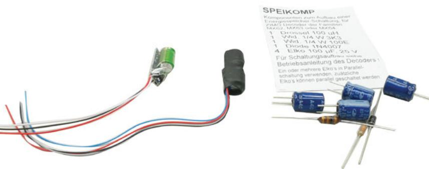
Fertige Speicherbausteine sind die einfachste Möglichkeit, einen Puffer aufzubauen. Hier sind links ein ESU-Power-Pack für LoPi und LoSo, in der Mitte der von D & H seit kurzem erhältliche Energiespeicher SP05 A für SUSI-Schnittstellen und rechts das Speikomp-Set von ZIMO abgebildet.
