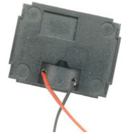
Das rote und das schwarze Anschlusskabel werden durch kleine Löcher durch den Boden nach unten geführt.
