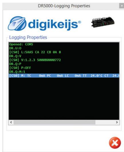
Startet man die Software, so geht neben dem ungewöhnlichen Konfigurationsfenster eine Anzeige mit Statusmeldungen auf. Hier werden die Befehle, die die Zentrale erhält, genauso protokolliert wie der Status des eingebauten Boosters.
