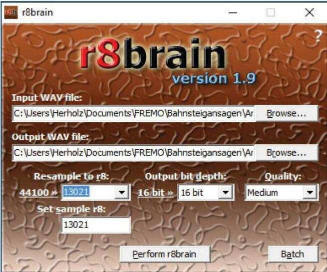
Das Programm r8brain liegt dem SUSI-Sound-Lade-Adapter bei. Hier werden die Audio-Dateien in das richtige Format für den IntelliSound3 gesampelt.
