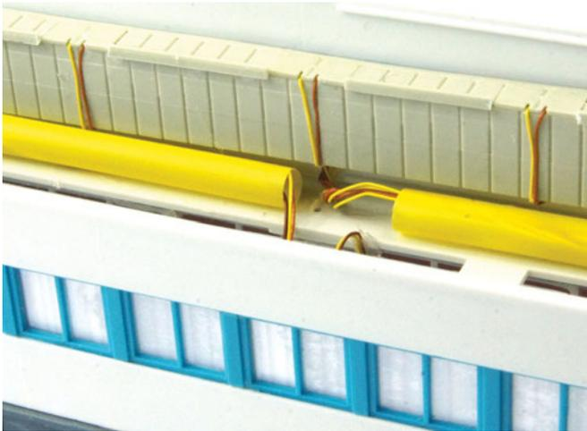
Viele nebeneinanderliegende Fenster einer Etage werden besonders einfach mit der Viessmann-Etageninnenbeleuchtung 6045 versorgt. Diese liegt dem Bausatz bereits 1x bei und kann zusätzlich mit weiteren identischen Artikeln und den passenden LEDs 6046/6047/6048 sinnvoll erweitert werden.
