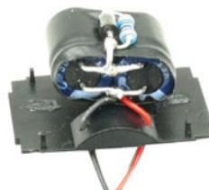
Die Kondensatoren sind mittlerweile mit Isolierband umwickelt und auf die Bodenplatte geklebt. Diode und Widerstand werden angelötet, ebenso die Anschlusskabel.
