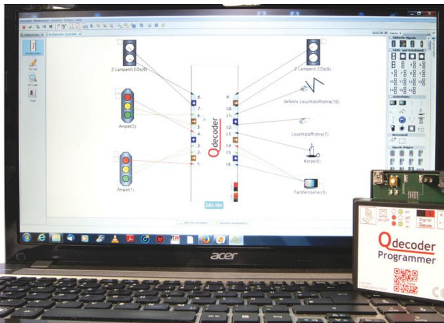
Wegen des großen Funktionsumfangs der Qdecoder empfiehlt sich der Einsatz der Konfigurationssoftware „Qrail“. Hier sind alle Funktionen übersichtlich dargestellt. In Verbindung mit dem Qdecoder Programmer ist die komplette Programmierung mit wenigen Klicks erledigt.
