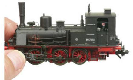
Ist der Decoder eingesteckt, wird das Führerhaus aufgeklipst. Die Pufferung mit zwei Kondensatoren reicht zumindest aus, um die Lok trotz kurzer Unterbrechungen ruhig weiterlaufen zu lassen.
