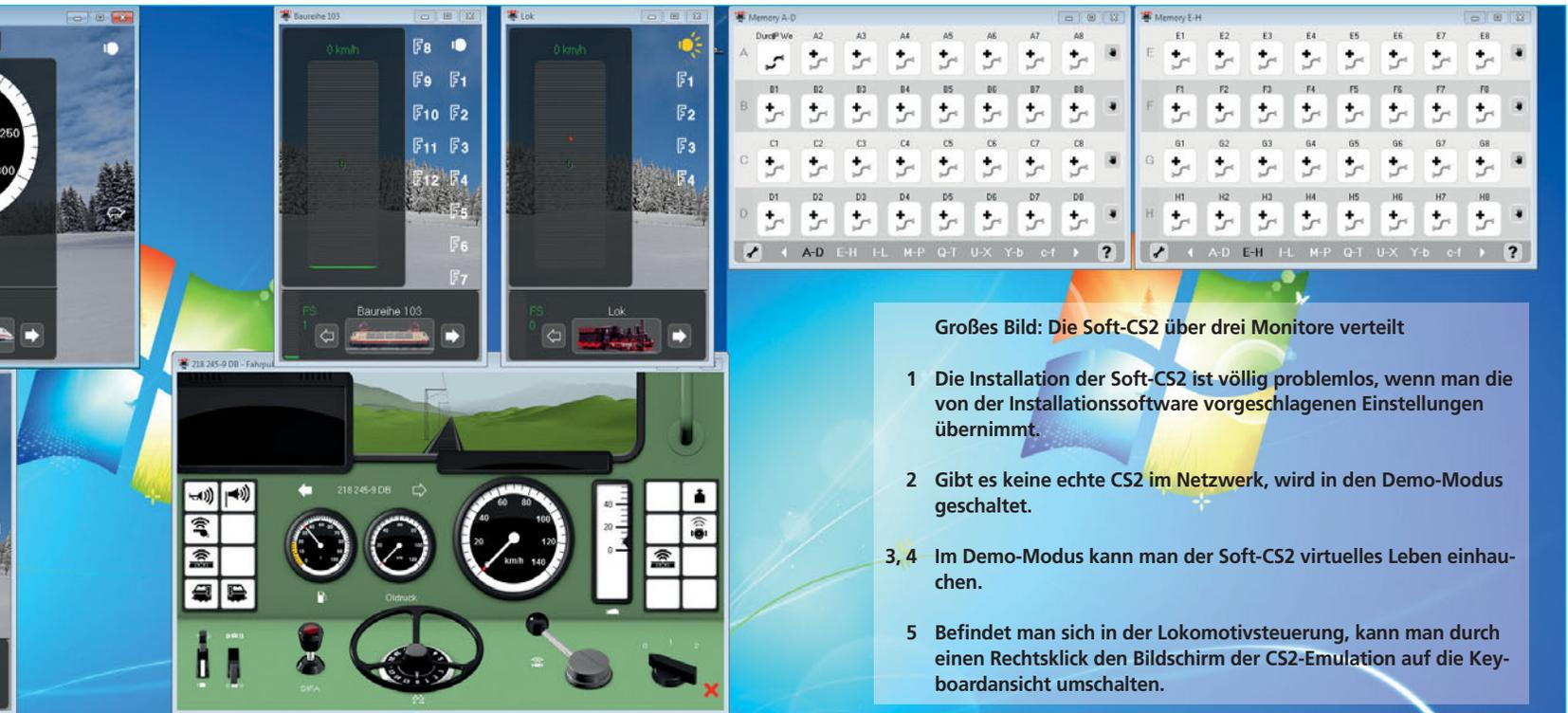
Die Installation der Soft-CS2 ist völlig problemlos, wenn man die von der Installationssoftware vorgeschlagenen Einstellungen übernimmt. [1] So ist auch sichergestellt, dass das Programm später Schreibrechte in dem Verzeichnis besitzt, in dem die Einstellungen abgelegt werden. Wenn man sich nicht auskennt, könnte es bei veränderten Einstellungen ab Windows 7 zu Problemen kommen.
