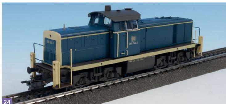
Das Modell verfügt neben der fernbedienbaren Kupplung auch über einen mfx-Sounddecoder, sodass man insgesamt acht Funktionen zu Verfügung hat. Man kann die Kupplung auch mit dem einfachen IR-Handregler auslösen, da sie der Funktion F1 zugeordnet ist. [27]
