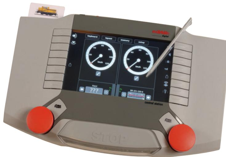
der Geschwindigkeit. Entsprechend weist die CS2 zwei große Regler auf, die in Märklin-typischer Manier auch als Druckschalter für den Fahrtrichtungswechsel eingerichtet sind. Mit den kleinen Schaltflächen neben den Drehknöpfen kann man sich schnell eine Lokliste aufs Display holen, um die Steuerung einer anderen Lok zu übernehmen. [6]
