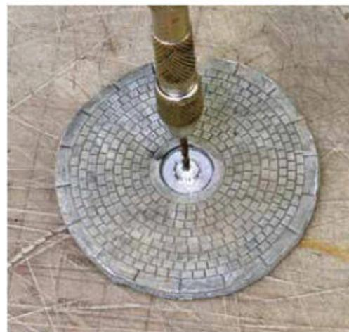
**9** Il faut ensuite percer l'emplacement du pivot de la grue. Je commence par marquer le centre du pivot à l'aide d'un petit foret. Même sèche, la pâte est tendre. Une drille à main suffit.
