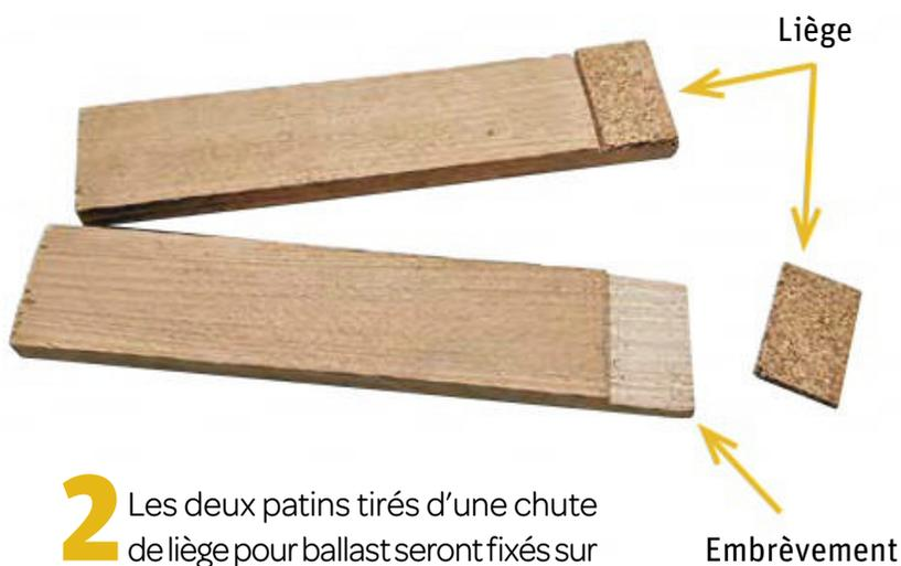
**2** Les deux patins tirés d'une chute de liège pour ballast seront fixés sur les tasseaux à l'aide de colle vinylique.
