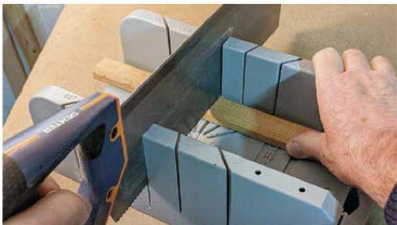
**1** L'utilisation d'une scie à onglet assure une découpe bien nette et perpendiculaire, jamais bien évidente à obtenir avec un sciage à « main levée »
