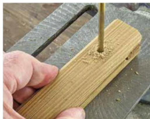
**4** Le perçage devra être bien perpendiculaire. L'idéal pour cela est d'utiliser une perceuse à colonne.
