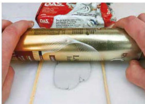
**2** J'aplatis la pâte Das à l'aide d'un rouleau (ici une bombe de laque). Je travaille sur du papier sulfurisé pour éviter qu'elle ne colle à l'établi. Deux gabarits (ici deux piques à brochettes) placés de part et d'autre et sur lesquels j'appuie le rouleau, permettent d'obtenir l'épaisseur souhaitée et une surface parfaitement plane.
