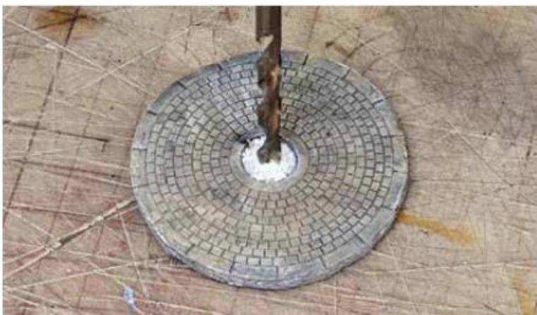
**10** Puis, à l'aide d'un foret de 5 mm, j'élargis ce trou au diamètre du pivot.
