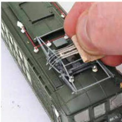
**11** Pour finir, remontez le pantographe et frottez la partie horizontale de la palette à l'aide de papier abrasif grain 800.
