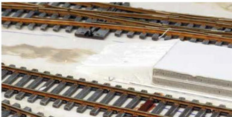
**8** Côté ponts, les quais s'achèveront par une descente. Je la découpe dans une chute de polystyrène extrudé en m'aidant d'une bordure de quai comme gabarit.
