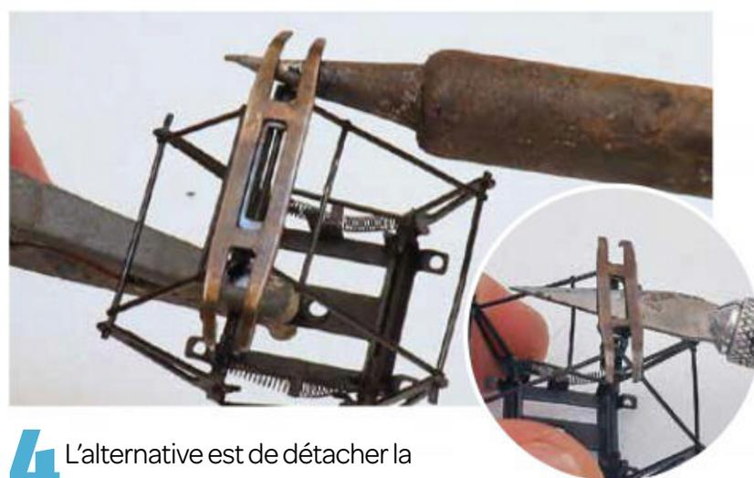
**4** L'alternative est de détacher la palette du support et de la soulever en la chauffant avec la panne d'un fer à souder. Il peut être nécessaire de glisser une lame de couteau X-Acto entre la palette et le support pour faire levier.
