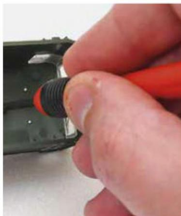
**1** Commencez par démonter les pantographes. Retirez la caisse du châssis en écartant simplement les flancs de cette dernière, puis dévissez la vis de fixation du pantographe.
