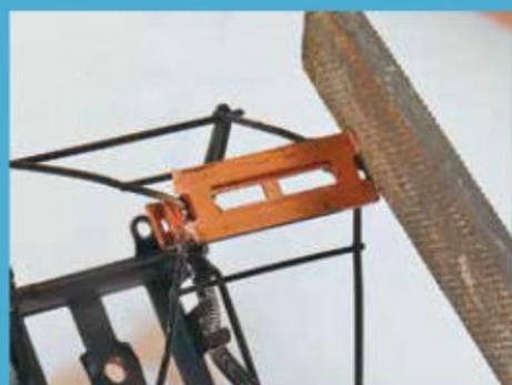
*Si chauffer la palette n'est pas suffisant pour la détacher, vous pouvez choisir simplement de couper les cornes des palettes en procédant pas à pas jusqu'au ras des supports à l'aide d'une pince coupante. Finir le travail à la lime aiguille.*
