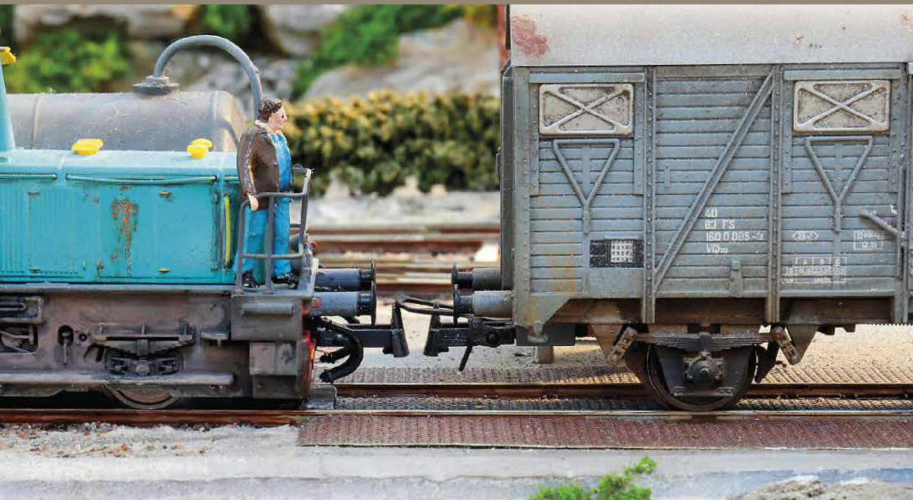
Avec un attelage amputé de sa boucle, le raccordement entre ce yoyo et un wagon couvert est facilité.
