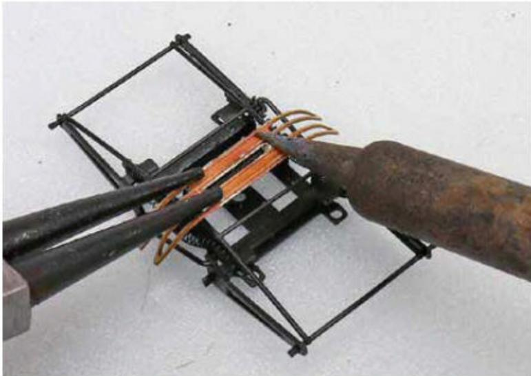
**9** Disposez la palette sur le support du pantographe replié. Appliquez la panne du fer chaude et soudez. Le temps de l'opération, maintenez en place la palette grâce à une pince à bec par exemple.
