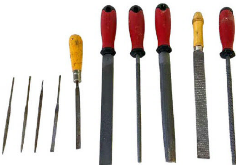
Photo 1. Dans ce petit assortiment de limes diverses nous pouvons voir, de gauche à droite, quelques limes dites aussi limes aiguilles pour travaux fins, trois limes, plate, ronde (dites « queue-de-rat ») et demi-ronde à métaux, et enfin deux râpes à bois, plate et ronde.
