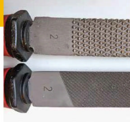
Photo 2. Limes à métaux et râpes à bois (en haut sur la photo) ne sont qu'un seul et même outil. C'est la forme et la densité de leur denture au cm 2 qui déterminent les matériaux et le travail auxquels elles sont destinées.
