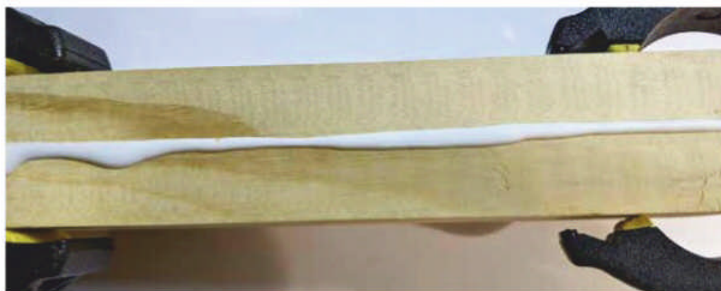
Photo 2. La colle vinylique appliquée sur le support à assembler, devra être répartie sur toute la surface pour garantir un collage parfait. Un chiffon humide permettra d'éliminer les bavures.
