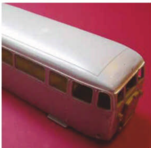
Photo 4. Chaque joint du modèle doit faire l'objet d'un masticage soigneux pour éliminer toutes les ouvertures ou fentes qui pourraient subsister malgré un assemblage précis.
