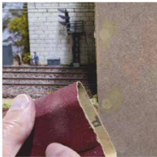
Photo 3. Le ponçage se fait à l'aide de papier abrasif (ex. 240) fixé sur une cale, provenant du commerce ou d'une chute de bois avec une surface plane.
