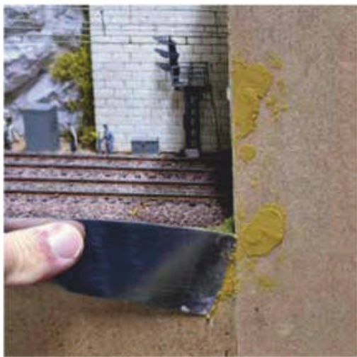
Photo 2. La pâte à bois est déposée et lissée grossièrement à l'aide d'un couteau à masticage.
