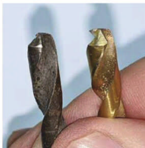
Photo 5. La partie coupante du foret de gauche, en comparaison avec celui de droite, est trop émoussée pour garantir un bon travail. Il doit être affûté ou remplacé.
