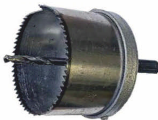
Photo 3. Scie cloche et son foret de centrage. Il est préférable de faire un avant-trou d'un diamètre inférieur à celui du foret de centrage pour un meilleur guidage pendant la coupe.
