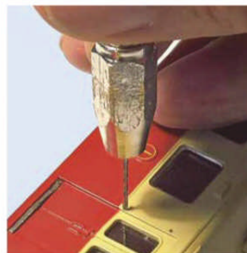
Photo 6. Pour des perçages de très petits diamètres, notamment dans les matières tendres comme le plastique, la drille à main est idéale.
