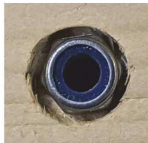
Photo 4. Une scie cloche permet de percer des ouvertures circulaires de grand diamètre.
