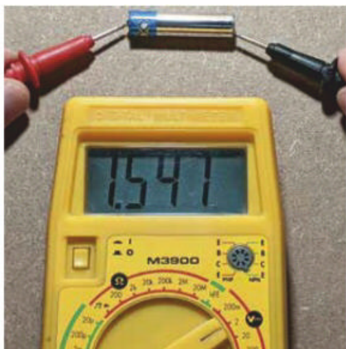
Photo 2. Pour le contrôle de la tension d'une pile standard, LR6 par exemple, on choisit le calibre 2 V. À l'écran, la valeur 1,541 confirme le bon état de la pile.
