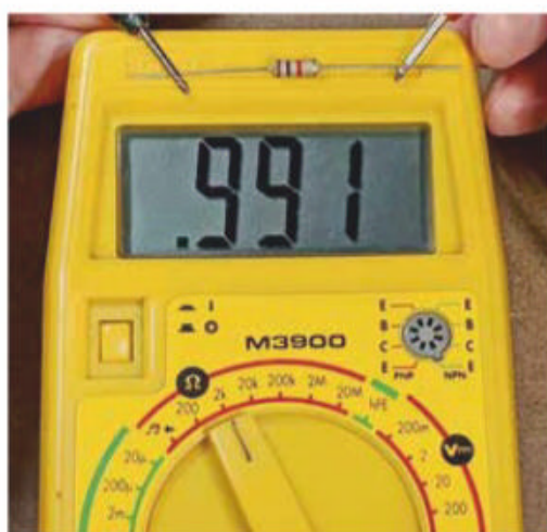
Photo 4. Le contrôleur propose aussi plusieurs calibres pour les résistances : 200 Ω, 2kΩ (2 000 Ω), 200 kΩ, 2 MΩ (2 000 000 Ω), 20MΩ.
