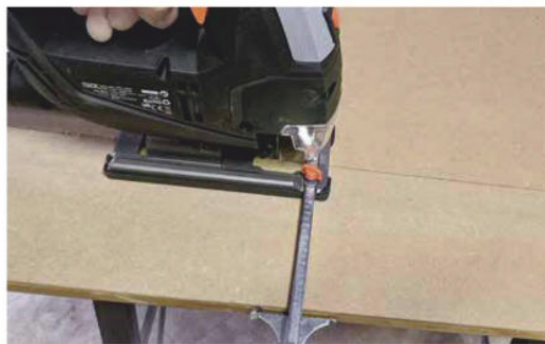
Photo 2. Si votre scie est équipée d'un guide, les découpes droites seront grandement facilitées.
