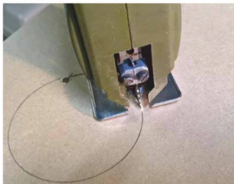
Photo 4. Une découpe circulaire demande un peu plus de soin pour bien suivre le tracé. Il faut utiliser la lame de la plus faible largeur possible, principalement pour les petits diamètres.
