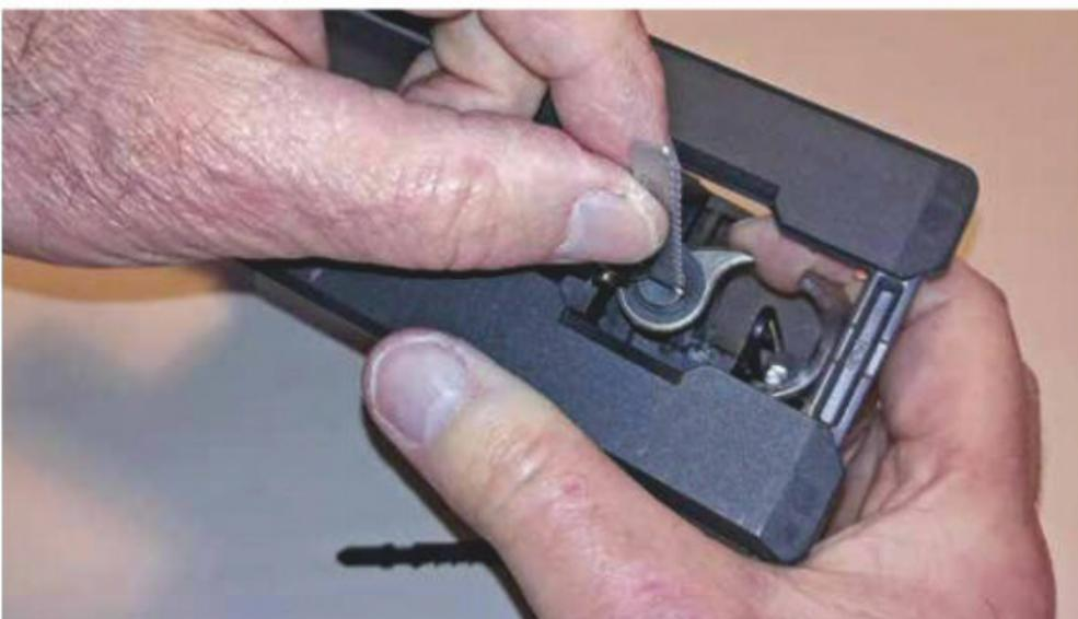
Photo 3. Un système de verrouillage de la lame par simple encliquetage, d'une grande facilité d'utilisation, s'avère être un vrai plus à l'usage.
