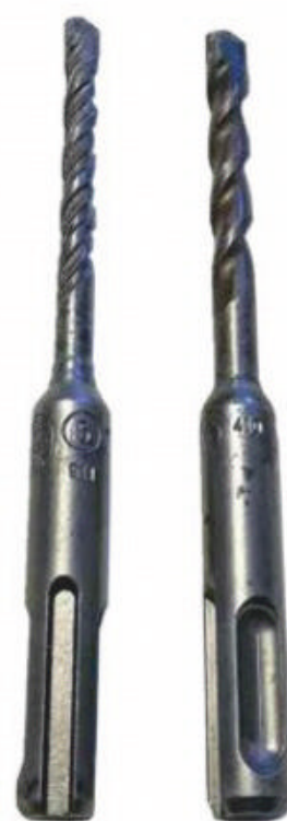
Photo 2. Les forets SDS se mettent en place par encliquetage et leur maintien est beaucoup plus résistant qu'un simple serrage par mandrin.
