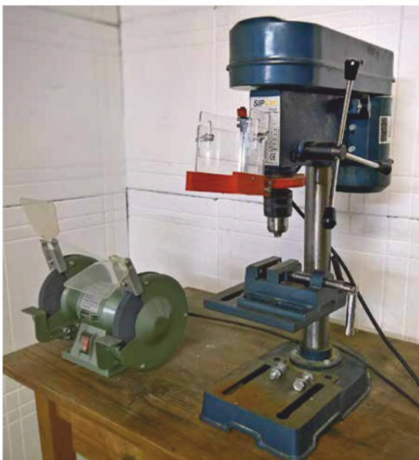
Photo 6. Une perceuse à colonne nécessite de disposer d'un petit poste de travail bien dégagé pour faciliter son utilisation.
