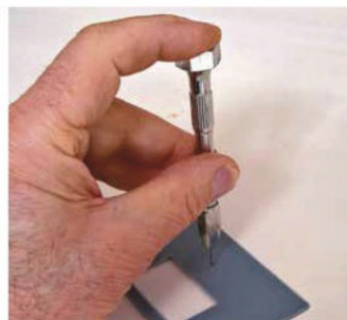
Photo 5. Rien de mieux qu'une drille pour réussir sans casse des perçage de quelques dixièmes de millimètre, dans de la carte plastique.
