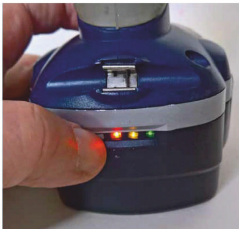
Photo 3. Contrôle de la charge de la batterie par led.
