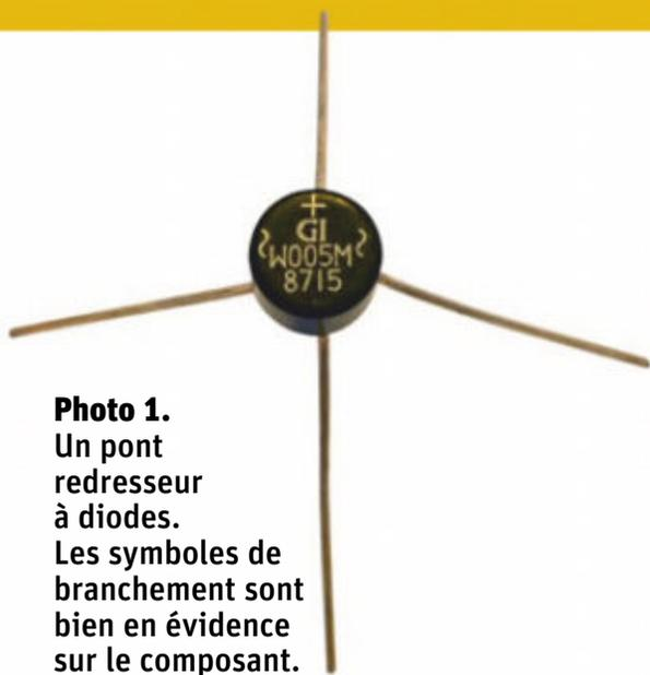
**Photo 1.** Un pont redresseur à diodes. Les symboles de branchement sont bien en évidence sur le composant.
