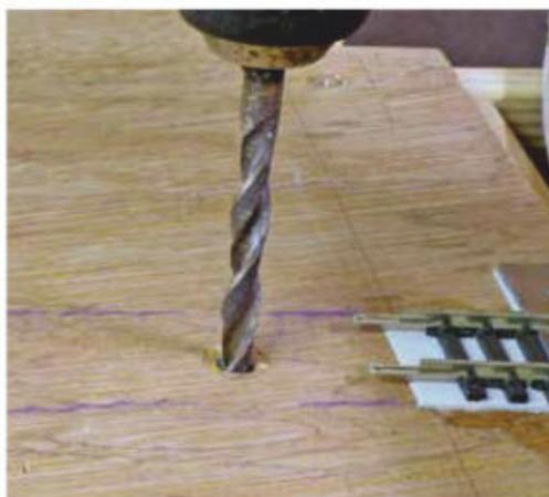
**16** Percez l'emplacement sous la lame mobile avec un foret de 6 mm. Poncez avec du papier de verre fin (grain 250).
