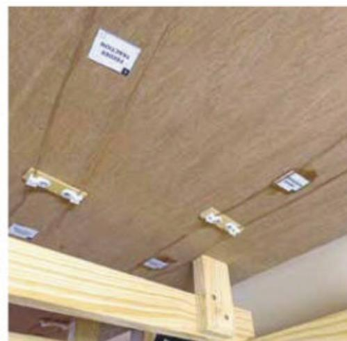
**7** Installez les deux feeders d'alimentation. L'écartement de 40 mm entre les deux fils est assuré par des agrafes Viessman réf. 6846 vissées sur des sections (60 x 20 mm) de MDF de 3 mm.
