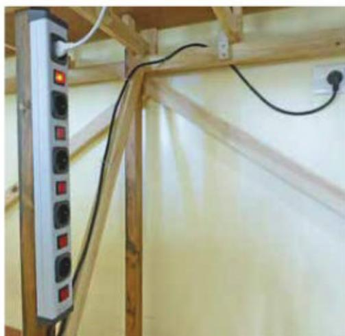
**5** Une prise multiple est installée sur un pied du réseau. Elle permet d'alimenter l'éclairage, les alimentations « traction » et « accessoires ». Elle sert aussi à alimenter un néon pour travailler sous le réseau.
