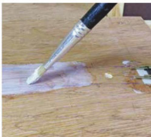
**19** Appliquez de la colle à bois à l'emplacement de l'aiguille, en évitant la zone de la partie mobile. Posez l'aiguille et mettez sous presse.
