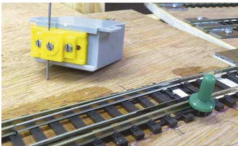
**29** Actionnez l'interrupteur. Le moteur positionne sa tige de commande sur « Poz 1 » ou « Poz2 ». Sur la plateforme de roulement, bloquez l'aiguille dans la même position à l'aide d'une punaise.
