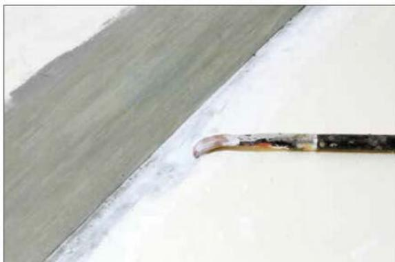
**12** De chaque côté de la chaussée se trouvent les accotements. Ceux-ci mesurent environ 1,50 m, soit 17 mm en H0. Mais tous les cas de figure existent dans la réalité... De la colle vinylique est appliquée généreusement au pinceau.
