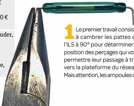
**1** Le premier travail consiste à cambrer les pattes de l'ILS à 90° pour déterminer la position des perçages qui vont permettre leur passage à travers la plateforme du réseau. Mais attention, les ampoules de
