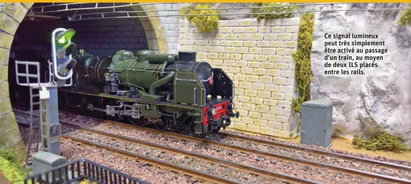
Ce signal lumineux peut très simplement être activé au passage d'un train, au moyen de deux ILS placés entre les rails.
