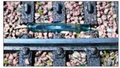
**3** L'ILS sera placé de préférence au centre de la voie (légèrement décalé dans le cas du trois rails, comme sur la photo) pour une meilleure captation du champ magnétique de l'aimant. Pour une parfaite intégration, il est préférable de découper les traverses au droit de celui-ci. Après ballastage, l'ILS deviendra quasiment invisible.
