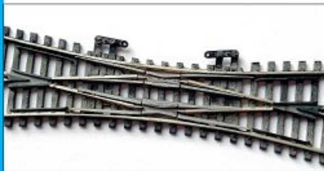
Très souvent, les rails d'occasion ont déjà eu une vie mouvementée sur un autre réseau. Cette traversée-jonction double (ou TJD) de la marque Fleischmann a vraisemblablement beaucoup vécu : elle est inutilisable pour un réseau fonctionnel. La commande des lames a disparu, et le profilé est très oxydé.
