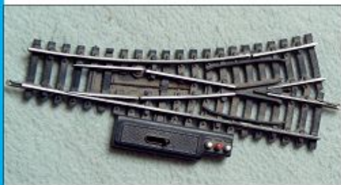
Une aiguille Jouef de l'époque « New Rail ». Outre le matériau du rail, le petit rayon de courbure et la réalisation grossière de l'ensemble le rend incompatible avec le matériel roulant actuel (photo : Xavier Lefort).
