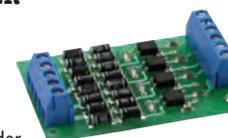
Die Meldung geschieht auf Grundlage der Überwachung des Stromverbrauchs der Gleisabschnitte. Betriebsspannung: 4 - 24 V DC/AC · Max. Ausgangsstrom: 50 mA.
