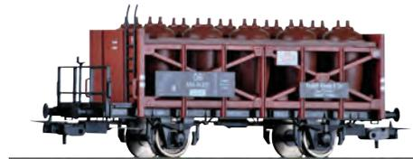
**Ausstattung:** NEM-Kupplungsschacht · Kurzkupplungs-Kinematik. Stromsystem: DC · LüP / Lük: 102 mm.
