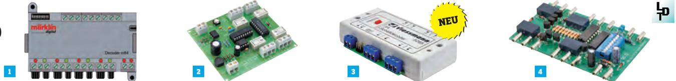
Zum Schalten von Dauerstrom wie Beleuchtungen, Lichtsignale und motorische Weichenantriebe mit Endabschaltung. **Bausatz** mit ausführlicher Anleitung. **Bausteine** fertig aufgebaut und geprüft.
