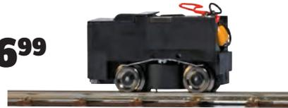
**Ausstattung:** Komplettes Fahrwerk für HOi/Hof-Lok-Modelle (Maßstab 1:87, Spurweite 6,5 mm) bestehend aus Kunststoffblock mit Mikromotor, Magnet, Getriebe und Rädern. Als Fahrwerk für individuelle Aufbauten oder als Austauschfahrwerk u.A. für die Feldbahnloks Gmeinder 15/18 und Grubenbahnloks B 360 verwendbar. Achsfolge B. Länge: ca. 26 mm. Stromversorgung: 3V Gleichspannung. Stromsystem: DC · LüP / LüK: 0 mm.
