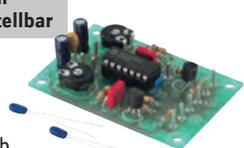
Mit Hilfe von Steckkontakten entscheiden Sie, ob die beiden Lämpchen gleichzeitig, wechselweise oder unabhängig voneinander blinken sollen. Und den Blinkrhythmus passen Sie mit zwei Trimmpotis individuell dem Verwendungszweck an. Ideal für Feuerwehrautos, Krankenwagen, Polizeiautos, Abschleppwagen und ähnliche Modellfahrzeuge.
