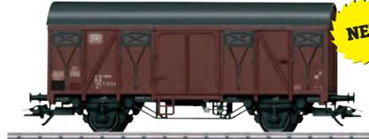
**Ausstattung:** NEM-Kupplungsschacht · Kurzkupplungs-Kinematik. **Technische Daten:** Herst.-Teilenr.: 44500 · Baugröße: H0 · Stromsystem: AC · LüP / Lük: 115 mm · Bauart: Gedeckter Güterwagen · Altersklasse: ab 15 Jahre.
