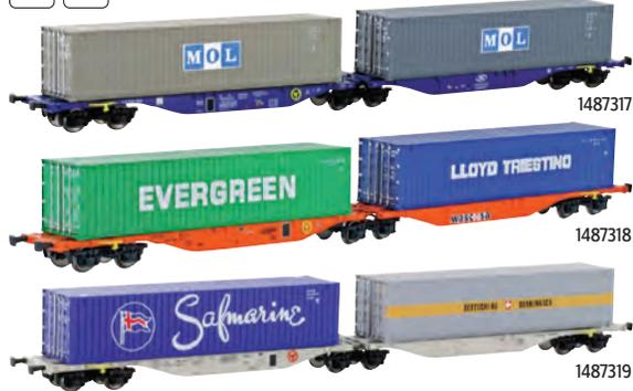
Der flexible Wagen eignet sich ausgezeichnet für die Ladungen von fast allen Containerarten sowie Wechselbehältern von 13,6m Länge. Dieser Containertragwagen Typ Sggrms 90 wird von zahlreichen Transportunternehmen in ganz Europa verwendet. Das Ladegewicht von 106t im Original ist bei diesem Wagentyp ausserordentlich hoch.
