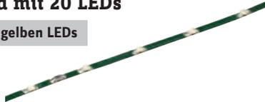
210 mm lang, 4 Segmente à 5 LEDs.
