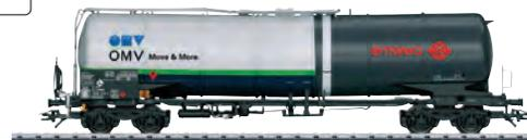
Zwei 95.000 l Kesselwagen der Bauart Zans bzw. Zacns mit unisoliertem Kessel und stirnseitigem Aufstieg. Privatwagen unterschiedlicher Betreiberfirmen. Registriert in Deutschland. Betriebszustand 2008.
