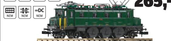
**Ausstattung:** Digital-Schnittstelle (PluX12) · Motor mit Schwungmasse · Antrieb auf 3 Achsen · Haftreifen · Lichtwechsel · Kurzkupplungs-Kinematik. LüP / Lük: 92 mm · Stromsystem: Analog DC Schnittstelle.
