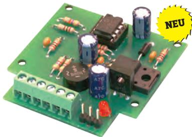
Analoge oder digitale Ansteuerung eines Servos. Lineare Bewegung zwischen den beiden Endlagen mit automatischem Halt bei Erreichen einer Endposition. Konstante Geschwindigkeit. Jederzeitige Unterbrechung des Bewegungsablaufs möglich. Fertigbaustein.
