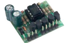
Beim Einschalten flackern die Lampen unabhängig voneinander. Danach werden sie stetig heller, bis sie ihre endgültige Leuchtkraft erreicht haben. Im Betrieb ist in unregelmäßigen Abständen ein kurzes Flackern (Simulation von Gasdruckschwankungen). Beim Ausschalten "glühen" die Laternen noch ein wenig nach.
