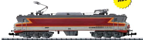
**Ausstattung:** Digital-Decoder (DCC/SX/SX2) · Motor mit Schwungmasse · Antrieb auf 4 Achsen · Haftreifen. LüP / Lük: 125 mm · Stromsystem: Digital DC.
