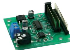
Zur Ansteuerung beleuchteter Werbeschilder, Umleitungsschilder oder Baustellenblitze. Betriebsspannung: 7 - 24 V DC/AC. Max. Stromverbrauch: 40 mA. Abm.: (L x B) 40 mm x 38 mm.
