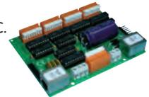
Passend zur Anlagenlichtsteuerung Light-DEC. Das Light-Display-Modul hat 40 Ausgänge, die jeweils einen Strom von bis zu 0,5 A liefern. Sie sind optimal für den Einsatz von Modellbahnlämpchen und LED geeignet.
