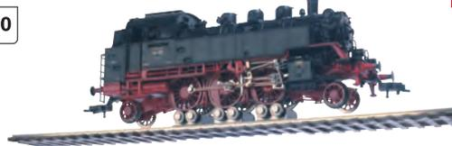
Über 3 variable Rollböcke wird der Fahrstrom von der Schiene auf die Räder Ihrer Lokomotive übertragen. Ideal zur Lokreparatur, zum Motorölen sowie zur Vitrinenpräsentation. Über beigefügte Kontaktkferdem auch für das Märklin-System verwendbar.
