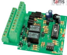
Zur Steuerung eines vorbildgerechten Pendelzugbetriebs zwischen zwei Endbahnhöfen. Beliebig viele Zwischenstopps möglich. Beschleunigungs-, Brems- und Haltephasen jeweils getrennt einstellbar. Zweigleisiger Betrieb im Endbahnhof möglich.
