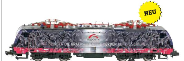
**Ausstattung:** Digital-Schnittstelle (Next 18) · Motor mit 2 Schwungmassen · Haftreifen · NEM-Kupplungsschacht · Lichtwechsel.
