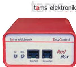
**Ausstattung:** EasyNet-Anschluss für bis zu 64 Geräte für das Digitalsystem EasyControl (z.B. LokControl). XpressNet-Anschluss für bis 16 XpresNet-Geräte (z.B. Lokmaus 2 und 3, Multimaus). Weitere Schnittstellen: 2x USB · s88 entsprechend s88-N · Spolige Booster-Schnittstelle (intern einstellbar für DCC oder Märklin) · Programmiergleis · Spannungsversorgung (12 V). Abm.: (L x B x H) 165 x 95 x 45 mm.
