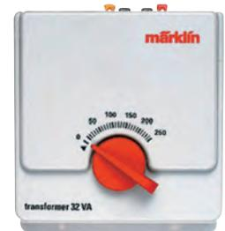
Regelbarer Transformator für Wechselstrombahnen. Bahnspannung zwischen 4 und 16 V einstellbar. Lichtspannung 16 V. Abm.: 120 x 140 x 80 mm. VDE-geprüft.
