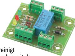
Diese Baugruppe vereint Anschaltung von Signalen mit den dazugehörigen Halteabschnitten. Die Zustandsanzeige erfolgt mit LEDs auf der Baugruppe. Platinenmaße: 100x70 mm. Betriebsspannung: 10 - 16 V DC/AC. Baustein fertig aufgebaut und geprüft. Bausatz mit ausführlicher Aufbauanleitung.
