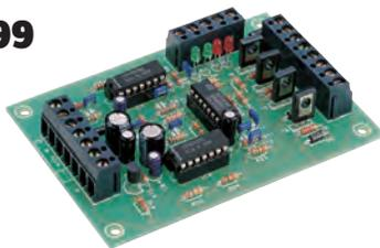
Mit dieser Steuerung können Sie mit nur einer Taste oder einem Reed-Kontakt die Weichen und beliebige Zweispulenrelais umschalten. Da der Schaltimpuls in der Dauer begrenzt ist, können Magnetantriebe mit und ohne Endabschaltung eingesetzt werden. Beim Einschalten nehmen die Antriebe eine definierte Grundstellung ein. Die Anzeige der Weichenstellung (Rückmeldung) erfolgt über LEDs. Mit diesem Bausatz können zwei Weichen angesteuert werden.
