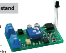
Durch das Infrarotlicht wird ein berührungsfreies Schalten eines Verbrauchers ermöglicht. Das vom Objekt (z.B. Lokomotive) reflektierte Infrarotlicht trifft den Sensor der Lichtschranke, dadurch wird ein Schaltvorgang aktiviert. Betriebsspannung: 8 - 16 V DC/AC. Max. Stromverbrauch: 30 mA. Abm.: (L x B) 44 x 33 mm.
