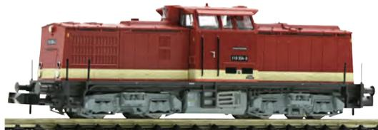
**Ausstattung:** Digital-Schnittstelle (6polig) · Antrieb auf 4 Achsen · Haftreifen · Lichtwechsel · NEM-Kupplungsschacht · Kurzkupplungs-Kinematik. LüP / Lük: 87 mm · Stromsystem: Analog DC Schnittstelle.
