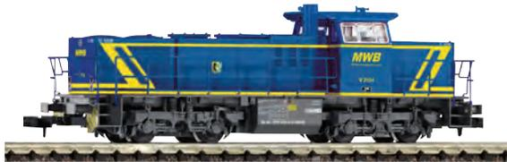
**Ausstattung:** Motor mit Schwungmasse · Lichtwechsel mit LEDs · Haftreifen · NEM-Kupplungsschacht · Kurzkupplungs-Kinematik · Befahrbarer Mindestradius: 192 mm.
