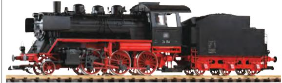
**Ausstattung:** Lichtwechsel · Rauchgenerator · Befahrbarer Mindestradius: 600 mm · Vorbereitet für Digital-Decoder und Sound.
