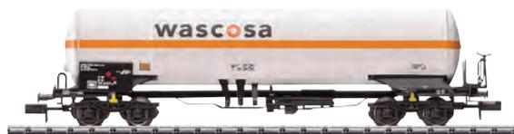
**Ausstattung:** NEM-Kupplungsschacht · Kurzkupplungs-Kinematik. LüP / Lük: 106 mm · Stromsystem: DC.
