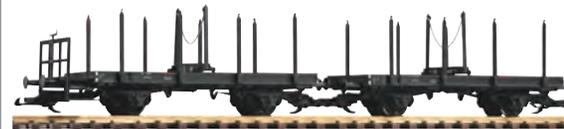
Formneuheit. Das Pärchen Drehschemelwagen ist ideal für den Transport von Langholz, Rohren oder Trägern. Zur Ladungssicherung liegen Metallketten bei. Die Rungen der Drehschemel lassen sich abklappen und die Einzelrungen sind steckbar.
