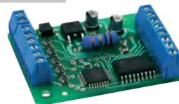
Der Baustein ermöglicht den automatischen Betrieb einer Bahnschranke mit bis zu 2 Gleisen. Ideal in Verbindung mit der IR-Lichtschranke (Best.-Nr. 49 70 86). Betriebsspannung: 7 - 24 V DC/AC. Max. Stromverbrauch: 500 mA. Abm.: (L x B) 47 mm x 37 mm.
