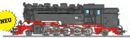
**Ausstattung:** Digital-Schnittstelle (8polig) · Lichtwechsel · Spezialkupplung. LüP / LüK: 143 mm · Stromsystem: Analog DC Schnittstelle.
