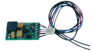
**Ausstattung:** Für DCC und Motorola (MM) geeignet · 320 Sekunden Soundspeicher · Soundabhängige Sonderfunktionsausgänge · 4 Kanäle gleichzeitig abspielbar · Funktion Mapping bis F28 · Sound auch im Analogbetrieb · Hallsensor für radsynchrone Auspuffschläge anschließbar · Mit SUSI-Schnittstelle · Anschlusspads für Speicherkondensator · Für Lautsprecher mit 8 Ohm Impedanz. Abm.: (L x B x H) 18.7 x 11.1 x 3.8 mm
