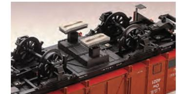
Setzen Sie Ihre Züge zum Reinigen der Schienen ein! Die beiden Reinigungsblöcke werden mit Federdruck angedrückt und reinigen so die Schienen während der Zug fährt. Das Schienenreinigungs-Gerät kann an vielen zweiachsigen LGB-Wagen montiert werden.
