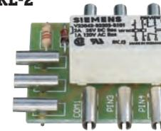
Der Baustein betreibt ein bistabiles Relais. Platinenmaße: ca. 26 x 28 mm. 2x UM. Als Bausatz oder betriebsfertig aufgebauter und geprüfter Baustein. Lieferung mit Relais.
