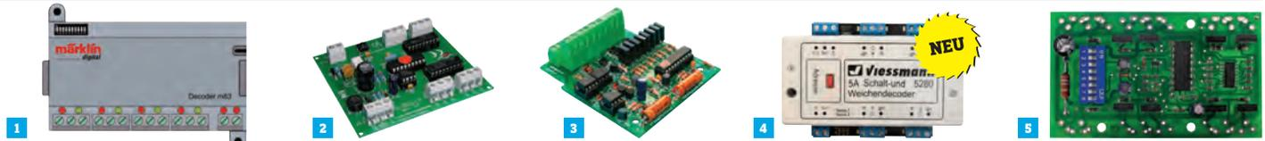
Zum Schalten von Magnetartikeln mit Doppelpulsenantrieb wie Weichen und Formsignale. **Bausatz** mit ausführlicher Anleitung. **Bausteine** fertig aufgebaut und geprüft.
