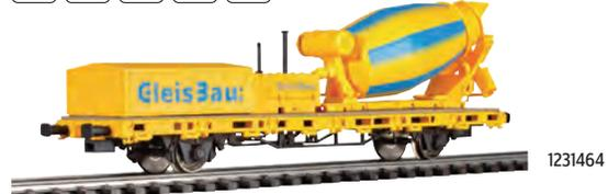
Arbeitsfahrzeug für den Gleisbau, z. B. zum Gießen von Signal- und Oberleitungsfundamenten.
