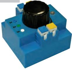
Dieser Mikrocontroller gesteuerte Fahrregler bietet über 3 Tasten die Möglichkeit die Geschwindigkeitskennlinien auszuwählen. Zusätzlich wird über eine spezielle Modulation der Ausgangsspannung ein sanftes Anfahren gewährleistet. Der Regler gehört zur Modulreihe Trafo - Fahrregler - Leistungsanzeige. Diese Module können beliebig kombiniert werden. Über eine Stromschiene können alle Module untereinander verbunden werden.
