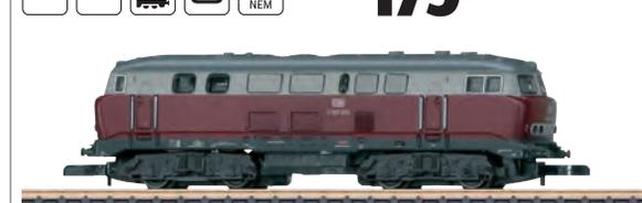
**Ausstattung:** 5poliger Motor · Antrieb auf beiden Drehgestellen · Lichtwechsel mit LEDs. LüP / Lük: 75 mm · Stromsystem: DC.
