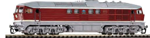
**Ausstattung:** Digital-Schnittstelle (PluX16) · Motor mit 2 Schwungmassen · Antrieb auf 4 Achsen · Haftreifen · Lichtwechsel. LüP / Lük: 172 mm · Stromsystem: Analog DC Schnittstelle.
