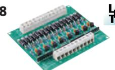
Wenn Sie das Roco®-Digital-System zusammen mit dem Roco®-Interface 10785 und der Software Rocomotion® einsetzen, können Sie den Gleisbelegtmelder GBM-8 als Erweiterung zum Roco® Rückmelde-Moduls 10787 zur komfortablen und preiswerten Gleisbelegtmeldung verwenden. Baustein fertig aufgebaut und geprüft. Bausatz mit ausführlicher Aufbauanleitung.
