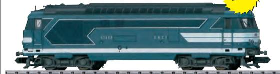
**Ausstattung:** 14-polige Digital-Schnittstelle · 5-poliger Motor mit Schwungmasse · Lichtwechsel mit LEDs · Antrieb auf 4 Achsen · Haftreifen · Kurzkupplungs-Kinematik. LüP / Lük: 107 mm · Stromsystem: Digital DC.
