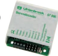
Einstellbare Schaltadresse, Endanschläge und Drehgeschwindigkeit · Nachwippfunktion · Servoausgänge mit Überlastungsschutz. **Technische Daten:** Format: DCC / MM · Max. Gesamtstrom: 700 mA · Adressen-Bereich: 1-2048 · Bezeichnung: 67800 · Adress-Einstellung: Zentrale · Funktionsausgänge: 4 · Betriebsspannung: 16 V/AC
