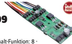
**Technische Daten:** Format: DCC · Schalt-Funktion: 8 · Adressen-Bereich: 1-10239 · Kabel werkseitig angelötet: Ja · Max. Motorstrom: 3000 mA · Fahrstufen: DCC 14/28/128 · Analog-Betrieb möglich: Ja · Last-Regelung: Ja · Adress-Einstellung: Zentrale · Funktionsausgänge: 6 · Motor-Typ: belastbar mit max. 2 LGB Motoren · Max. Gesamtstrom: 4000 mA · Altersklasse: ab 15 Jahre · Anzahl Ausgänge: 2 x · Bezeichnung: 55027 · Automatische Systemerkennung: Ja
