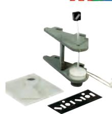
Der Weichenlaterneantrieb wird vom Weichenantrieb Best.-Nr.: 49 99 40 angesteuert. Er kann links oder rechts angesetzt werden. Die Laterne ist in einem Radius von ca. 6mm frei positionierbar und wird über einen Lichtleiter beleuchtet. LED und Vorwiderstand liegen bei.
