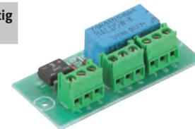
Der Baustein ist für Ein-, Aus- oder Umschaltung von Licht- oder Bahnstromkreisen vorgesehen. Er wird durch Taster, Schaltkontakte, Reedkontakte oder potenzialfreie Schaltgleise gesteuert.
