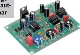
Dieser Bausatz erzeugt das bekannte Glockensignal (ting, ting, ting) so, wie es bei Schienenübergängen oder bei der Bimmelbahn bekannt ist. Mit Trimpotis sind Klangfarbe, Folgefrequenz und Lautstärke einstellbar. Betriebsspannung: 15 - 18 V/DC · Stromaufnahme ca. 100 mA · Abm. 75 x 58 mm · Ausgangsleistung max. 1 W für Lautsprecher 4 - 8 Ω · Bausatz mit ausführlicher Bauanleitung.
