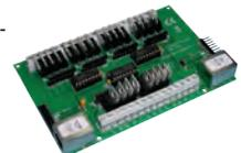
Passend zur Anlagenlichtsteuerung Light-DEC. Das Light-Power-Modul mit 24 Ausgängen, liefert einen Strom von maximal 2,5 A pro Ausgang. Wegen des hohen Ausgangsstroms eignet es sich gut, um sehr viele Modellbahnlämpchen, z.B. in Lichtmasten einer Straße, gleichzeitig zu schalten.
