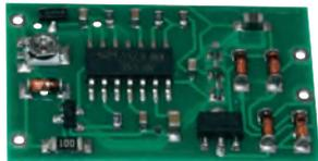
Um kleine 0,3 - 6 V Motoren auch an einer höheren Spannung zu betreiben, wurde diese PWM entwickelt. Die Schaltung eignet sich z.B. zur Ansteuerung von Sonderfunktionen im RC Modellbau und Eisenbahnmodellbau. Betriebsspannung: 6 - 18 V DC/AC; Ausgangsspannung: 5 V DC (moduliert); Ausgangsstrom: max. 100 mA. Abm.: (L x B x H) 31 x 20 x 8 mm.
