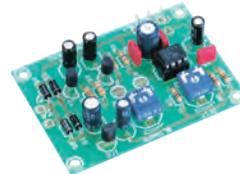
Ermöglicht die Steuerung von Warnblinkanlagen, Überweg- sowie Bahnübergangssicherung o. ä. Die Impuls-Auslösung (Reedkontakte oder Drucktaster) steuert den Wechselblinker für eine einstellbare Zeit von ca. 2 bis 30 s an. Die Blinkfrequenz läßt sich von ca. 0,5 bis 5 Impulsen/s einstellen. Eingangsspannung 12 - 14 V DC/AC · Abm. 70 x 50 mm. **Ausstattung:** mit Aufbauanleitung.
