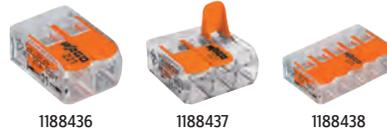
**Technische Daten:** Anschluss: Zugfeder · Nennstrom: 32 A · Querschnitt starr (max.): 4 mm<sup>2</sup> · Querschnitt flexibel (max.): 4 mm<sup>2</sup> · Farbe: Transparent · Orange · Querschnitt starr (min.): 0.2 mm<sup>2</sup> · Querschnitt flexibel (min.): 0.14 mm<sup>2</sup> · AWG: 24 - 12 · Isolationsmaterial: Kunststoff · Abisolierlänge: 11 mm · Temperaturbereich: bis +105 °C · Nennspannung: 450 V.
