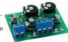
Verbraucher, die an die beiden Ausgänge angeschlossen sind, werden durch den Blinkerschaltkreis gemäß dem voreingestellten Zeittakt ein- und ausgeschaltet. Der Zeittakt ist zwischen 0,1 s und 5 s einstellbar. Betriebsspannung: 5 - 24 V DC/AC. Max. Stromverbrauch: 500 mA.
