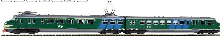
**Ausstattung:** Digital-Schnittstelle (PluX 12) · Motor mit Schwungmasse · Antrieb auf 4 Achsen · Haftreifen · Innenbeleuchtung · Lichtwechsel · Kurzkupplungs-Kinematik.
