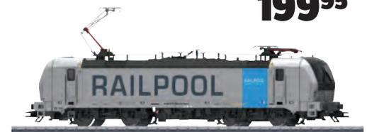
**Ausstattung:** Spezialmotor · Antrieb auf 4 Achsen über Kardanwelle · Haftreifen · Lichtwechsel mit LEDs.
