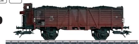
**Ausstattung:** Mit Kohlenbeladung · Mit Bremserhaus und Bremserbühne · NEM-Kupplungsschacht · Kurzkupplungs-Kinematik.
