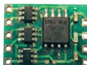
Ideal für Sonderfunktionen! Ein-/Aus-schalten von 5 einzelnen Ausgängen mit nur einem Steuerknüppel! Betriebsspannung: 2,7 - 5,5 V/DC · Ausgangsleistung pro Kanal: 500 mA · Gewicht ohne Kabel: 0,5 g · Abmessungen: 16 x 12 x 2,5 mm.
