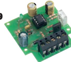
Zum Verzögern eines Masseimpulses für eine einstellbare Zeit. Wenn der Eingang des Bausteins einen Masseimpuls erhält bleibt der Ausgang zunächst für die eingestellte Zeit (zwischen 0 und ca. 60 Sekunden) geöffnet. Nach Ablauf der eingestellten Zeit produziert der Ausgang einen Masseimpuls, der genauso lang ist, wie der des Eingangsimpulses.
