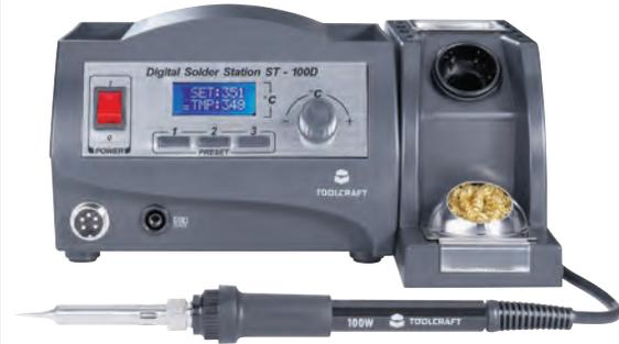
**Technische Daten:** Abm.: (L x B x H) 150 x 160 x 113 mm · Temperaturbereich: +150 bis +450 °C · Betriebsspannung: 230 V · Abm. LötKolbenablageständer (B x H x T): 70 x 103 x 193 mm.
