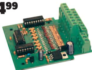
Meldet die aktuelle Stellung von bis zu 4 Weichen und Signalen mit Doppelspulenantrieben. Nicht geeignet für Weichen mit Endabschaltung. Reagiert auch, wenn die Weiche manuell verstellt wird. Auswertung gegen Masse. Betriebsspannung: 14 - 18 V/AC. Abm.: (L x B) 73 x 80 mm.
