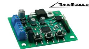
Mit dieser Servo-Ansteuerung können 2 Servos unabhängig voneinander gesteuert werden. Betriebsspannung: 7 - 24 V DC/AC. Max. Stromverbrauch: 1000 mA. Abm.: (L x B) 47 x 47 mm.
