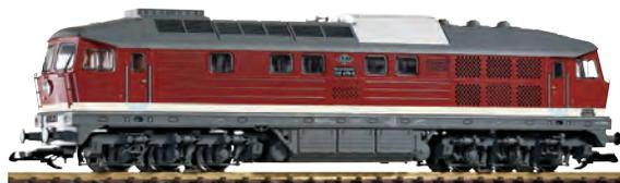
**Ausstattung:** Digital-Schnittstelle · 2x 5polige Motoren · Antrieb auf 4 Achsen · Lichtwechsel · Vorbereitet für Führerstandsbeleuchtung.
