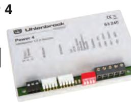
Einsetzbar im 2- und 3-Leiter-Betrieb für DCC, Motorola, mfx, Selectrix und FMZ · Kurzschlussicher und gegen Überlast geschützt · Maximaler Ausgangsstrom 3,5 A · Anschlüsse: Loco Net B, DCC-Booster, Märklin-Booster.
