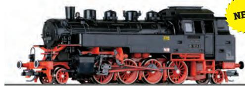
**Ausstattung:** Digital-Schnittstelle (6polig) · Lichtwechsel · NEM-Kupplungsschacht · Kurzkupplungs-Kinematik.
