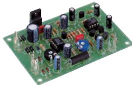
**Ausstattung:** In das Modul werden die Betriebsspannung (12 bis 18 V- oder =) sowie die Fahrspannung (0 bis 15 V- oder =) eingespeist. Je nach Fahrspannung bzw. Geschwindigkeit wird auch das Dampflokgeräusch langsamer und schneller. Zusätzlich kann die Klangfarbe mit einem Trimpoti verändert werden. Für 8 Ohm Lautsprecher.
