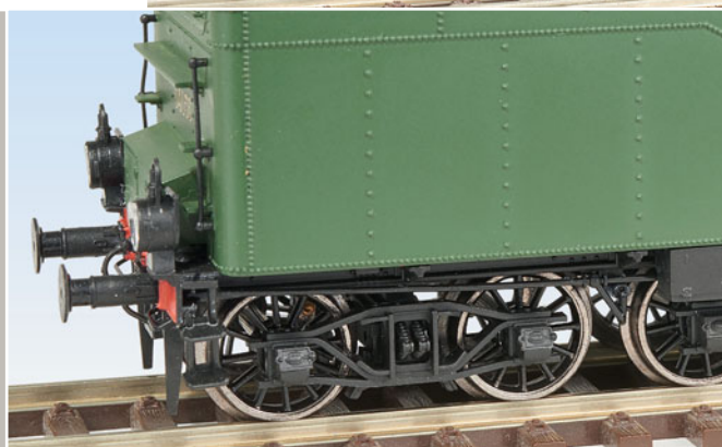
Der Tender fällt besonders durch seine sehr filigranen Fachwerkdrehgestelle und die feinen Speichenräder ins Auge. Fotos: gp
