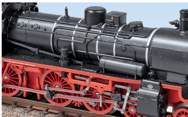
Lokführerseite mit Luftpumpe und Luftbehälter sowie angesetzter Umsteuerstange
