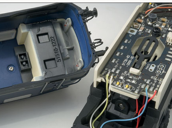
Der Lokkasten wird durch Spreizen entriegelt und kann bequem abgehoben werden.
