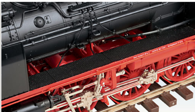
Zwischen Kessel und Umlauf sind die Pendelbleche und der Hilfsluftkessel zu erspähen.
