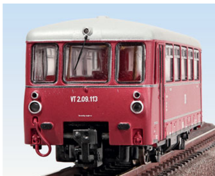
Die Nachbildung der Scharfenberg-Kupplung steckt im Normschacht des VTs.
