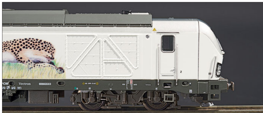
Die Drehgestellblenden der Lok sind an mehreren Stellen fein durchbrochen. Es werden alle Details des Vorbilds wiedergegeben.
