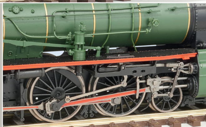
Beachtenswert ist ebenso das Speisewasserventil mit seinen Flanschen wie auch die feingestalteten Bremsen.
