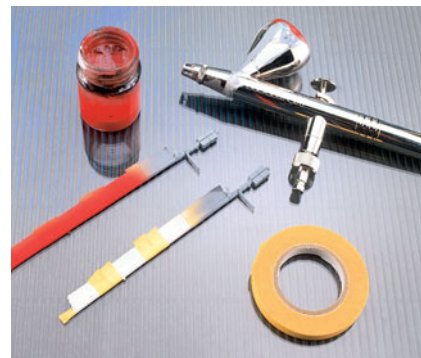
Nach sorgfältigem Abkleben werden die Schrankenbäume gespritzt.
