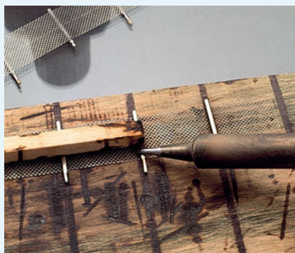
Die zuvor einseitig verzinnnten Pfosten unter Zuhilfenahme einer Holzleiste werden Stück für Stück im 20-mm-Abstand aufgelötet.
