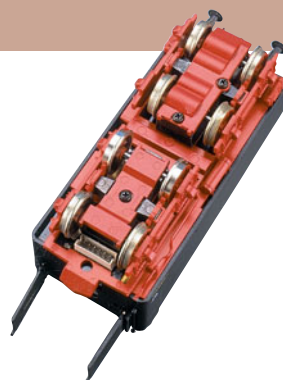
Durch die Berücksichtigung kleiner Modellbahnradien sind die Drehgestelle etwas zu breit geraten.
