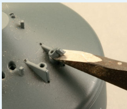
Mit einem scharfen Flachstichel werden die angespritzten Haltewinkel entfernt. Zuvor wurden ihre oberen und unteren Enden durch Nadellöcher markiert.
