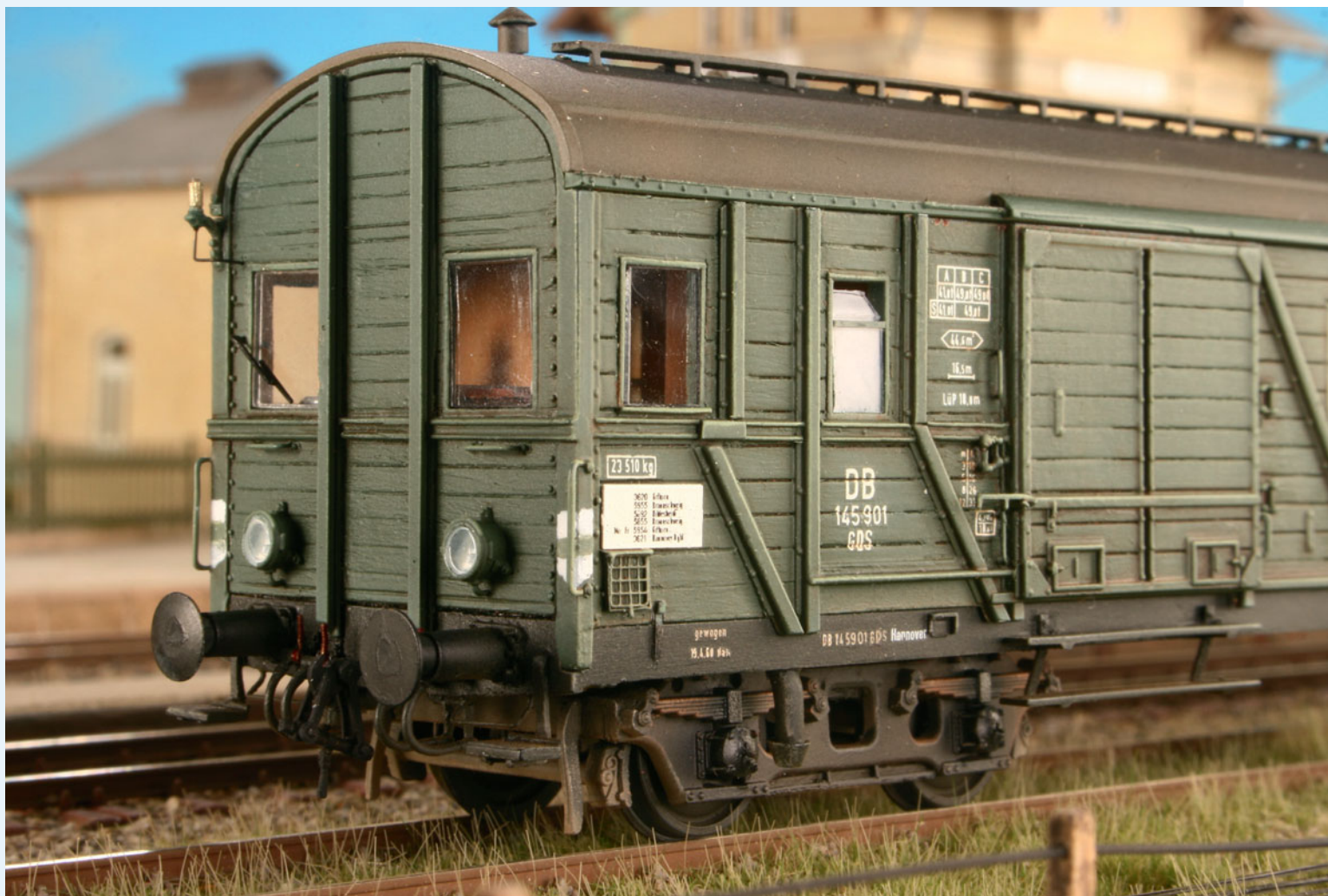
Die fertig zuggerüstete und lackierte Stirnseite. Man beachte auch den Scheibenwischer und die feine Druckluftleitung für das Läutwerk.
