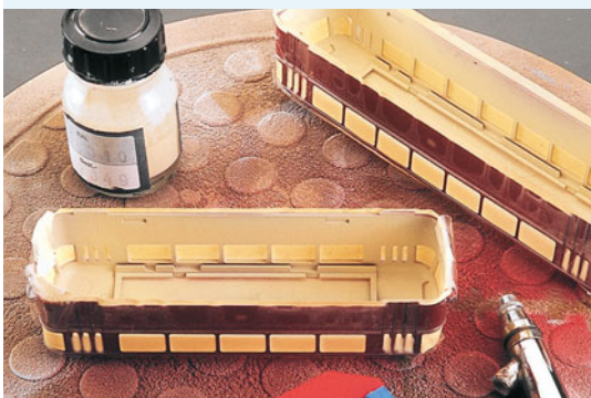
Vorbildentsprechend wird die Innenseite des Gehäuses in Beige lackiert.
