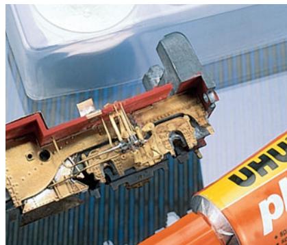
Zum Ankleben der Pumpenbauteile unter den Lokrahmen eignet sich „UHU plus acrylit“.
