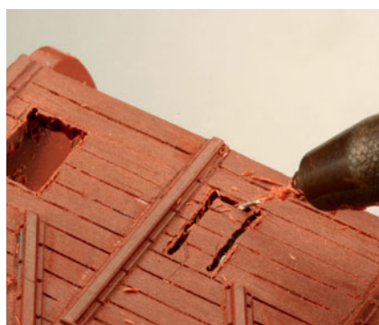
Wo für die Säge nicht genügend Platz ist, hilft ein feilenartig bewegter 0,5-mm-Bohrer weiter.
