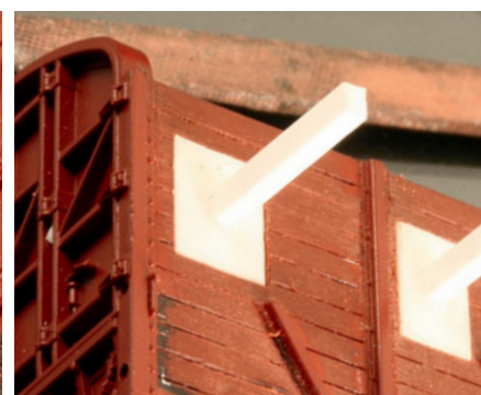
Selbst gebaute Lehren für die Fensterausschnitte sorgen für einheitliche und saubere Abmessungen.
