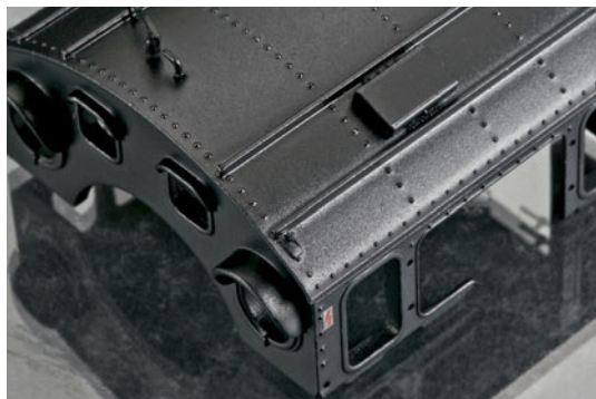
Nach dem Lackieren des Dachs wirken die erneuerten Dachhaken viel zierlicher, zumal sie vorbildgerecht leicht angespitzt sind.
