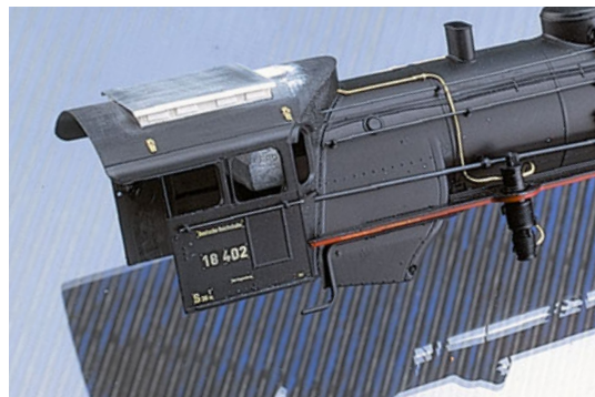
Die seitlichen Lüfterklappen am Dachaufsatz werden aus hauchdünnen Polystyrolstückchen gefertigt und aufgeklebt.
