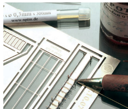
Die beiden Längsstreben der Tankaufstiegsleiter sind nach oben zu klappen. Die Sprossen aus 0,3-mm-Messingdraht werden durch entsprechende Löcher gesteckt und verlötet.
