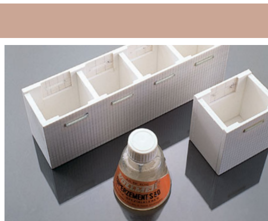
Die Pfeilerwände werden mit zusätzlichen Platten verstärkt und anschließend mit den stützenden Zwischenwänden verklebt.
