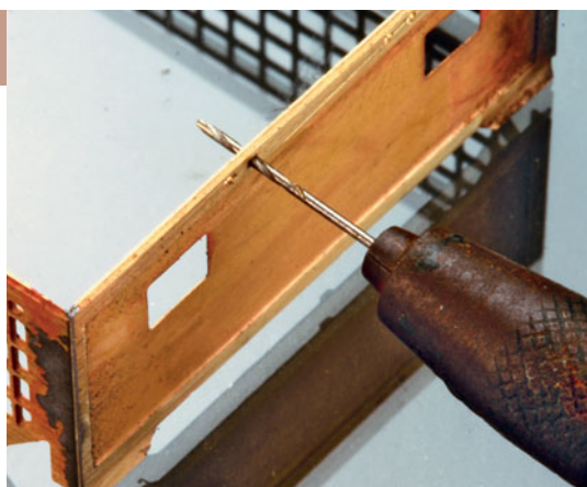
Die angeätzten Löcher für die Haltetaschen werden aufgebohrt.
