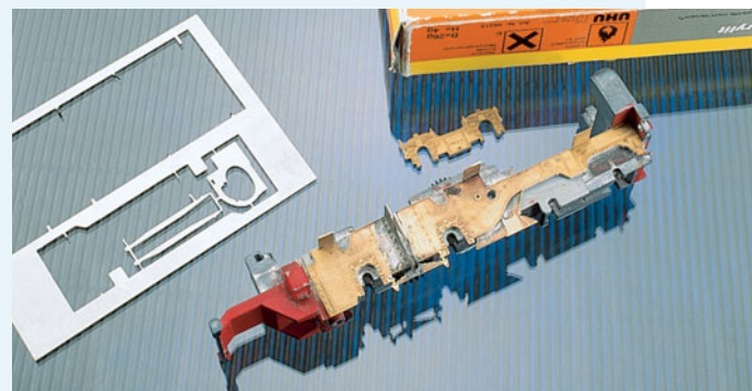
Vor dem Verkleben der Rahmenblenden lötet man Steuerungsträger und Aschkasten an.
