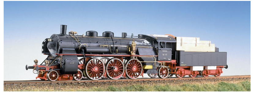
Auf der Heizerseite der 18.4 erkennt man gut die hinzugefügten Leitungen und Bauteile am Kessel.
