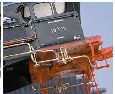
Die beiden Dampfstrahlpumpen und Abschlammventile unter dem Führerhaus entstehen aus Reitz- und Weinert-Teilen.
