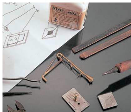
Die Messingussteile, wie z.B. der Wasserkran von Weinert, werden am besten verlötet.
