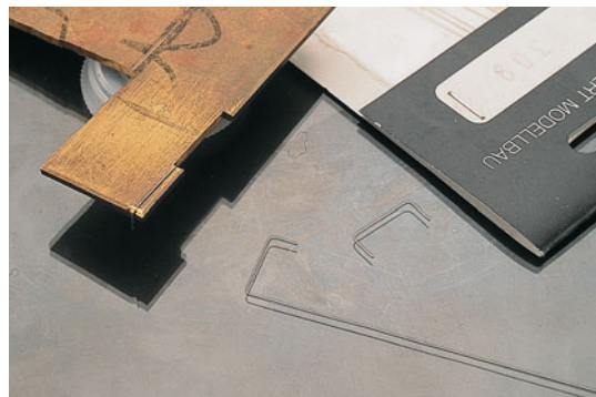
Alle Griffe müssen dieselbe Form aufweisen. Dazu fertigt man sich eine Biegeschablone z.B. aus 1-mm-Messingblech. Die eigentlichen Biegekanten werden mit einer Feile leicht abgerundet.
