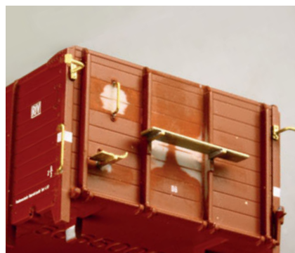
Die zugerüstete Wagenwand. Neue Tritte für die Stirnwand entstehen aus 0,5-mm-Messingblech und Haltern aus 0,5-mm-Draht.
