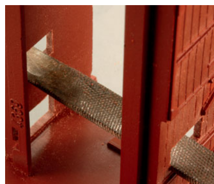
An das exakte Maß der Fensteröffnungen tastet man sich mit gezielten Feilenstrichen heran.
