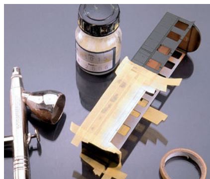
Im Bereich der ersten Klasse wird der weiße Balken aufgespritzt. Die übrige Fläche deckt man mit Klebeband ab.
