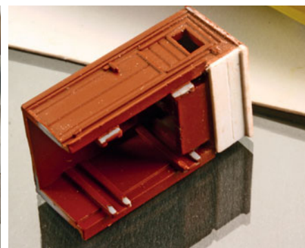
Oberhalb der Bordwand wird das Bremserhaus mit 0,5 mm starkem Polystyrol verkleidet. Ein Profil verlängert das Dach.
