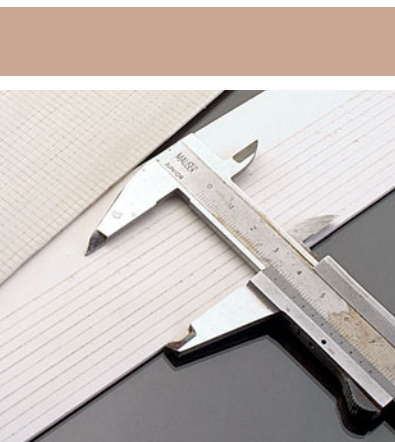
Das horizontale Fugenmuster wird mit einer präparierten Schiebelehre eingeritzt. Vertikal helfen Anschlagwinkel und Reißnadel.
