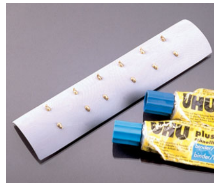
Nachdem die angeformten Dachlüfter entfernt worden sind, verschleißt man die zurückbleibenden Löcher mit UHU-Acrylit und bohrt laut beiliegender Zeichnung neue Löcher zur Aufnahme von Weinert Wendler-Lüftern (Art.-Nr. 8955).
