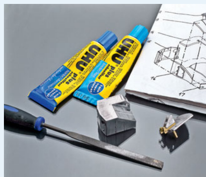
Beim Verkleben der Bauteile mit UHU-plus schnellfest hat man genügend Zeit, die Teile exakt auszurichten.
