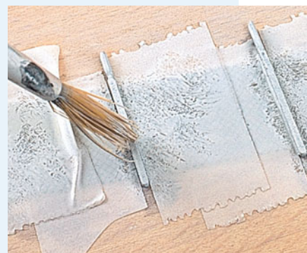
Bevor die Pfosten mit dem Pinsel grundiert werden, deckt man das Ätzteil mit Tesafilmstücken ab.
