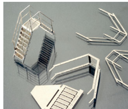
Die Treppe, die über die Schutzasse ragt, entsteht ebenfalls in Falttechnik mit eingelöteten Stufen und beiderseits angelöteten filigranen Geländern.
