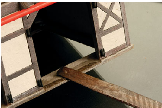
Im Bereich der Tore wird der Sockel mit Sekundenkleber überzogen. Der Karton saugt den Klebstoff auf, sodass sich die Kante später zu einer leichten Schräge feilen lässt.
