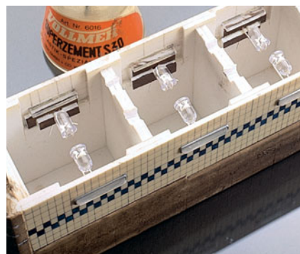
Zur Beleuchtung der Unterführung dienen wartungsarme, weiße LEDs. Sie werden im Inneren der Pfeiler eingeklebt und entsprechend mit Vorwiderständen verdrahtet und geschaltet.
