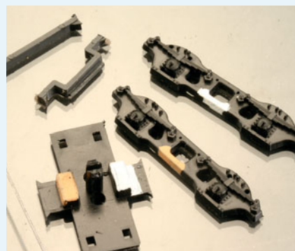
Die zersägten Drehgestelle. Unterschiedliche Farbmarken helfen, sie später wieder richtig zusammensetzen zu können.
