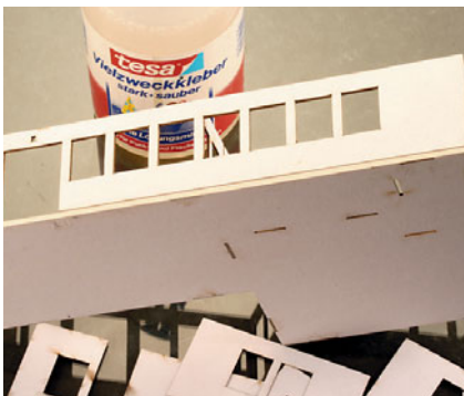
Das Verkleben der 0,4 mm dünnen Außenwände erfolgt mit lösungsmittelfreiem Allzweckkleber, da durch das längere Abbinden mehr Zeit zum Ausrichten vorhanden ist.
