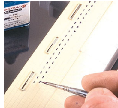
Das farbliche Absetzen einzelner Kacheln mit blauer Farbe erfolgt mit dem Pinsel. Zuerst werden die zu färbenden Kacheln markiert.
