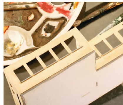
Beim Verkleben der Fensterbänke ist auf eine klare, optisch exakt fluchtende Linie zu achten. Ein angeschlagenes Stahllineal hilft dabei.
