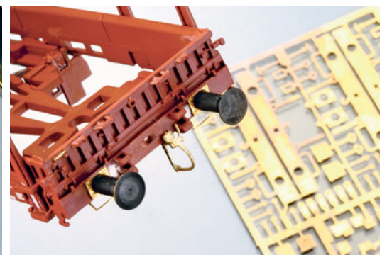
Jedes Wagenende erhält einen Bremsschlauch und auch der Griff in der Stirnwand oben links wird durch Draht nachgebildet.
