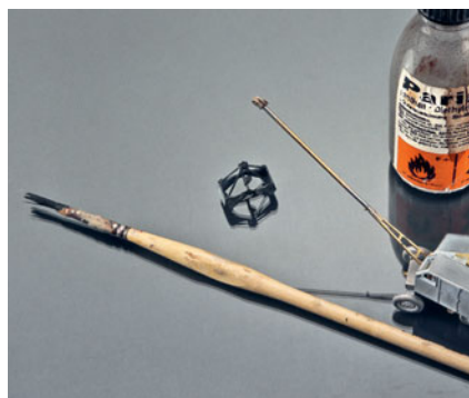
Statt zu lackieren, wird der beweglich gehaltene Greifer mit Brüniermittel eingefärbt. Das verhindert späteren Farbabrieb.
