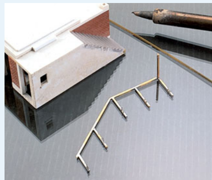
Das Treppengeländer entstand bei diesem Modell (aus Stabilitätsgründen) aus Messingprofil. Zur Befestigung dienen zuvor angelötete 0,5-mm-Drahtstifte.
