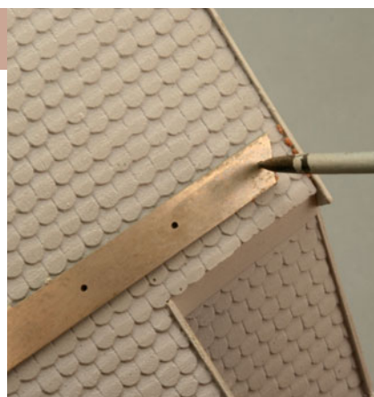
Bei Saemann dient der Ätzrahmen als Schablone. Durch die Löcher werden mit einem feinen Stift die Bohrpunkte markiert.
