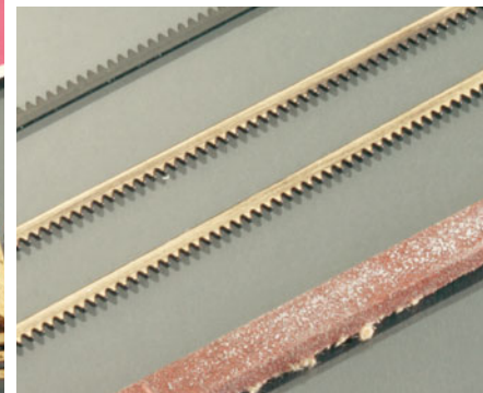
Um eine feste Klebeverbindung zu garantieren, sollte man die Zahnstangenstreifen mit einer Schmirellatte leicht anrauen.
