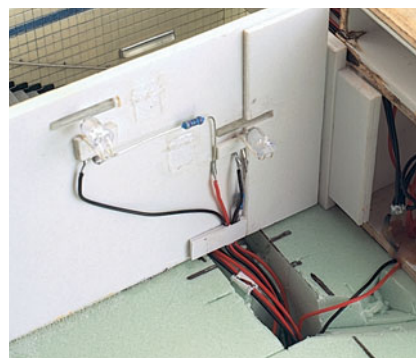
Auch der Aufstieg wird in dieser Weise beleuchtet. Gut zu erkennen: Verdrahtung und Befestigung der beiden LEDs.
