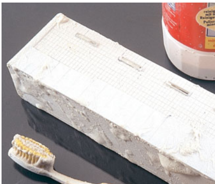
Vor der Lackierung sorgen Zahnbürste, Scheuervpulver und Spülmittelwasser für entgratete und mattierte Oberflächen der Bauteile.
