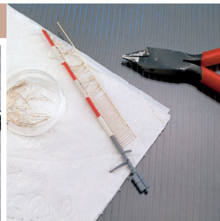
Die elastische Unterlage hilft, die kleinen Haken in die Ösen der Stange zu fädeln.
