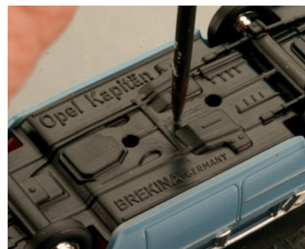
Damit der Bohrer nicht abrutscht und das Auto beschädigt, wird dessen Boden genau mittig angekört.
