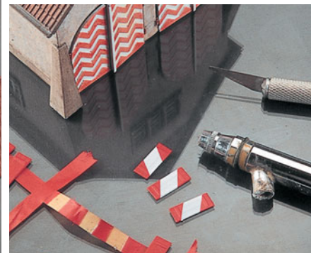
Die Fensterläden werden zunächst beiderseits dünner geschliffen. Dann bekommen sie ebenfalls einen zweifarbigem Anstrich. Der weiße Streifen wird, da zu hell, später blassgelb umgemalt.
