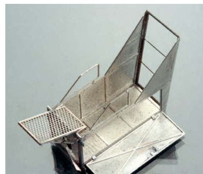
Nachdem der Wetterschutz mit der Bodengruppe verlötet ist, werden die Tür und die Arbeitsplattform eingehängt.
