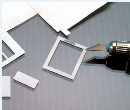
Die Fenster entstehen im Eigenbau aus 0,25-mm-Polystyrol. Dabei werden jeweils zuvor ausgeschnittene Innen- und Außenrahmen miteinander verklebt.
