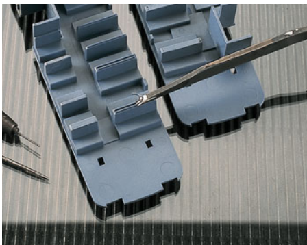
Die angeformten Haltebügel an der Oberseite der Lehnen kann man mit einem spitzen Flachstichel entfernen. Für die später einzusetzenden Drahtbügel aus 0,3-mm-Neusilberdraht werden 0,3 mm Löcher gebohrt.
