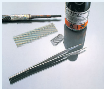
Brüniermittel verleiht dem Messingzaun ein mitgenommenes Aussehen, das mit Lack nur schwer zu erreichen ist.
