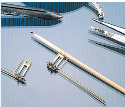
Die Strahlpumpen werden mit ihren Haltern verlötet. Die Zuleitungen verlegt man neu.
