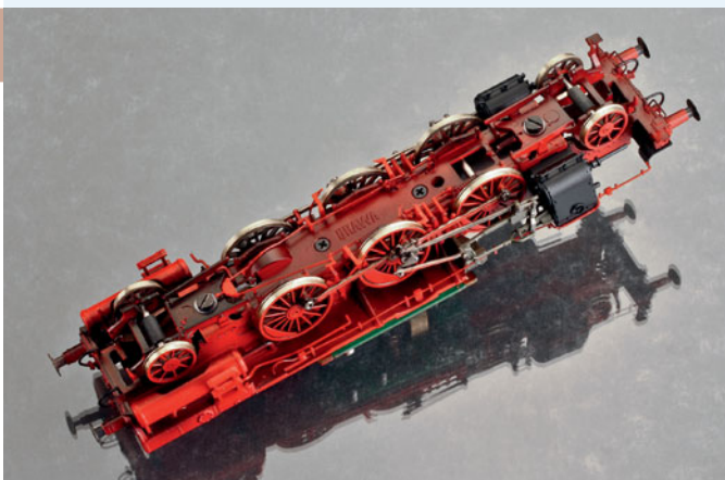
Das überarbeitete Fahrwerk hat H0pur-Radsätze erhalten und ist nur dezent, nicht übermäßig, gealtert worden.
