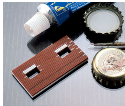
Beim Ablängen der Zubehörplatten entsteht automatisch in jeder vierten Reihe eine Lücke. Die Fugen werden mit Spachtel gefüllt und verschliffen.
