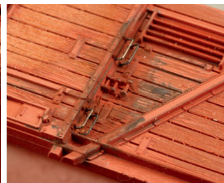
... der Türriegel durch ein Ätzteil von „AW Lingen“. Zu beachten ist die Befestigung der Doppelgriffe an bzw. neben den Türen.
