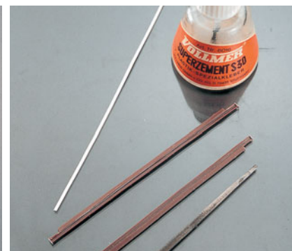
Mit einer kleinen Rundfeile wird die Materialstärke der Dachrinnen verringert. Die runden Abschlüsse sollten durch gerade ersetzt werden.
