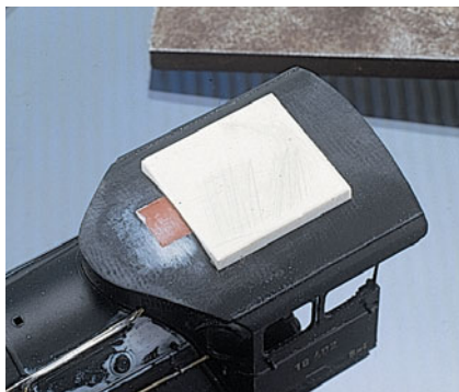
Der größere Lüfteraufsatz auf dem Führerhaus entsteht aus Polystyrol und Alublech.
