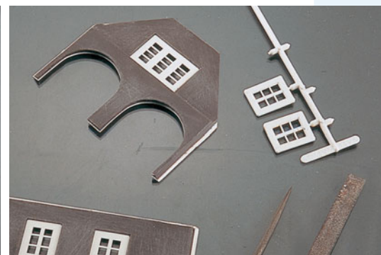
Auch der Sitz der Fensterrahmen wird vor dem Verkleben geprüft.
