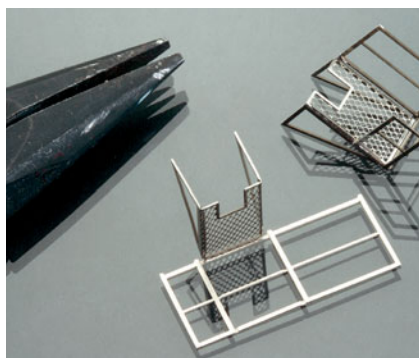
Die obere Bühne des Tanks besteht lediglich aus einem Teil, das entsprechend entlang der angeätzten Knickkanten zu falten ist.
