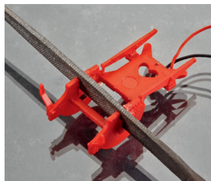
Ist das exakte Maß markiert, wird die Öffnung mit einigen Feilenstrichen Richtung Drehpunkt erweitert.
