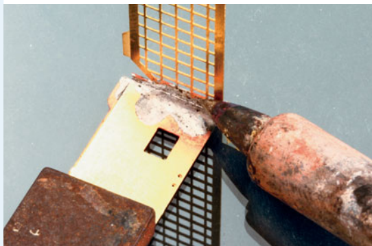
Nun lassen sich die Teile auf einer absolut planen Fläche mit Lötzinn neu zusammenfügen. Dabei müssen die Stirnwände zwischen die Gitterwände montiert werden.
