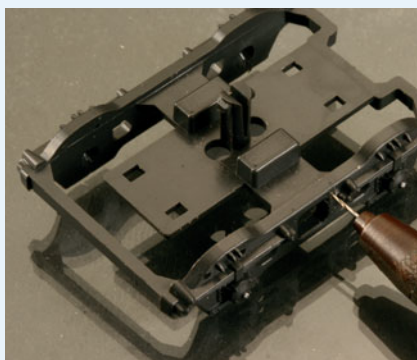
Das Verschmälern der Drehgestelle bereitet man vor, indem man durch Rahmen und Querträger pro Seite zwei 0,5-mm-Justierlöcher bohrt.
