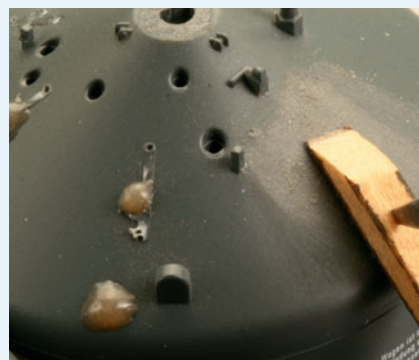
Die entstandenen Löcher schließt man mit Zweikomponentenkleber. Nach dem Aushärten wird der Überschuss mit Stichel und Schmirgellatte entfernt.
