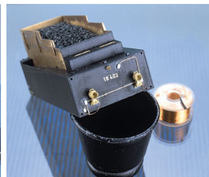
Auf der Rückseite des Tenders klebt man Stromzuführleitungen aus Messingdraht an.
