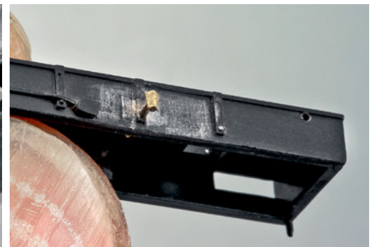
Am Kohlekasten wird die Öffnung für das überflüssige dritte Spitzenlicht mit Acrylit verschlossen und durch einen Lampenhalter ersetzt.
