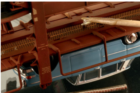
Die Magnete für die Fahrzeuge des oberen Decks werden sicherheitshalber mit einem Tröpfchen Kleber gesichert.
