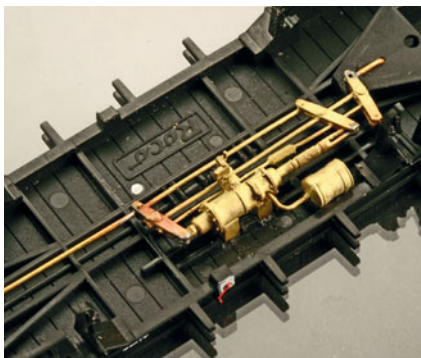
Der Roco-Bremsanlage des Handbremswagens fehlt das Steuerventil. Sie wird durch ein Weinert-Gussteil ersetzt. Die Lösezüge fehlen hier noch.
