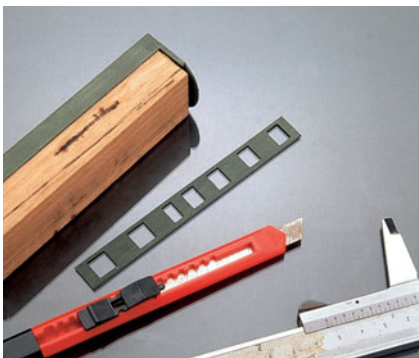
Das Fensterband trennt man 14 mm von der Kastenoberkante aus gemessen heraus.
