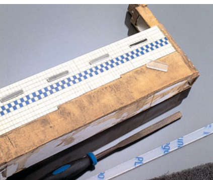
Die Lampenabdeckungen entstehen aus Plexiglasstreifen, welche in die Öffnungen eingepasst werden.
