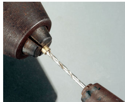
Kleine Drehteile wie zum Beispiel Buchsen oder Schollen lassen sich auch mit Hilfe einer Minibohrmaschine herstellen.
