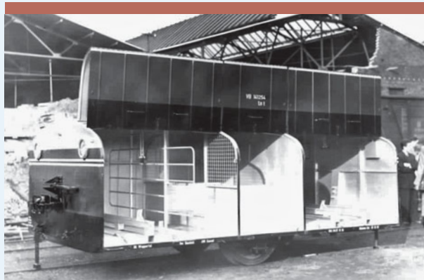
Die Innenaufteilung des VB 141: Links und rechts Stellplätze für insgesamt acht Fahrräder. In der Mitte wurden die Koffer untergebracht.
