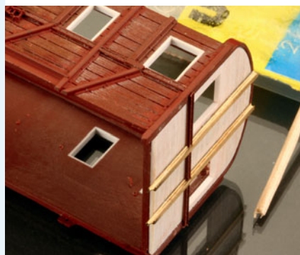
Die Stirnprofile sowie die Fensterrahmen sind verklebt. Gefräste H-Profile aus Messing 1x1 mm gibt es beispielsweise von Fohrmann.
