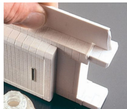
Eine selbstgefertigte Schablone hilft beim exakten Verkleben der Köpfe und Ziersimse an den Pfeilern der Unterführungen.
