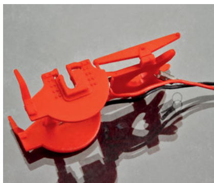
Bei den Vorlaufgestellen sitzt die Aufnahme der Achse zugunsten der Kurvengängigkeit 1 mm zu weit vorne.
