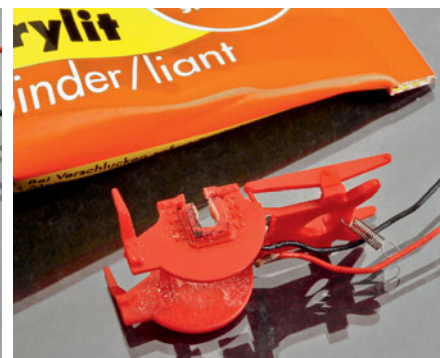
Gegenüber wird das nun fehlende Material mit UHU-Acrylit ergänzt und nach dem Aushärten vorsichtig in Form gefeilt.
