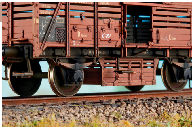
Positiv ins Auge fallen freistehende Wagenkastenstützen, nachträglich angepasste Achshalter und maßstäbliche Räder.
