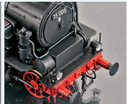
Die angegossenen Haltebügel der Weinert-Laternen kann man entfernen und durch 0,1-mm-Uhrmacherdraht ersetzen.
