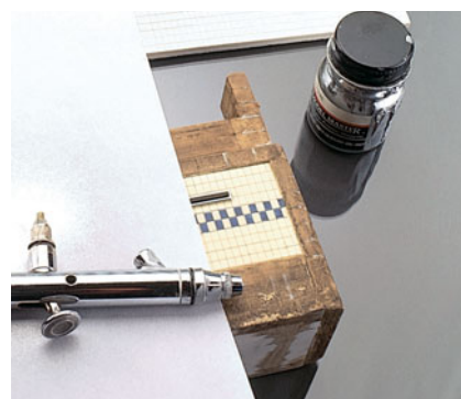
Beim Lackieren der Lampengehäuse ist eine Schablone aus Polystyrol hilfreich.
