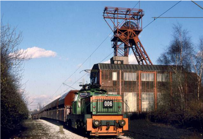
Lok 006 vom Typ E 1200 gehörte zu den allerersten in Serie gebauten Drehstromloks weltweit, die in enger Zusammenarbeit zwischen Henschel und der Zechenbahn in den 1970er-Jahren entwickelt wurden. Der erst 1987 elektrifizierte Streckenabschnitt bei Zollverein 10 gehörte mit einer Neigung von 1:20 als Folge von Bergsenkungen zu den steilsten Strecken weit und breit. Foto: Christoph Oboth
