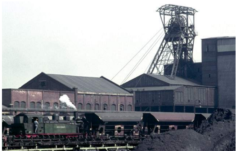
Rechts: Zeche Ickern in Castrop-Rauxel in den frühen 70er-Jahren. Der D-Kuppler vom Hohenzollern-Typ Heerlen sieht ausgesprochen altertümlich aus, wurde aber erst 1939 von der Firma Krupp, die den Lokomotivbau von Hohenzollern übernommen hatte, nachgebaut. Die Kohlenhalden im Vordergrund lassen nichts Gutes für die Zukunft der Zeche erahnen. Foto: Eduard Erdmann
