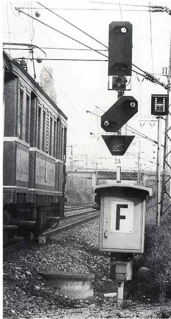
Abb. 5.4: Hauptsignal mit Geschwindigkeits-Voranzeiger für eine Abzweigung am nächsten Hauptsignal; außerdem getrennt aufgestellter Richtungs-Vor- anzeiger nach „H“
