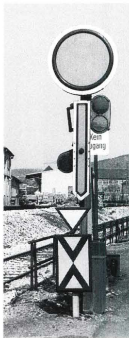
Abb. 3.3 (oben): Anordnung von Lichtsignalen bei verkürztem Bremsweg
