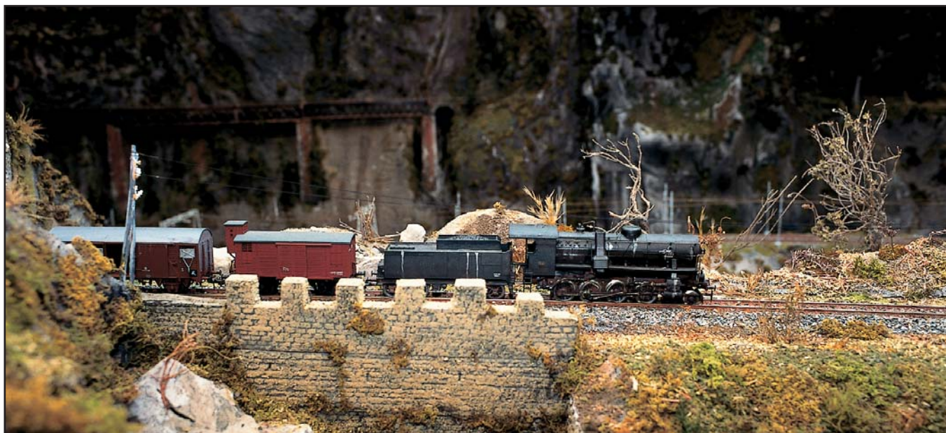
Typisch für die FS Italia waren die Kohle sparenden Franco-Crosti-Dampflokks mit seitlichem Schlot.
