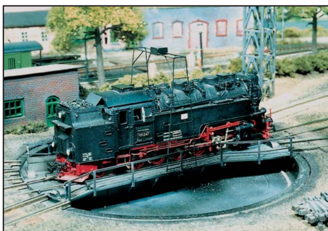
Im Schmalspur-Bw wird gerade die 1'E1'-Lok 99 247 auf der im Eigenbau entstandenen Drehscheibe gewendet.
