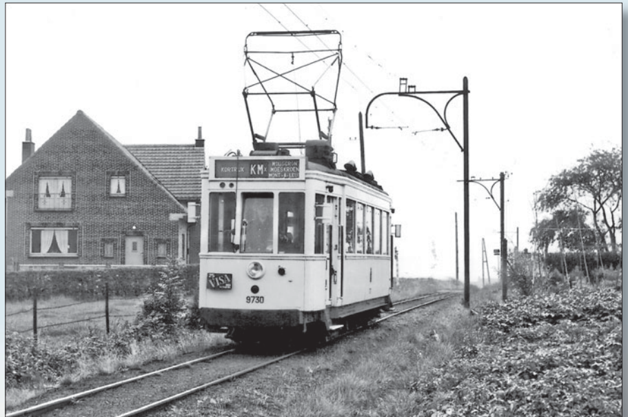
Schmalspurgleis, leichter Gleisoberbau und ländliche Szenerie – die „Verwandtschaft“ dieser Straßen- bzw. Überlandbahn unweit von Tombroek (Belgien) mit einer Kleinbahn ist nicht zu übersehen. Das Foto zeigt den Triebwagen 9730 der Straßenbahnlinie KMx im Juli 1958.
