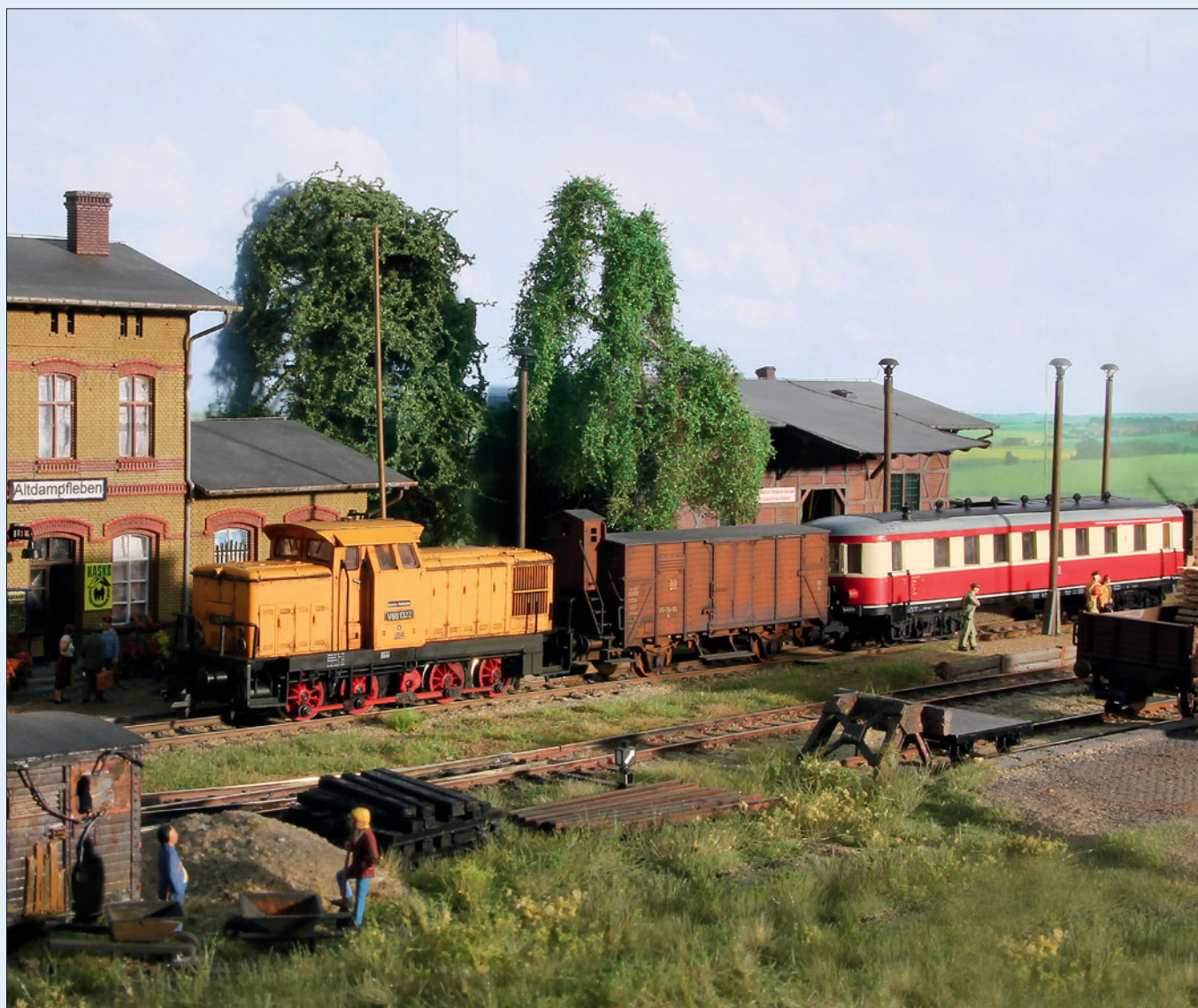
Oben: Der marode Charme und die eigentümliche Zugbildung weisen auf eine einstige Kleinbahn hin. Die V 60 (ohne Zugheizung) erforderte einen VT-Beiwagen mit Warmwasserumlaufheizung. Auch hier beweisen wieder Auhagen-Gebäude ihre Eignung für Kleinbahnmotive. Im Foto unten ein Reisezug mit Lok 91 1627 unterwegs nach Altdampfleben. Fotos: Helge Scholz
