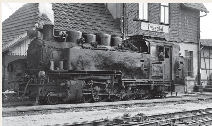
Für Sachsen typisch, in Thüringen fast ein Exot: 99 794 war die letzte von 24 Fünfkupplern, die von 1952 bis 1957 als Neubauloks aus Babelsberg an die Deutsche Reichsbahn gingen und zunächst nur für die 750-mm-Bahnen Sachsens gedacht waren. Foto: Detlef Hommel
