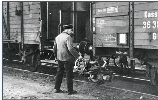
Der Einrad-Wagenschieber der ILO-Werke aus Pinneberg fand 1937 bei der Reichsbahn keine große Beachtung. Nach dem Krieg versuchte der Hersteller einen zweiten Anlauf auf der Deutschen Industrie-Messe 1954 in Hannover. Aber auch bei der DB kam der Wagenschieber nicht zum dauerhaften Einsatz. Foto: RVM, Archiv der Eisenbahnstiftung
