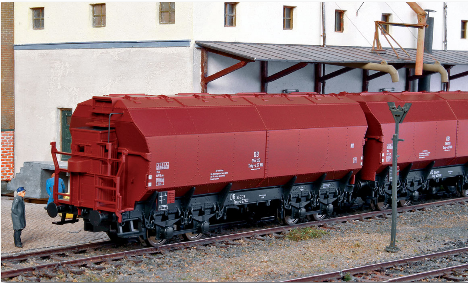
Für den Transport großer Getreidemengen entwickelte die DR den vierachsigen Behälterwagen Tadg-u-27 Kkt mit Klappdeckeln (H0-Modell von Fleischmann, jedoch in Epoche-III-Ausführung. H0-Anlage: Ton Janssen
