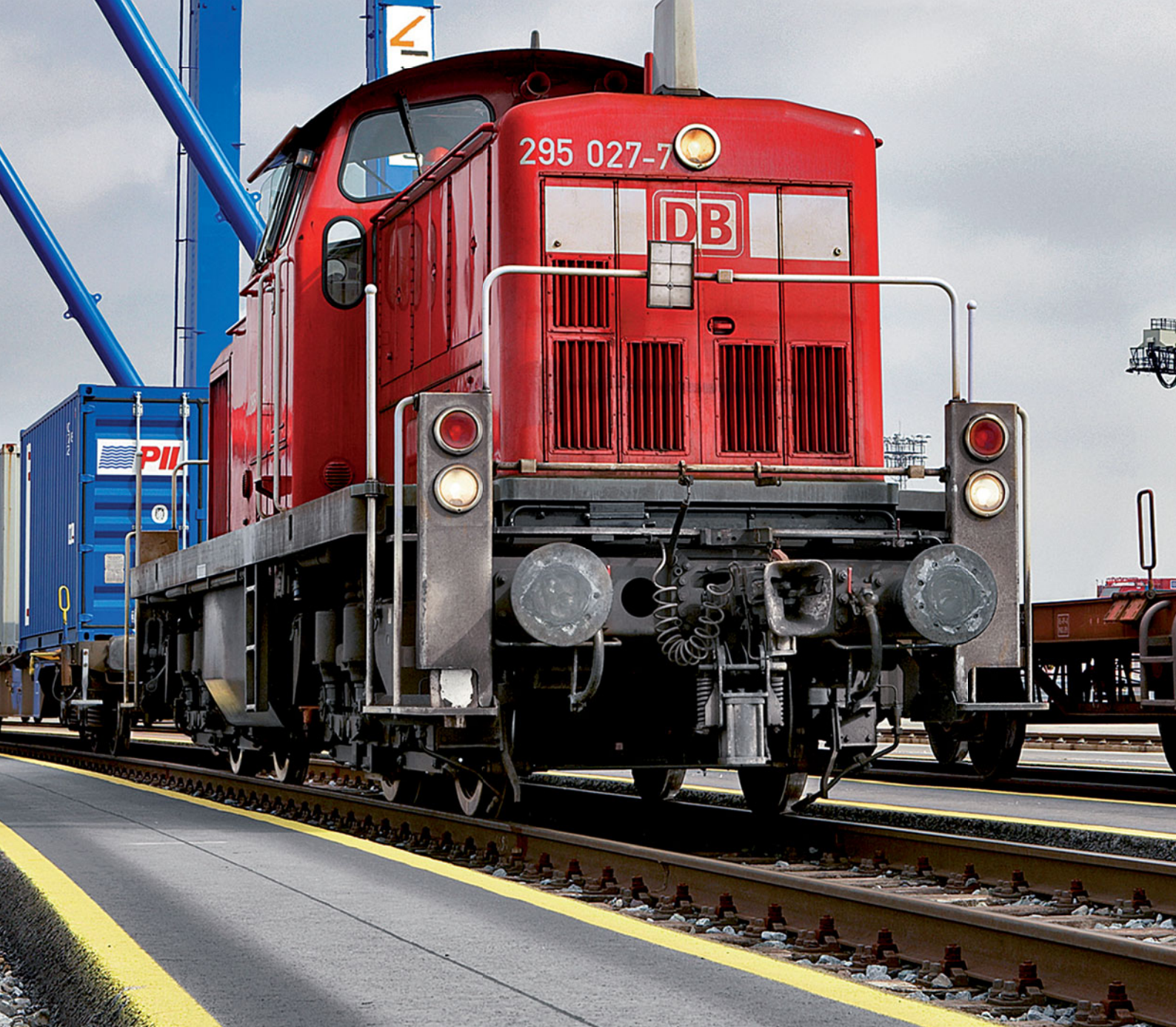
Mit Hilfe der in einem Geschirr am Bauch zu tragenden Funkfernsteuerung steuerte wie auf einer modernen Modellbahnanlage am 3. September 2008 der nunmehr ohne zusätzlichen Rangierer arbeitende Lokrangierführer die unbesetzte 295 027 mit Automatikkupplung im Containerbahnhof Tollerort im Hamburger Hafen. Foto: Hamburger Hafen und Logistik AG
