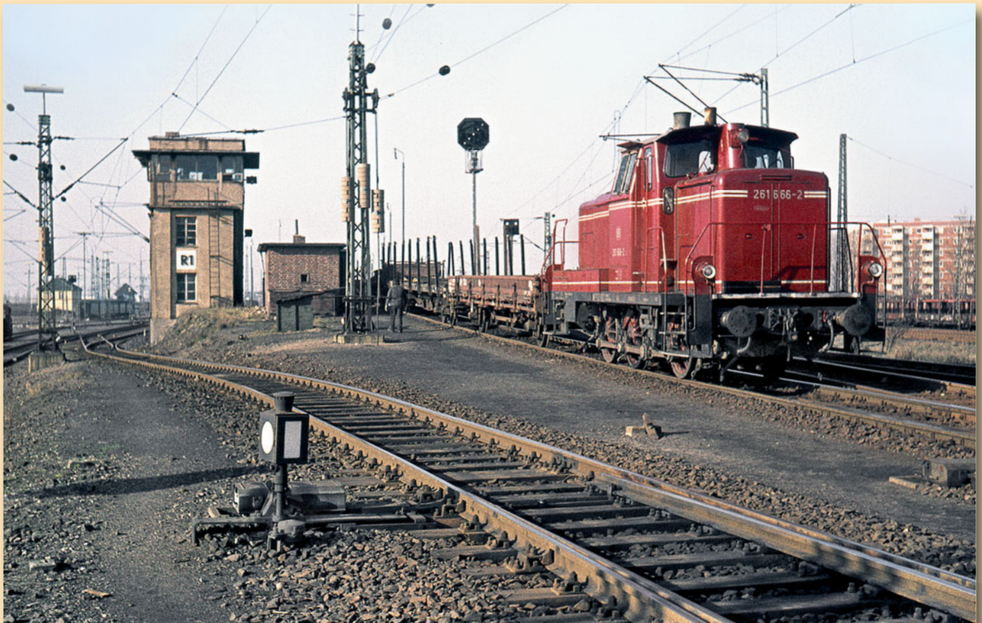
261 666-2 beim Abdrücken am Ablaufberg im Rangierbezirk II des Güterbahnhofs Köln-Nippes am 6. Februar 1975. Das Lichtsignal gibt gerade den Auftrag (Ra7), langsam den Zug zu bewegen, um die Wagen abzudrücken. Foto: Peter Schiffer, Archiv der Eisenbahnstiftung
