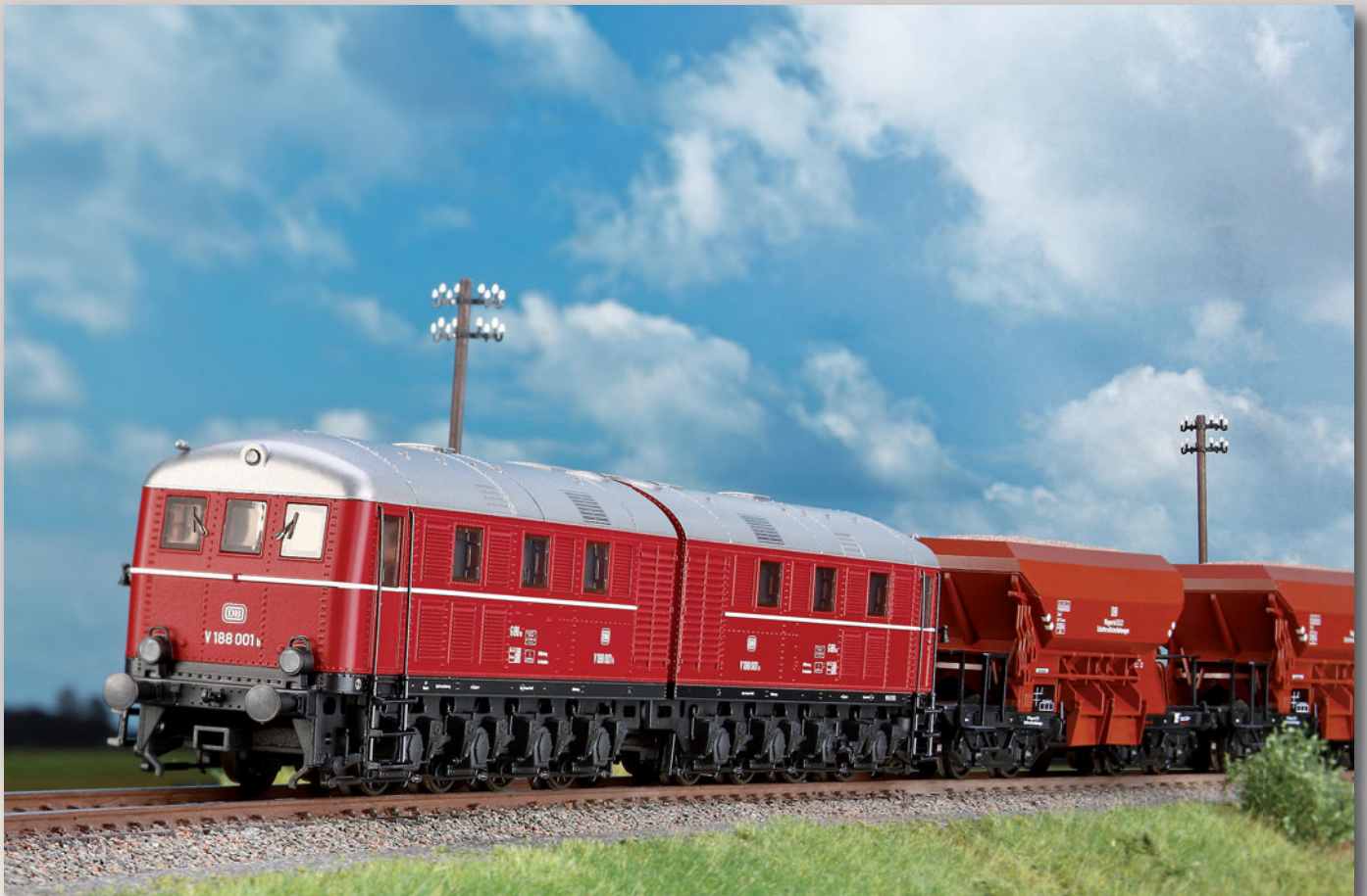
Die Großdiesellokomotive V 188 entstand 1939 auf Wunsch der Wehrmacht und konnte bei der jungen DB bis 1971 beweisen, welche Vorteile eine kraftvolle Diesellok gegenüber einer Dampflok im Güterverkehr hat. Sie war damit prägend für die weitere Diesellokentwicklung im Westen (H0-Modell von Märklin im Betriebszustand von 1964).
