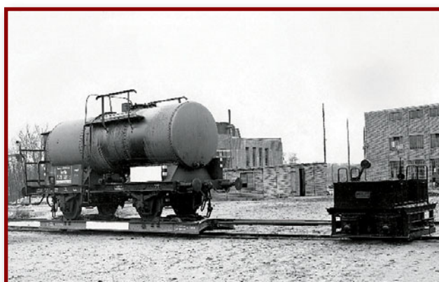
1934 setzte man versuchsweise einen Schmalspur-Schientraktor zum Befördern von Güterwagen in industriellen Gleisanschlüssen ein. Foto: Archiv der Eisenbahnstiftung
