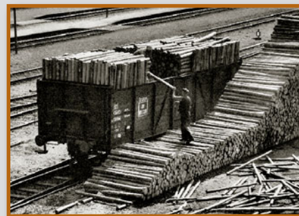
Noch bis weit in die Epoche III hinein verlud man Grubenholz für Zechen mit der Hand, denn so konnte man in offenen Güterwagen die Ladung vorschriftsgemäß verstauen. Foto: Archiv der Eisenbahnstiftung
