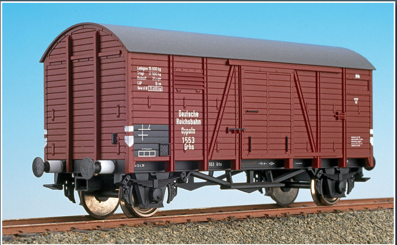
Dieser Güterwagen, ein Ghs, auch Oppeln genannt, war der erste geschweißte Wagen der neuen Verbandsbauart. Er erhielt standardgemäß ein Tonnendach und wurde ab 1934 gefertigt (H0-Modell von Liliput).
