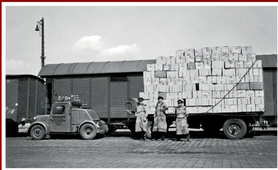
Der Primus-P30-Schlepper mit einem 2-Zylinder-Deutz-A2M414-Dieselmotor war 1936 noch neu und diente in einem Berliner Güterbahnhof als Pferdeersatz und zeigte, welche Lasten er mit 22 PS zu schleppen vermochte.
