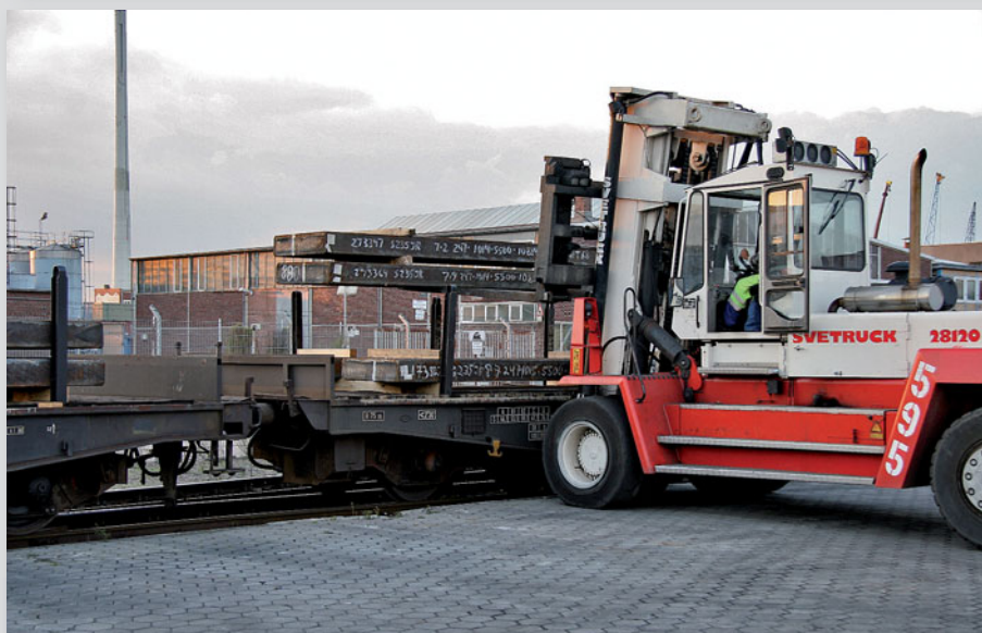
Kräftige Gabelstapler sind seit der Epoche IV eine Alternative zu Kränen. Hier werden Stahlbrammen aus Schwerlastwagen entnommen. Foto: Thomas Memm
