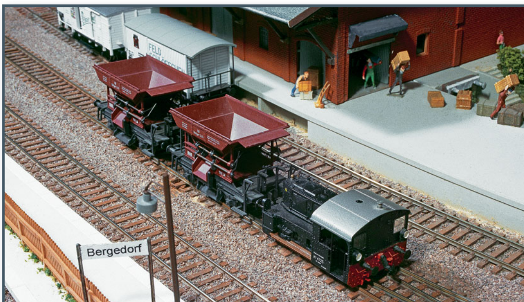
Die kurzen Talbot-Schüttgutwagen erleichterten der DRG beim Gleisbau das Entladen von Schotter (H0-Modell von Fleischmann). H0-Anlage: Bergedorfer EF
