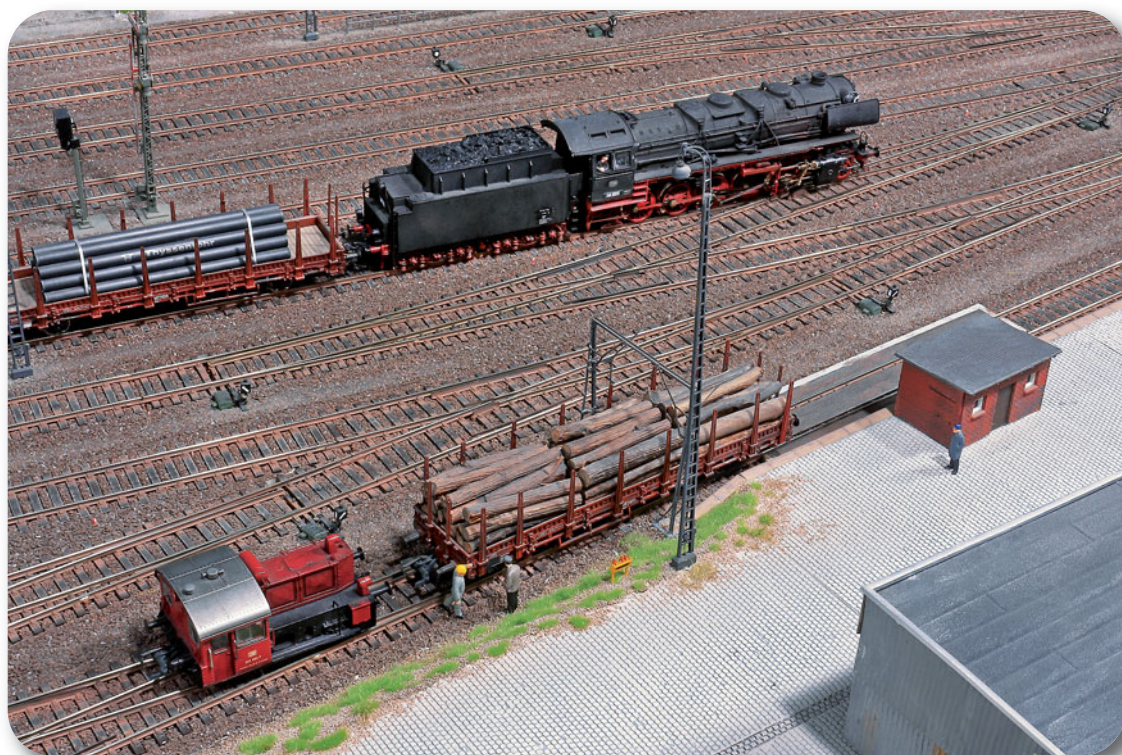
Gleiswaage und Lademaß sind typische Ausstattungsteile an einer Ladestraße. Damit lassen sich die Beladungen der Güterwagen kontrollieren, ob sie ordnungsgemäß für den Bahnbetrieb ausgeführt worden sind. H0-Anlage: Modellbundesbahn in Bad Driburg
