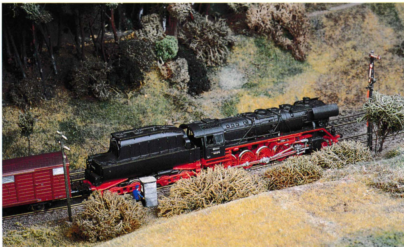
Kleine Telefonhäuschen finden sich auf freier Strecke in der Regel vor Signalen, damit bei Störungen oder sehr langen Wartezeiten das Zugpersonal Informationen mit dem nächsten Stellwerk austauschen kann. In der heutigen Zeit übernimmt der Zugfunk diese Aufgabe. Die Telefone gibt es aber immer noch - sicher ist sicher.
