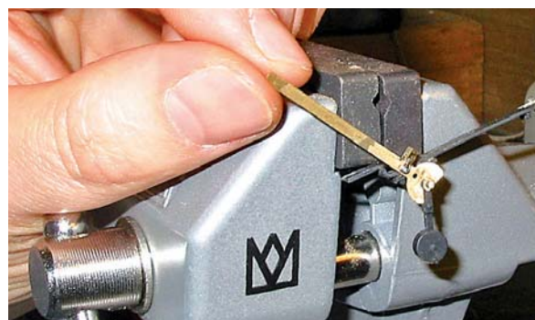
Ein Weinert 0-Weichenhebel (Wei-O-Wei) bekommt von Rainer einen langen Stellfinger zur Betätigung des Microschalters verpasst.
