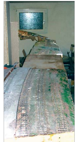
Versuchsaufbau des Bahnhofes Oderteich. Die Wiederverwendung zweier Teile des alten Bahnhofs Schlufft erwies sich zumindest hinsichtlich des Mittelstücks als nicht optimal. Die Gleise mussten nachträglich mit großem Aufwand gestreckt werden.
