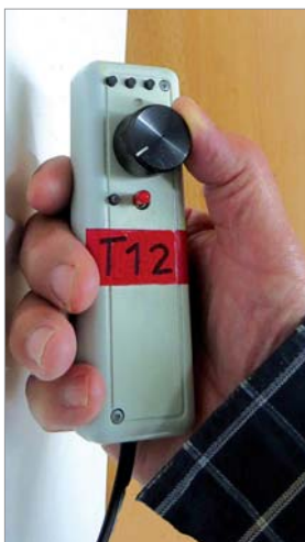
Der FRED-Regler in der originalen FREMO-Version mit Nullanschlag des Reglerknopfes und Richtungumschaltung per Kippschalter ist gut einhändig zu bedienen und damit auch als Rangierregler bestens geeignet.
