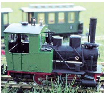
Eine entastrifizierte LGB STAINZ war mein erster Triebfahrzeugumbau. Ovale Führerhausfenster, niedrigerer Dampfdom, Ramsbottom-Sicherheitsventil sowie Körting-Schalldämpfer etc. haben das Gesicht der Lok verändert.
