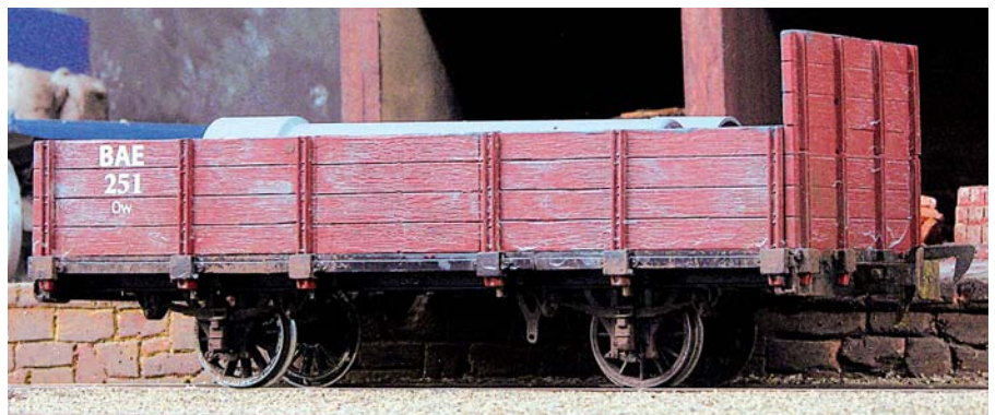
Hier einer der aus Oa-Wagen umgefrokelten Ow-Wagen der BAE mit (umgerechnet) 3 m Achsstand und auf 0m umgeachsten 16-mm-Romford-Rädern. Kein bestimmtes Vorbild, aber ein stimmiger, generischer Meterspur-Güterwagen.
