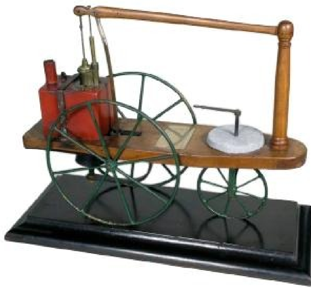
Miniatur-Dampflokomotive mit funktionierendem Antrieb, erbaut von William Murdock im Jahre 1784.
