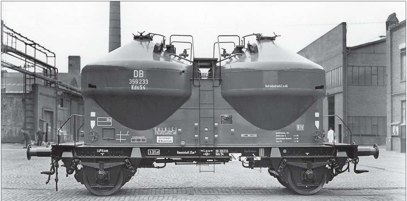
In seiner ursprünglichen Farbgebung sehen wir hier den Staubbehälterwagen Kds 54 der DB mit seinem eisengrauen Anstrich an den Behältern einschließlich der Sattel. Das Untergestell ist schwarz lackiert. Die Anschriften sind weiß, nur die Bremsanschriften haben rote Farbe. (Werkfoto 1955 Aachen)
