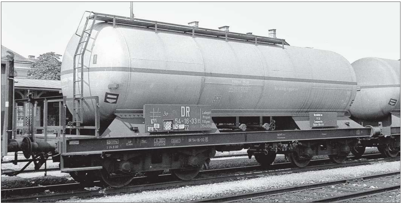
Druckgaskesselwagen DR 54-16-33 ZZ, vermietet an VEB Leunawerke Walter Ulbricht, Ladegut Propan, roter Erkennungstreifen in Kesselmitte (Foto 1960, Sammlung Hermann Heless)
