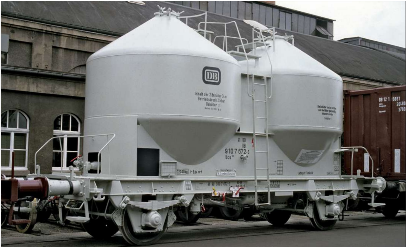
Ganz in Kieselgrau zeigt sich dieser Ucs 909 mit der Nummer 41 80 910 7 672-3, lediglich die Radsätze sind graubraun angestrichen. Die Anschriften haben ebenfalls graubraune, der Blitzpfeil rote Farbe. Die Schilder der Bremsumsteller sind weiß mit rotem Rand, die Umstellhebel rot (leer-beladen, Bremse ein-aus) und gelb (Zugart G-P). (Foto Paderborn 1988 Hans Ulrich Diener)
