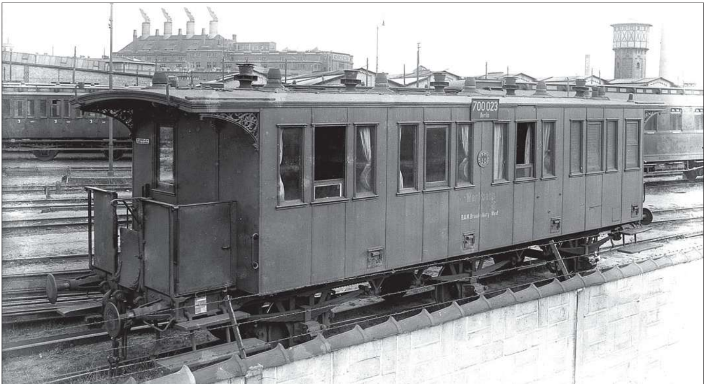
Dieses rare Bild zeigt einen Wagen der Werkbahn des RAW Brandenburg West für die Beförderung der Arbeiter. Als Bahndienstwagen der Personenwagenbauart hat er braungrünen Anstrich am Wagenkasten. (Foto um 1930, Sammlung Hermann Hoyer)
