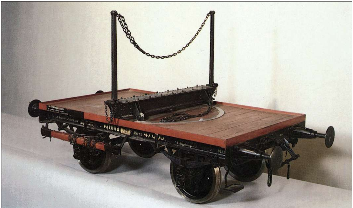
Das Modell des Schemelwagenpaares HHrsz 47 000 ist nach den preußischen Vorschriften von 1905 lackiert und beschriftet. Bemerkenswert ist hier der rotbraune Anstrich der oberen Längsrahmen, der Bodenstirnrahmen und der Kuppelstange. Alles andere ist schwarz gestrichen, die Anschriften haben weiße Farbe. (Foto Deutsches Technikmuseum Berlin)
