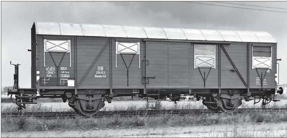
Die Regelschriften eines gedeckten Bundesbahn-Güterwagens sind auf diesem Bild des Gültels 50 gut zu erkennen. (Werkfoto 1954 Braunschweig)
