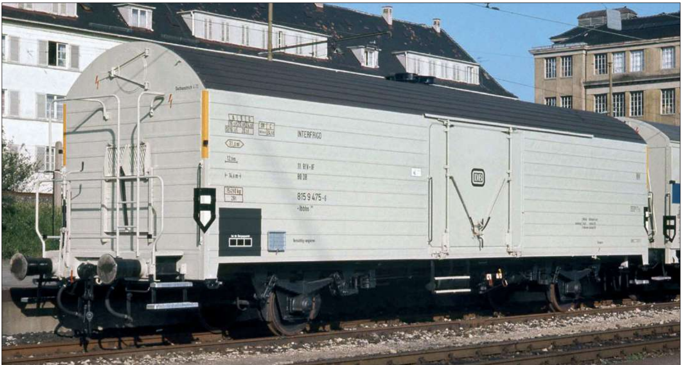
Mit kieselgrauem Anstrich wurde dieser Kühlwagen 11 80 815 9 475-6 der Deutschen Bundesbahn (Ibbhs 398) aufgenommen. An den Eckprofilen befinden sich oben gelbe Markierungen, die auf einen Wert der Wärmedurchgangsziffer unter 0,4 hinweisen. (Foto Untertürkheim 1972 Fritz Willke)
