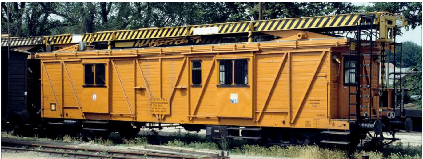
Fahrleitungsmontagewagen DR 80 50 981 2715-4 mit orangegelbem Anstrich (Foto Wiesenburg 1992 Hans Ulrich Diener)
