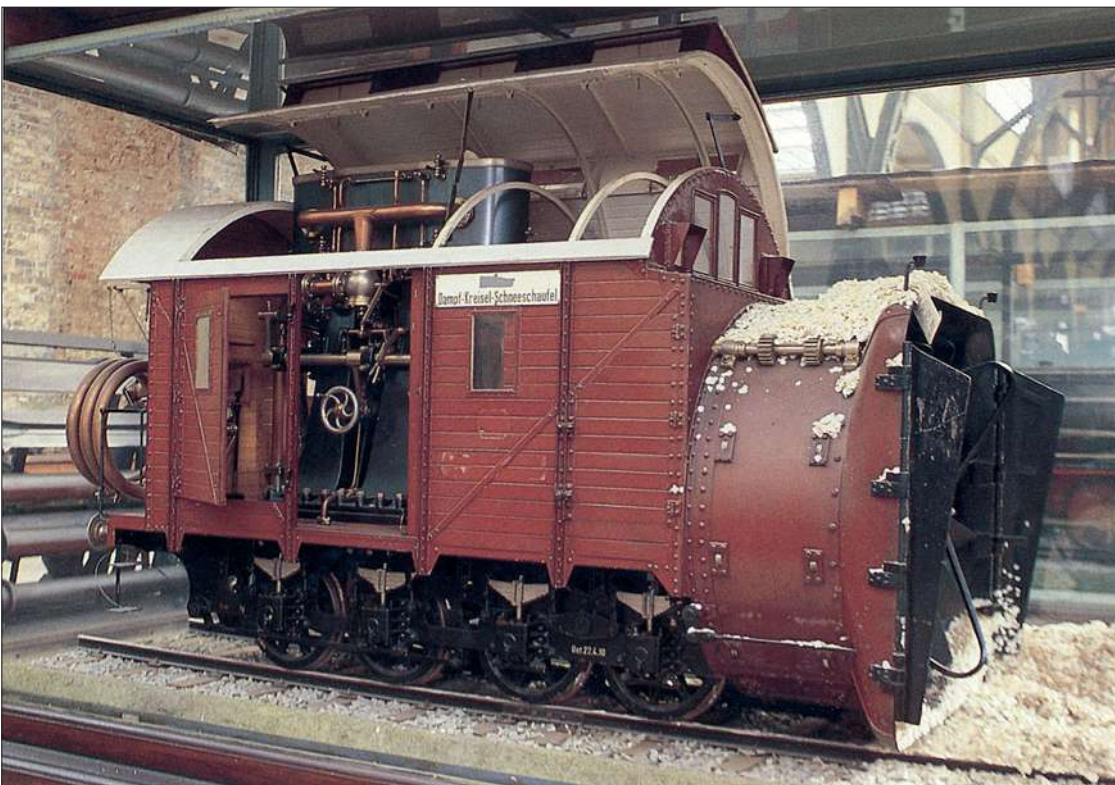
Das 1:5-Modell der „Dampf-Kreisel-Schneeschaufel“ System Rotary Breslau 3001 von Görlitz aus dem Jahre 1910 zeigt den in Preußen für Bahndienstwagen der Güterwagenbauart üblichen rotbraunen Außenanstrich an Wagenkasten und Schleudergehäuse, Fahrzeugrahmen sowie stirnseitige Führungsklappen sind schwarz, das Dach zeigt den hellen Anstrich. (Foto Sammlung Silberstreif Verlag Berlin)
