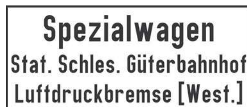
Anschrift für beheimatete Spezialwagen mit Druckluftbremse (Beispiel 1:10)
