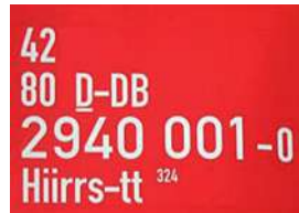
Anschriftenfeld an der Einheit aus zwei gedeckten Wagen Hiirrs-tt 324, 42 80 2940 001-0 nach den seit 2004 gültigen Regeln mit Landes- und Einstellercode (Foto 2006 Roeland de Jong)
