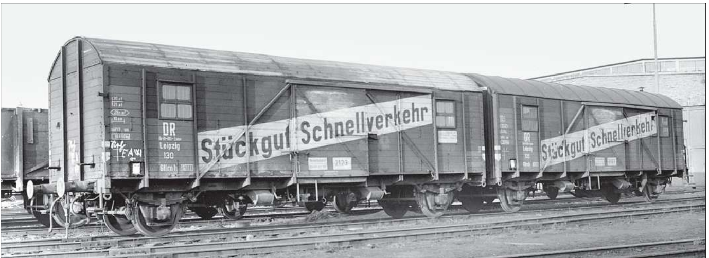
Die spätere Variante für die Kennzeichnung der Leigeinheiten in Form einer diagonalen Aufschrift über die Wagenseitenwand tragen die Wagen Leipzig 106 + 130 Gllmhs. (Foto Osnabrück 1949 Rudolf Klitscher)
