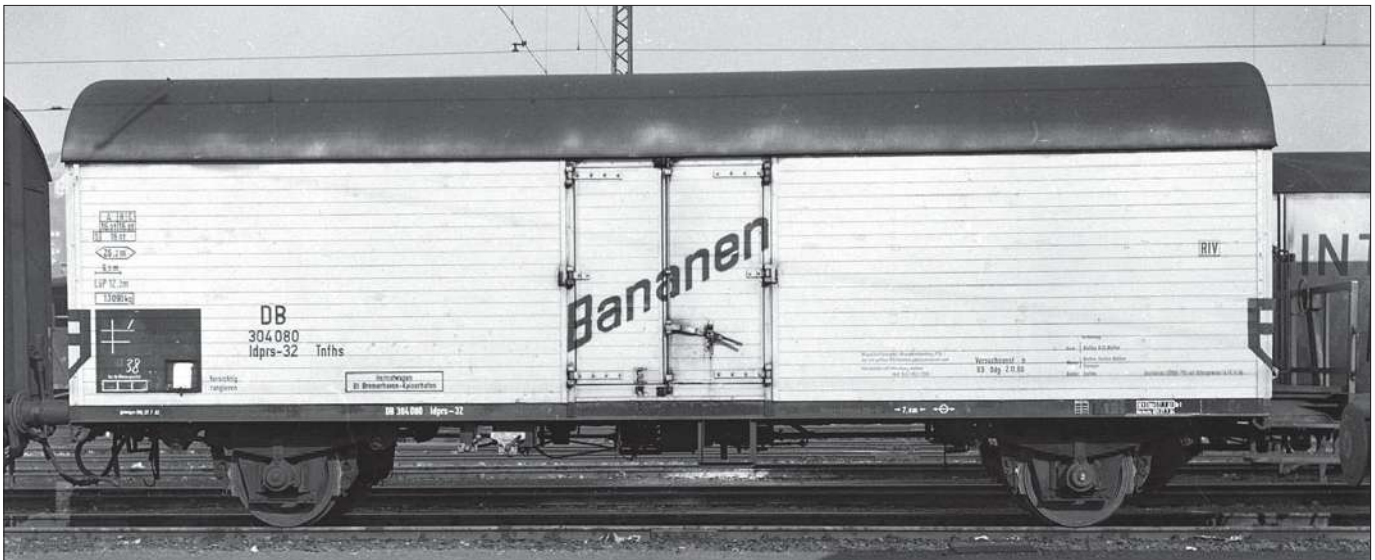
Ein weiteres Beispiel für die Bezeichnung der DB-Güterwagen ab 1960 zeigt dieses Bild des Idprs-32 (ehemals Tnfhs 32). Die Bananenwagen der Deutschen Bundesbahn waren zudem durch den diagonalen Schriftzug „Bananen“ in schwarzer Farbe über die Türen weithin sichtbar gekennzeichnet. Dieser 1962 fotografierte Wagen ist ebenfalls bereits mit dem international vereinbarten Gattungszeichen Idprs bezeichnet. (Foto Stuttgart 1962 Fritz Willke)
