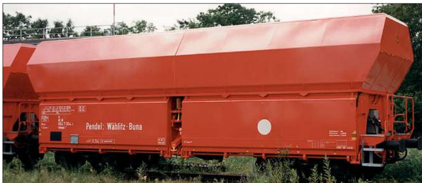
Einer der ersten Güterwagen in der Farbgebung der DB AG mit verkehrsrotem Aufbau und schwarzem Untergestell, noch ohne DBAG-Zeichen, war der 82 80 664 7 004-2 Falnqq 130. (Foto Niesky Juni 1995)
