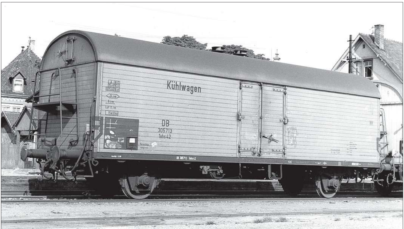
Vom 13. Oktober 1961 stammt dieses Bild des Tehs 42 der Deutschen Bundesbahn. Zu diesem Zeitpunkt waren die Kühlwagen grauweiß gestrichen, das Untergestell einschließlich der außenliegenden Langträger weist schwarze Farbe auf. Das Dach ist weißaluminium, auf diesem Foto wirkt es allerdings bereits recht grau. Die Anschriften am Wagenkasten sind einschließlich des Schriftzuges „Kühlwagen“ schwarz, am Langträger weiß bzw. rot. (Foto Wiesloch 1961 Joachim Claus)
