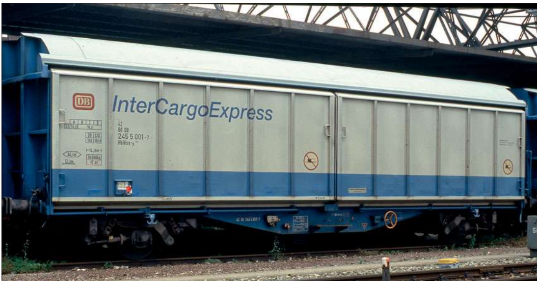
Für die Schnellfahrstrecke Hannover-Würzburg beschaffte die DB Schiebewandwagen mit einem Sonderanstrich in Fenstergrau, Lichtgrau und Himmelblau am Wagenkasten. (Foto München 1989 Hans Ulrich Diener)
