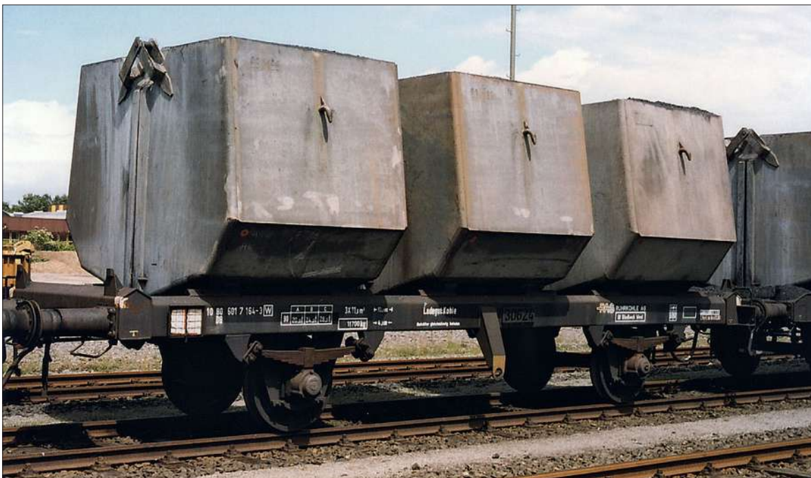
Kübelwagen DB 10 80 601 7 164-3 der Ruhmkohle AG mit dem Kennzeichen W für Werkwagen (Foto Duisburg-Ruhrort 2003 Thomas Losh)
