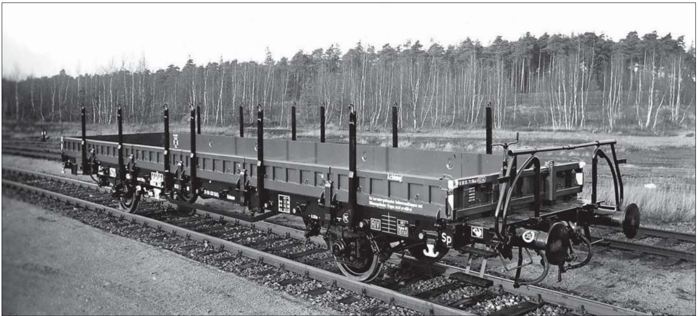
Hier sehen wir den Rungenwagen Ralmms 21-50-333 1560-1 mit Kastenwänden aus Stahlblech. Diese sind außen und innen rotbraun gestrichen, die Stahlungen sowie das Untergestell sind schwarz. (Werkfoto 1969 Niesky, Sammlung Harald Westermann)
