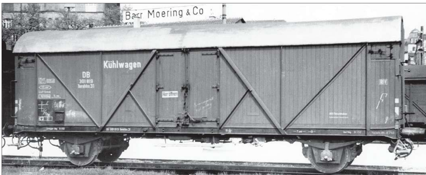
Betongrauen Anstrich erhielten die Kühlwagen der Deutschen Reichsbahn ab 1943. Dieser Anstrich hielt sich bis zu Beginn der fünfziger Jahre, wie man diesem Bild des Tnehhs 31 mit den weißen Anschriften und den Bremskennzeichen ohne schwarze Einfassung entnehmen kann. (Foto Fritz Willke; dieses und alle weiteren Fotos von Fritz Willke stammen aus der Sammlung Stefan Carstens.)
