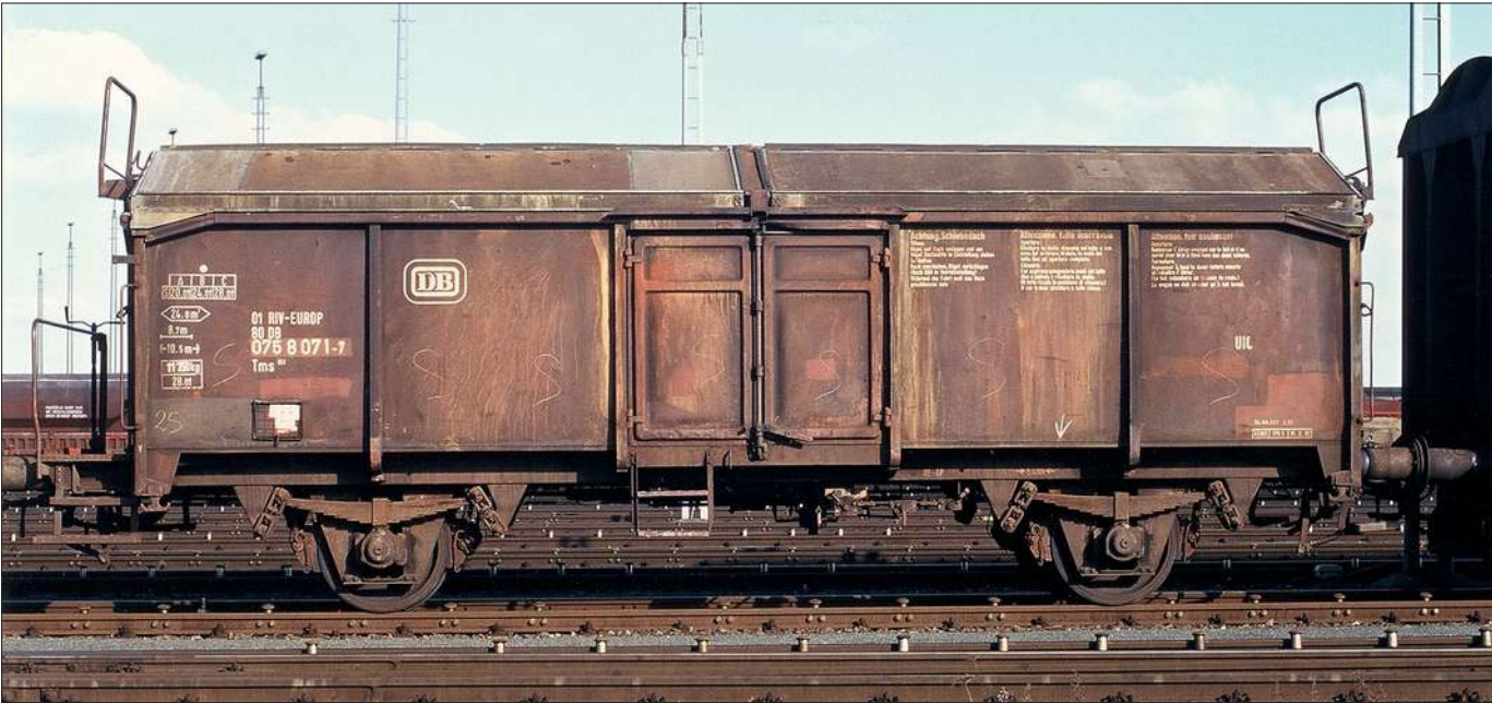
Der Schiebedachwagen Tms 851 DB 01 80 075 8 071-7 wurde 1997 aufgenommen, zeigte aber noch die Anschriften, wie sie ab 1980 vorgeschrieben waren. Gut zu sehen sind die umfangreichen, mehrsprachigen Bedienungshinweise rechts unter dem Dach. (Foto Nürnberg 1997 Hans Ulrich Diener)
