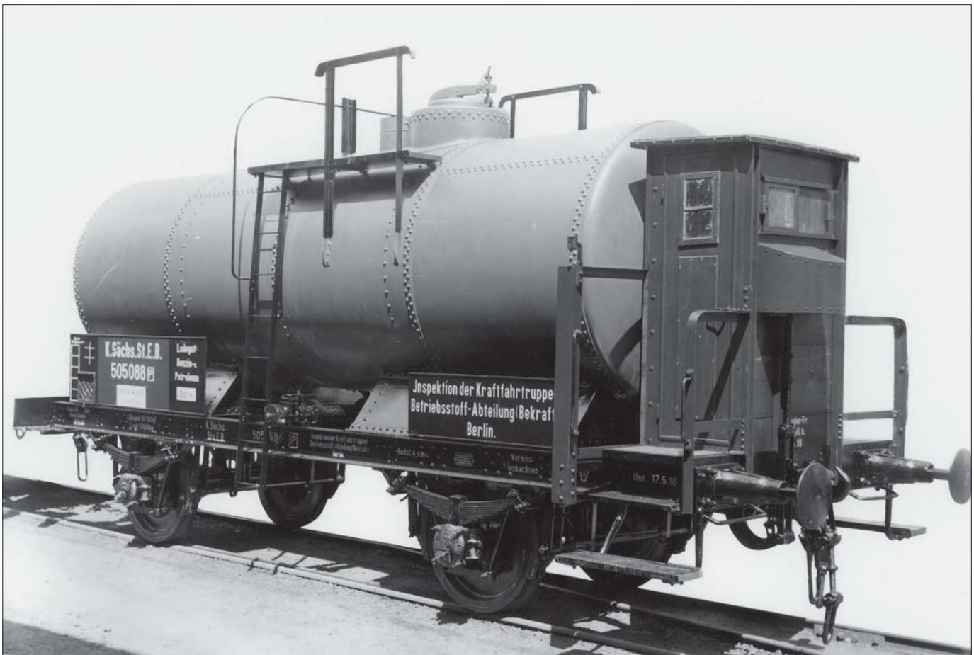
Mineralölkesselwagen Sachsen 505 088 der Inspektion der Kraftfahrtruppen, Betriebsstoff-Abteilung (Bekraft) Berlin (Werkfoto 1918 Görlitz)
