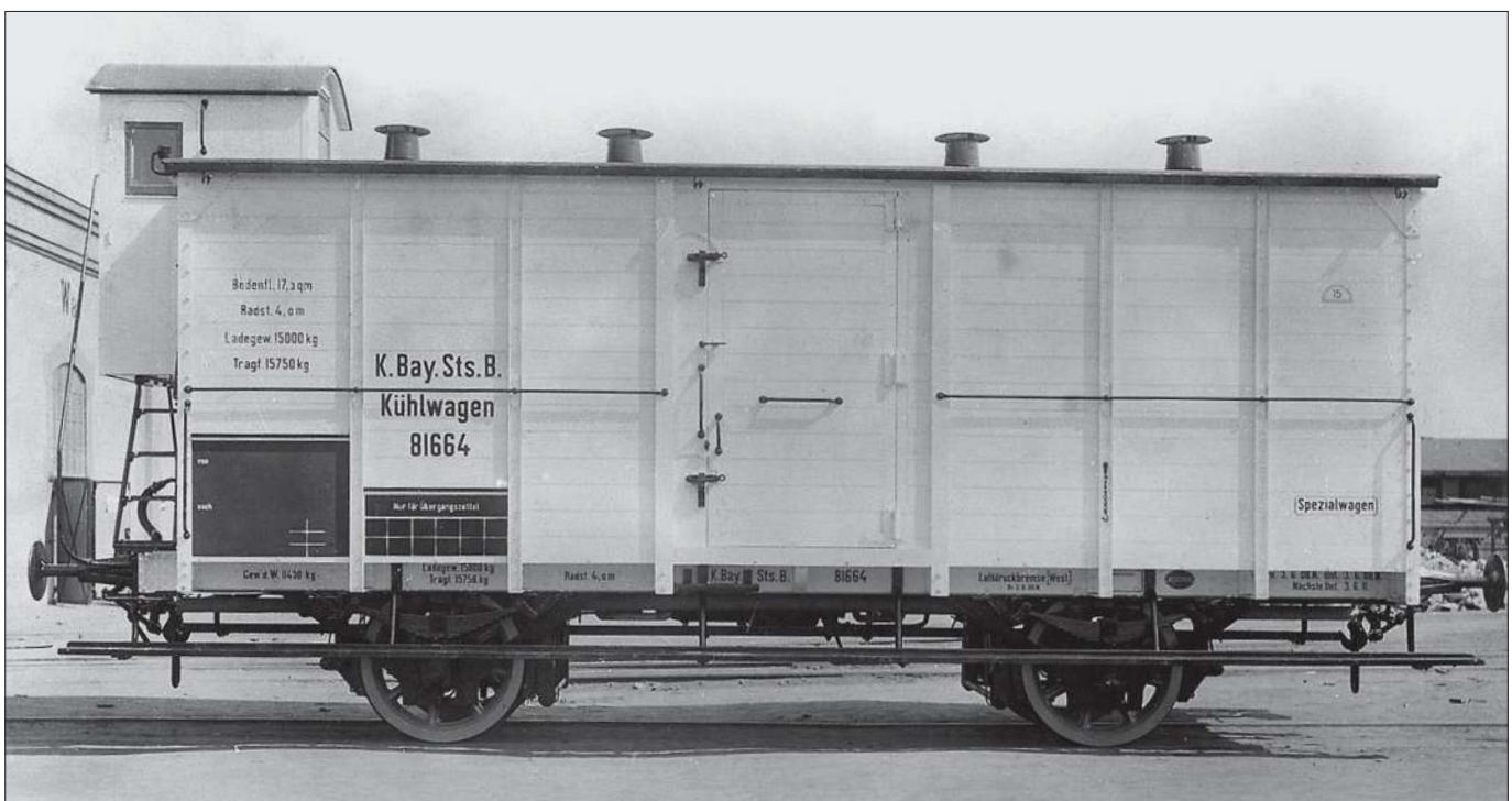
Einen weiteren Beleg für den weißen Anstrich der Kühlwagen liefert dieses Foto des 1908 an die bayerischen Staatseisenbahnen gelieferten Kühlwagens. Im Gegensatz zu den preußischen Wärmeschutzwagen waren in Bayern auch die Außenseiten der Langträger und der Kopfschwellen weiß gestrichen. Gut zu erkennen ist auch der schwarze Anstrich der Handgriffe und Handstangen, der Leitern und Puffer sowie des Untergestells. Die Radsätze sind grau. (Werkfoto 1908 Nürnberg)
