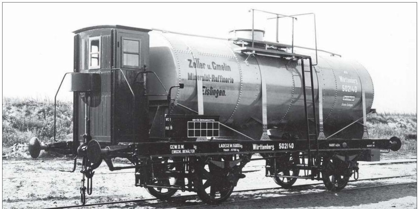
Mineralölkesselwagen Württemberg 502 140 von Zeller und Gmelin, Mine- ralöl-Raffinerie Eislingen; das Zeichen für Privatgüterwagen ist noch nicht angebracht. (Werkfoto 1907 Nürnberg)
