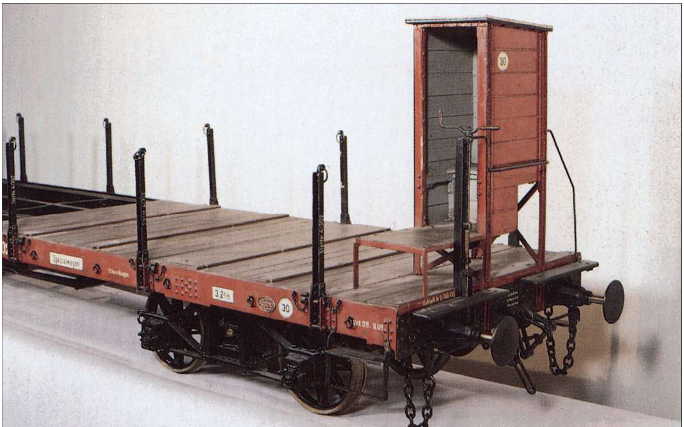
Der Schienenwagen Stettin 41302 SSml wird ebenfalls als Modell im Museum für Verkehr und Technik gezeigt. Anstrich und Anschriften entsprechen wieder den preußischen Vorschriften von 1905: Untergestell einschließlich Anbauteilen, Rungen, Drehgestelle und lotrechte Kanten des Bremserhauses schwarz, Außenflächen der Langträger und Bodenwinkelrahmen sowie Bremserhaus außen rotbraun, Bremserhaus innen perlgrau, Anschriften weiß. (Foto Deutsches Technikmuseum Berlin)
