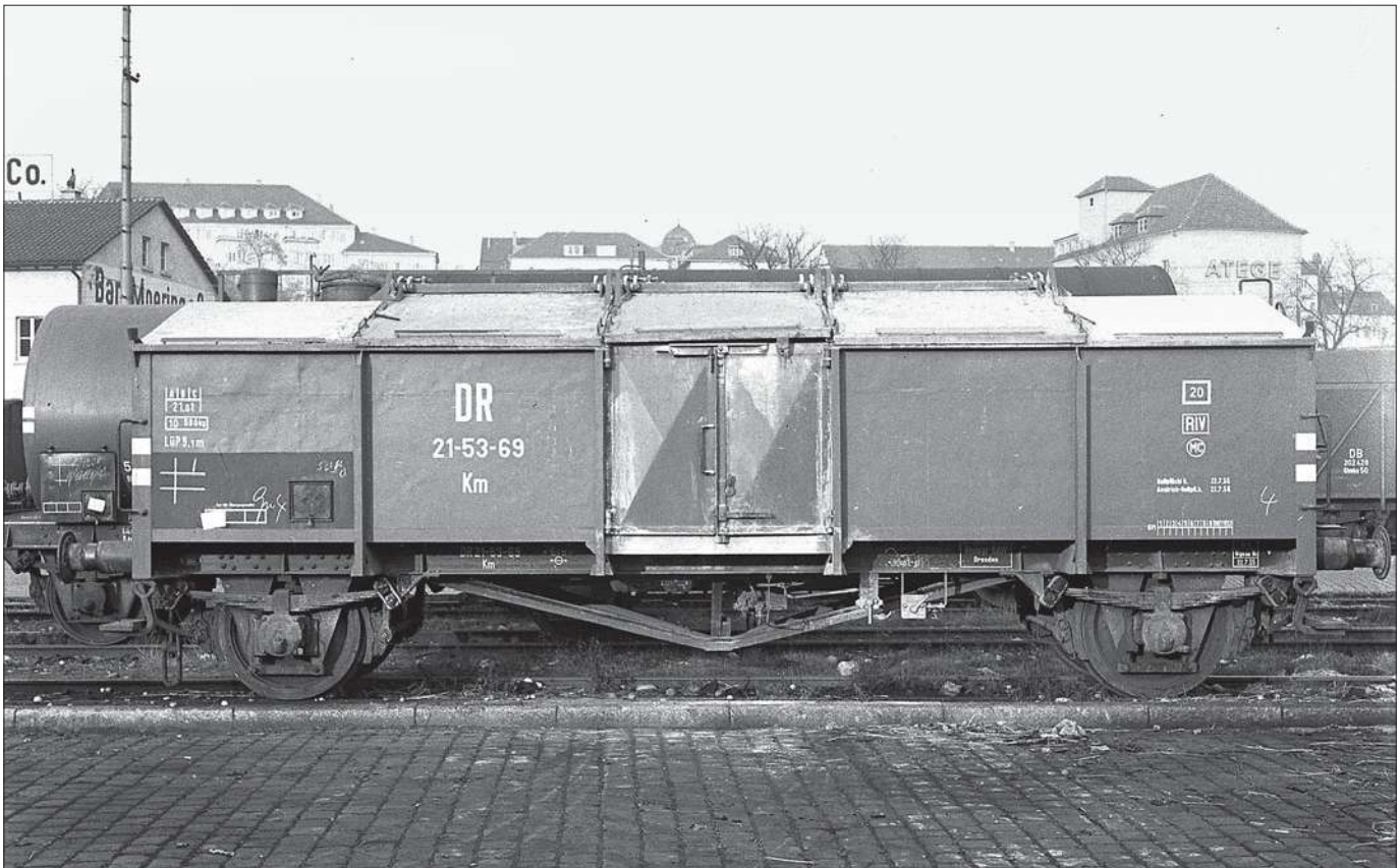
Die Güterwagen der Deutschen Reichsbahn in der DDR wurden 1951 mit neuen Wagennummern beschriftet, die sich aus drei zweistelligen Zahlen, getrennt durch Bindestriche, zusammensetzten. Dieses Bild zeigt einen Klappdeckelwagen der Bauart Km-21 mit den entsprechenden Anschriften. (Foto Stuttgart 1955 Fritz Willke)
