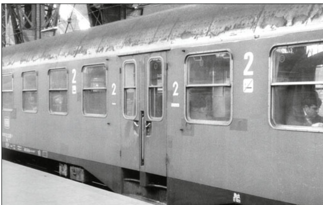
Eilzugwagen DB Byl 421 (Foto Frankfurt [Main] 1980/81 Klaus Gerke) Dieser Wagen zeigt in der Übergangsphase sowohl die älteren als auch die neueren Klassenziffern von 1956 bzw. 1978 sowie die Bezeichnung der Nichtraucher- und Raucherabteile mit Anschriften- bzw. Bildzeichen-Aufklebern.
