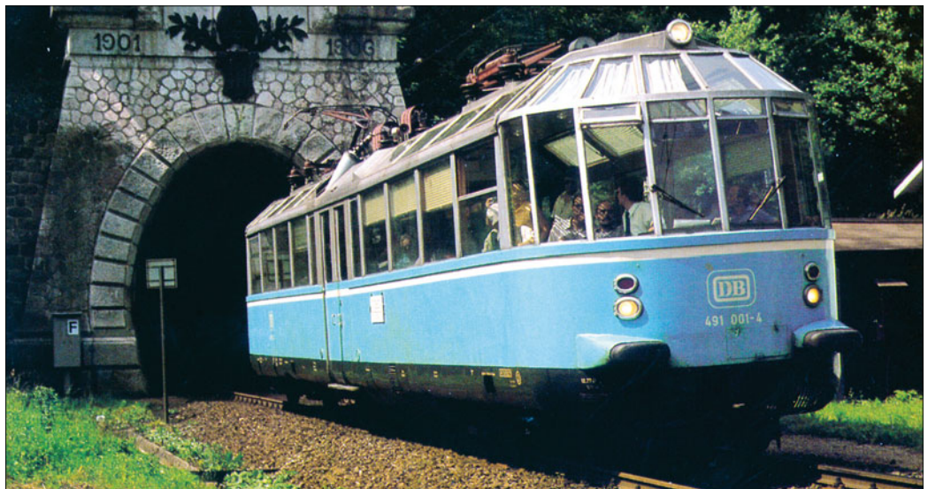
Aussichtstriebwagen DB 491 001-4; Dach, Dachvouten und Fensterband weißaluminium, Wagenkasten hellblau, Zierstreifen cremeweiß, Langträgerverkleidung und Schürzen schwarzgrau (Foto 1984 H. u. H. Urselmann/Reiju)
