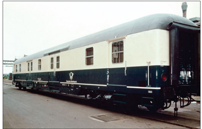
Bahnpostwagen DBP 50 80 00-33 415-3 Postmr-ap/26; Dach umbragrau, Wagenkasten und Langträgerverkleidung ozeanblau, Fensterband und Zierstreifen elfenbein, Posthorn von 1951 und Schrift „Deutsche Bundespost“ in Helvetica elfenbein (Werkfoto 1978 Sammlung DBP)
