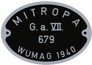
Eigentumsschild für Mitropa-Drehgestelle, hier für den Speisewagen WR4ü 1189 (Rekonstruktion)
