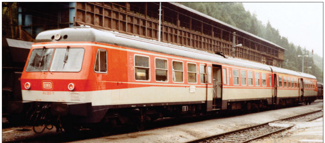
Verbrennungstriebwagen DB 614 023-0; Dach umbragrau, Wagenkasten reinorange und kieselgrau, Langträgerverkleidung und Rahmen schwarz (Foto Erzberg 1984 Richard Schatz)
