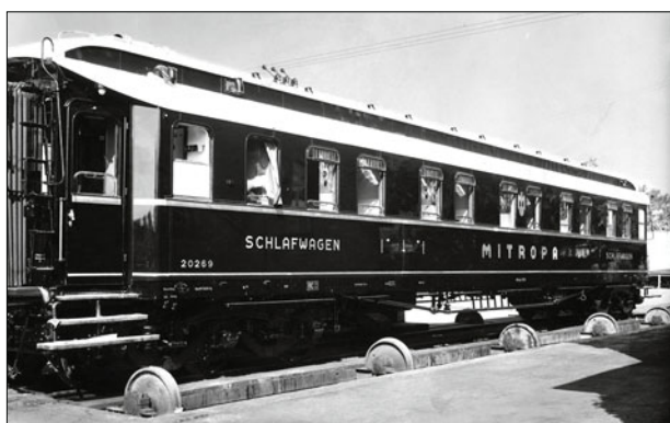
Schlafwagen Mitropa 20269 WLAB6ü (Werkfoto 1930 Falkensee) Bordeauxrot lackiert waren die Wagen der Mitropa ab 1927. Die Farbe der Deckschienen und Absetzlinien sowie der Anschriften am Wagenkasten war reichgold, die des Langträgers schwarz und die der dortigen Anschriften gelb. Das Dach scheint noch in herkömmlicher Weise mit Bleiweißfarbe gestrichen zu sein. In Wagenmitte sehen wir in Fensterhöhe das Emblem der Mitropa, darunter den Schriftzug MITROPA, der ebenso wie die Anschrift SCHLAFWAGEN in der für die Mitropa typischen Schriftart von Schulpig ausgeführt ist. Die Wagennummern befinden sich an der Unterkante des Wagenkastens neben den Einstiegstüren.
