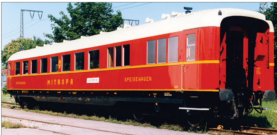
Ein vom ISG/DSG-Werk Neubaunig vorbildlich restaurierter Speisewagen der Mitropa, der äußerlich soweit wie möglich in sein Erscheinungsbild zur Zeit der Lieferung versetzt worden ist; die technische Ausstattung (Klimaanlage, Kücheneinrichtung) entspricht heutigen Ansprüchen (Foto Neubaunig 1992 Thomas Landwehr)
