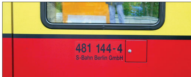
Eigentumszeichen und Betriebsnummer an einem Triebwagen der Berliner S-Bahn (Foto Berlin 2007)
