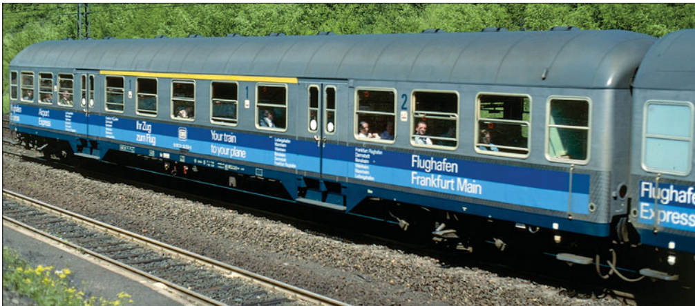
Nahverkehrswagen ABnb 703; Dach umbragrau, Wagenkasten oben blank, unten dunkel- bzw. hellblau, Langträgerverkleidung ozeanblau (Foto Darmstadt 1979 Hans Ulrich Diener)
