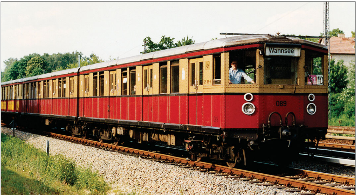
S-Bahn-Triebwagen BVG 475 089-9; Dach fehgrau, Wagenkasten rubinrot, Fensterband ockergelb, Brüstungsleisten, Deckschienen und Rahmen schwarz (Foto Berlin 1993)
