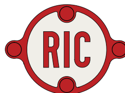
RIC-Schild zur nachträglichen Kennzeichnung der Bremsstellung P bei Kks-Bremsen im internationalen Verkehr
