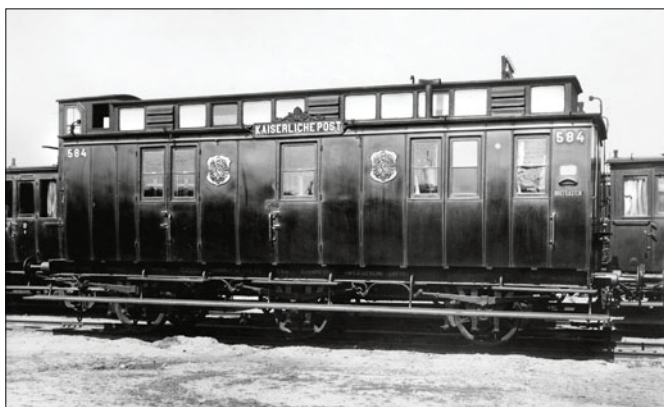
Bahnpostwagen Erfurt 584 Post3-b/8,5; Wagenkasten grün, Deckschienen schwarz, Absetzlinien gelb (Werkfoto 1870 Breslau)
