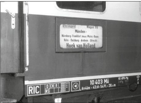
Wagenlaufschild, RIC-Raster, Anschriftenfeld und Bremsangaben am Rheingoldwagen 10403 Av4üm-62 (Foto 1963)
