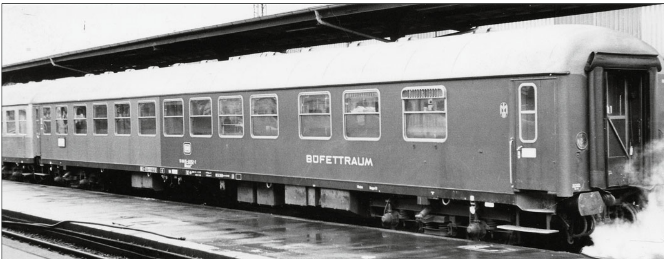
Oben: Schnellzugwagen DB 51 80 85-40 052-2 BRbuümh 282; Dach weißaluminium, Dachkante und Langträgerverkleidung schwarz, Wagenkasten chromoxidgrün links und purpurrot (Foto um 1969 Gerhard Krauth)
