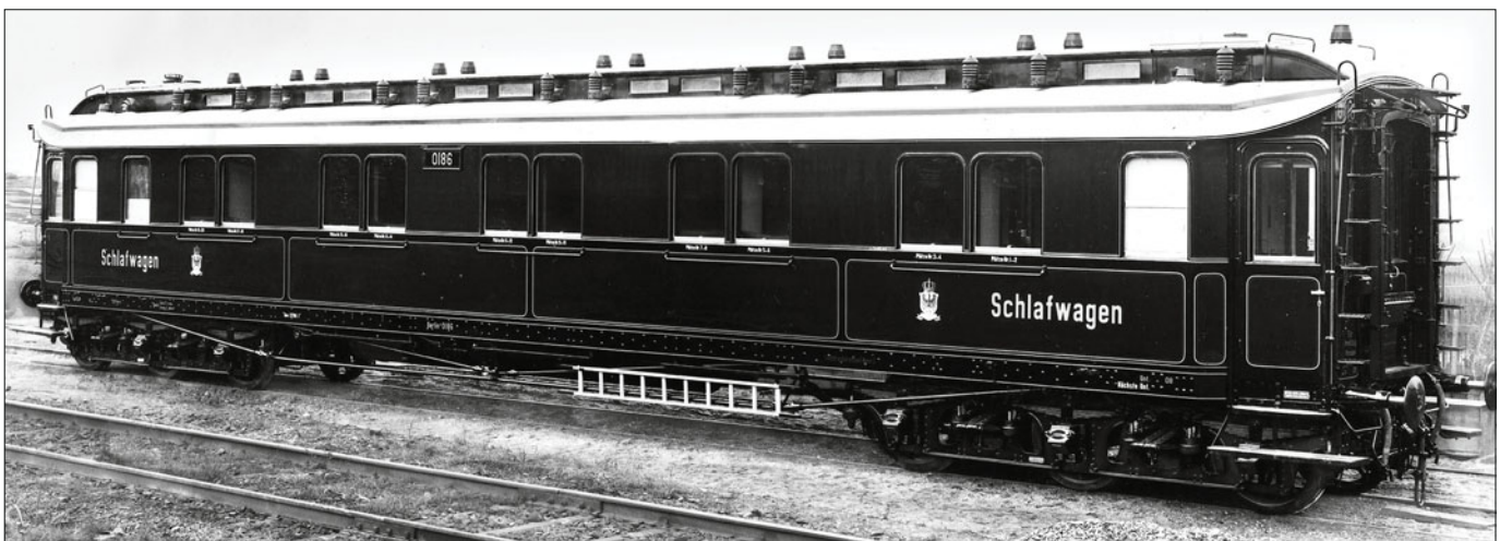
Schlafwagen Preußen 0186 Berlin Schlafü; Wagenkasten grün, Langträgerverkleidung, Brüstungsleisten und Deckschienen schwarz, Absetzlinien gelb, Anschriften gelb (Werkfoto 1908 Deutz)
