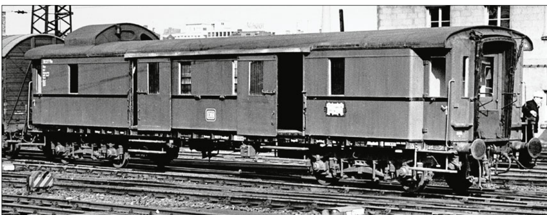
Gepäckwagen DB 112 277 Dye ex Pw4i-31; Wagenkasten chromoxidgrün, Brüstungsleisten, äußere Langträger und Drehgestelle schwarz (Foto Frankfurt (M) 1966 Franz Burkhardt)
