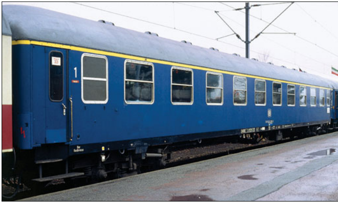
Schnellzugwagen DB 51 80 10-92 106-3 Am 203.1; Dach umbragrau, Wagenkasten kobaltblau, Langträgerverkleidung schwarz; Kennzeichnungstreifen goldgelb (Foto Hannover 1983 Detlef Behrendt)
