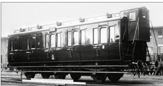
Abteilwagen Preußen Berlin 1263 A; ein rarer Wagen, er besitzt einen gelben Kennzeichnungsstreifen an allen Abteilen sowie Wendschilder für die 1. und 2. Klasse (Werkfoto 1909 Görlitz)
