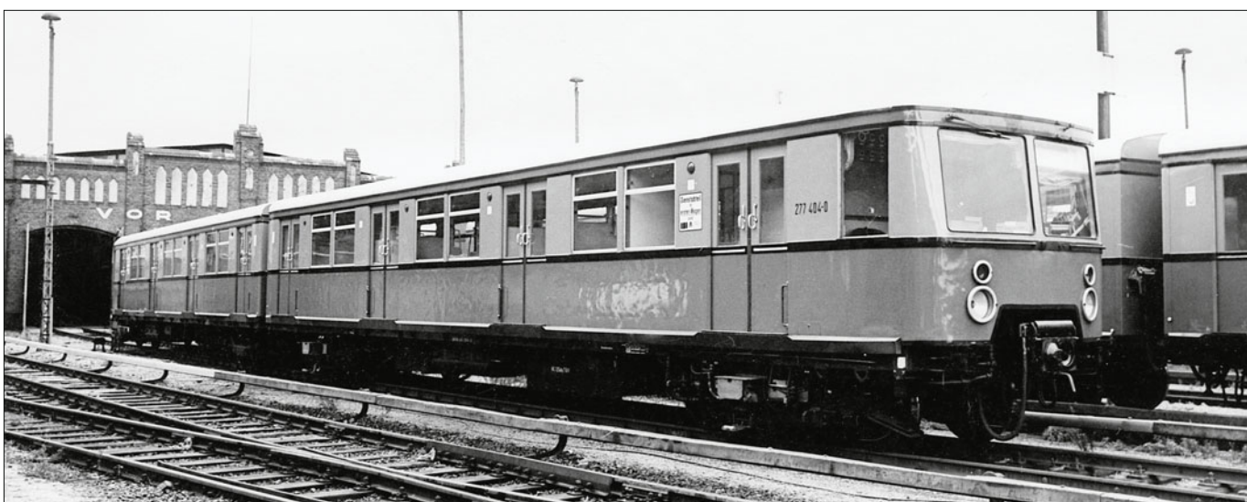
S-Bahn-Triebwagen DR 277 404-0; Dach hellgrau, Wagenkasten bordeaux, Fensterband rehbraun, Brüstungsleisten, Deckschienen und Rahmen schwarz (Foto um 1984 ZFIV)
