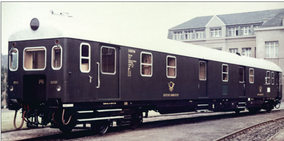
Bahnpostwagen DBP 6000 Post4mf-a/26; Dach weißaluminium, Wagenkasten flaschengrün, Langträgerverkleidung schwarz (Werkfoto 1953 Uerdingen)
