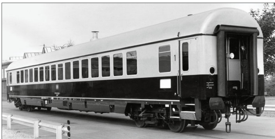
Schnellzugwagen DB 61 80 18-70 043-4 Apmz 121; Dach weißaluminium, Dachkante schwarz, Wagenkasten elfenbein und purpurrot, Zierstreifen elfenbein, Langträgerverkleidung und Schürzen schwarzgrau (Werkfoto 1972 Nürnberg)
