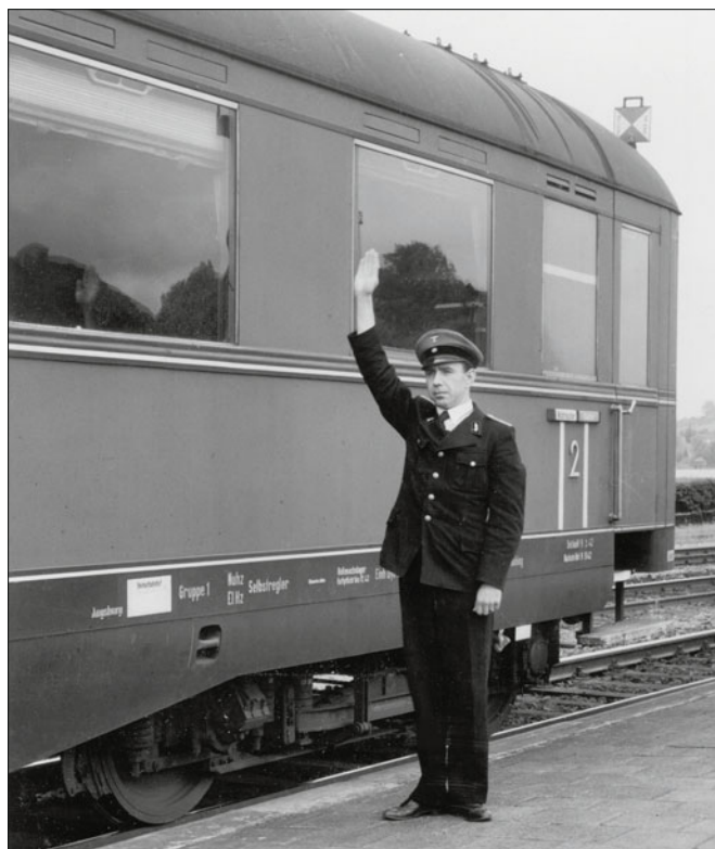
Schnellzugwagen DRB BC4ü mit zusätzlicher Kennzeichnung der 2. Klasse (Foto 1942)
