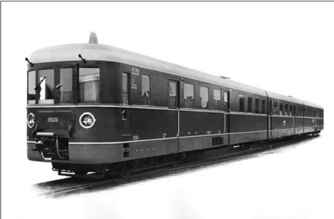
Verbrennungstriebwagen DRB 137 285 BCPw8ütrvT-35, Wagenkasten oxidrot, Dach aluminiumfarben, Zierstreifen betongrau, Schürzen umbragrau (Werkfoto 1939 Deutz Sammlung Joachim Deppmeyer)
