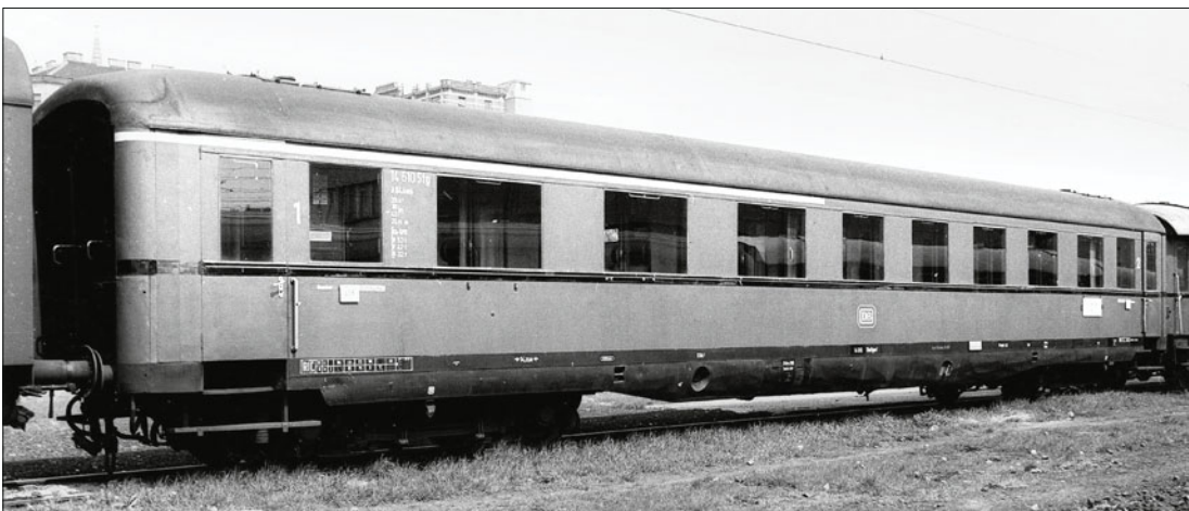
Schnellzugwagen DB 14 610 AB4üwe-39; Wagenkasten chromoxidgrün, Brüstungsleisten und Langträgerverkleidung schwarz, Schürzen grau; Kennzeichnungstreifen elfenbein (Foto Wien 1967 Hermann Heless)
