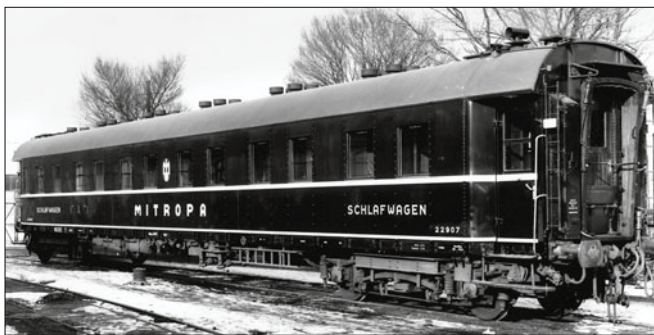
Schlafwagen Mitropa 22907 WLAB4ü mit rotem Wagenkasten, goldfarbenen oder gelben Zierstreifen und Anschriften, schwarzem Außenlangträger und aluminiumfarbenem Dach (Werkfoto 1932 Breslau)
