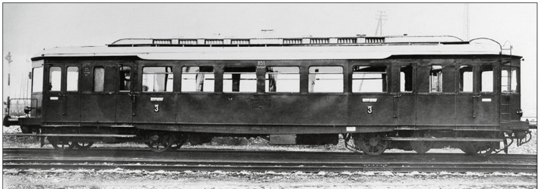
Verbrennungstriebwagen 851 C4vT-24 (Foto um 1925 Sammlung Emil Konrad)
