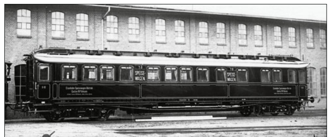
Speisewagen Preußen Frankfurt 70 von Riffelmann; Wagenkasten grün, Einfassungen, Brüstungsleisten und Deckschienen schwarz, Absetzlinien gelb (Werkfoto 1902 Görlitz)
