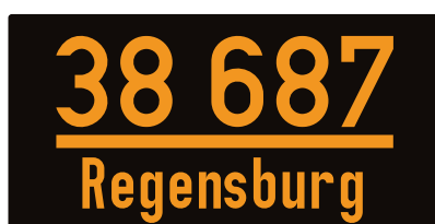
Nummernschild für Reisezugwagen nach dem Nummernplan von 1930 mit Unterstreichung der Wagennummer
