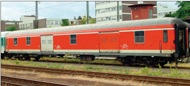
Gepäckwagen DB AG 50 80 92-40 013-6 Dd 498; Dach und Langträgerverkleidung basaltgrau, Dachvouten und Wagenkasten verkehrsrot, Zierstreifen lichtgrau, nicht nutzbare Ladetüren verkehrsrot nutzbare Ladetüren lichtgrau, Rahmen und Drehgestelle schwarz (Foto Darmstadt 2001)
