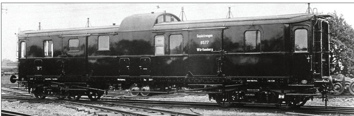
Gepäckwagen Württemberg PPü 8577; Wagenkasten dunkelgrün, Einfassungen, Brüstungsleisten und Deckschienen schwarz (Werkfoto 1908 Heidelberg)
