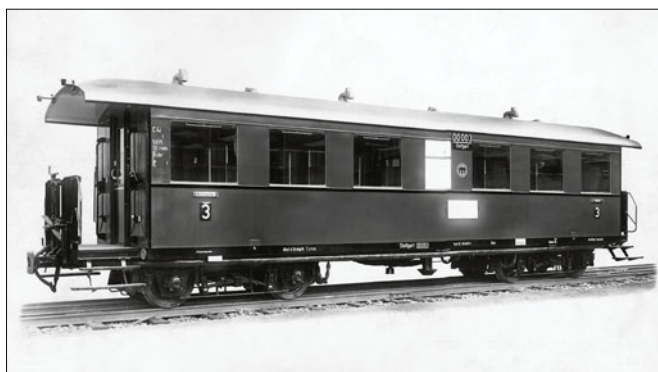
Schmalspurwagen DRB Stuttgart 3 C4ism-35 im Regelanstrich der Reichsbahn (Werkfoto 1935 Esslingen)
