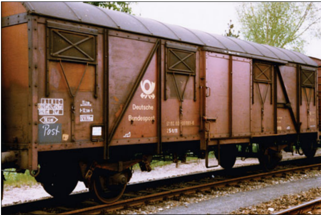
Bahnpostwagen DBP 51 80 00-01 993-6 Post2s-t/11; Dach und Lüftungsschieber weißaluminium (hier stark verschmutzt), Wagenkasten rotbraun, Rahmen schwarz (Foto 1989 Thomas Landwehr)
