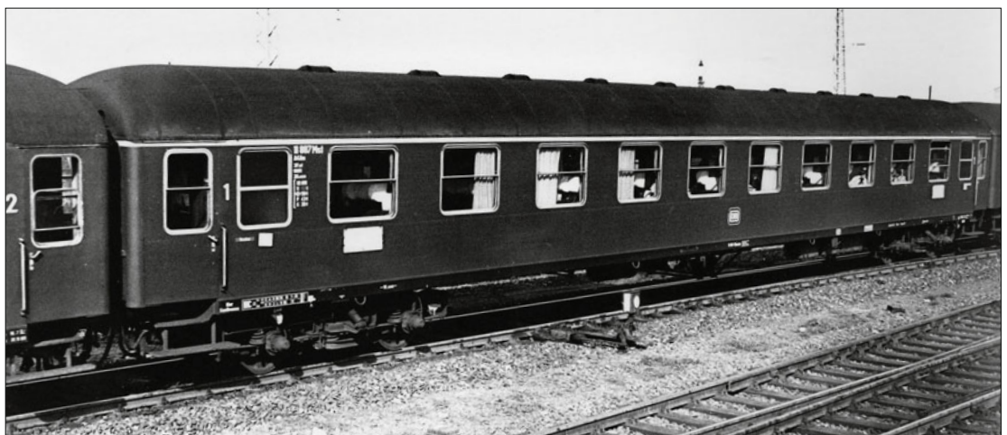
Schnellzugwagen DB 11 887 A4üm-54; Wa- genkasten kobaltblau, Langträgerverkleidung schwarz, Kennzeich- nungsstreifen elfen- bein (Foto Bonames 1965 Franz Burkhardt)
