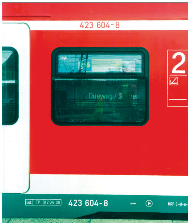
Elektrotriebwagen DB AG 423 604-8 mit Betriebsnummer an der Langträgerverkleidung und im oberen Zierstreifen (Foto München Allach 2000 Thomas Landwehr)
