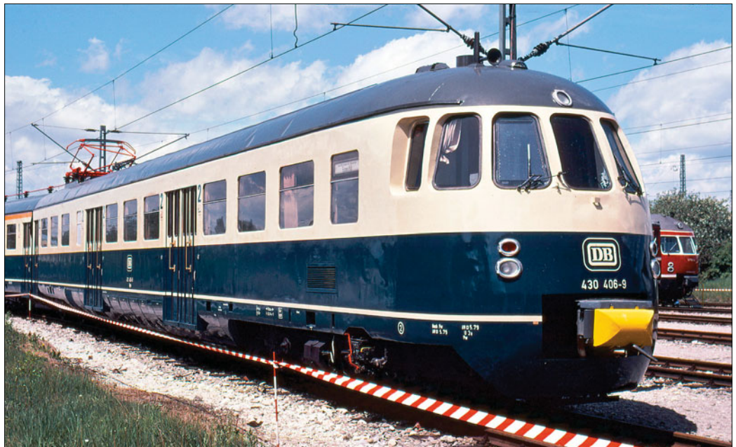
Elektrotriebwagen DB 430 406-9; Dach umbragrau, Wagenkasten elfenbein und ozeanblau, Langträgerverkleidung und Schürzen ozeanblau, Zierstreifen elfenbein, Kupplungskappe goldgelb (Foto Freimann 1979 Reiner Rössle)
