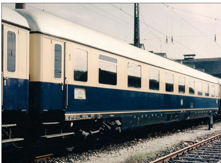
Rechts: Schnellzugwagen DB 10 421 Av4üm-62; Dach weißaluminium, Dachkanten schwarz, Langträgerverkleidung und Schürzen schwarzgrau, Wagenkasten beige und kobaltblau, Zierstreifen beige (Foto um 1962 Sammlung Wolfgang Bündgen)
