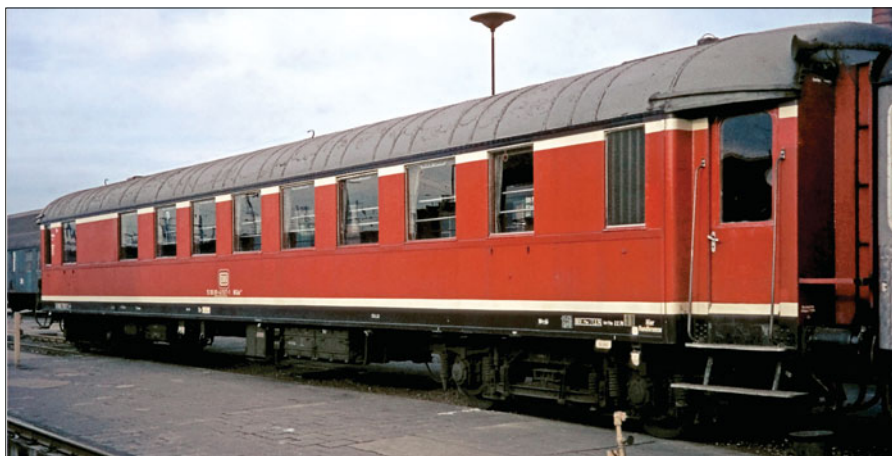
Gesellschaftswagen DB 51 80 89-10 555-6 WGYg(e) 831.1; Dach umbragrau, Dachkante schwarz, Wagenkasten purpurrot, Zierstreifen elfenbein, Langträgerverkleidung schwarz (Foto Saarbrücken 1970 Günter Tscharn)
