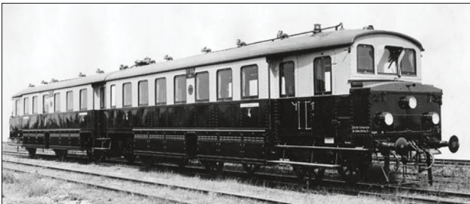
Speichertriebwagen DRB Halle AT 613+AT 614 CDP3üeaT+D3üeaT-26 mit Anstrich in beige und weinrot am Wagenkasten (Werkfoto 1928 Mombach)
