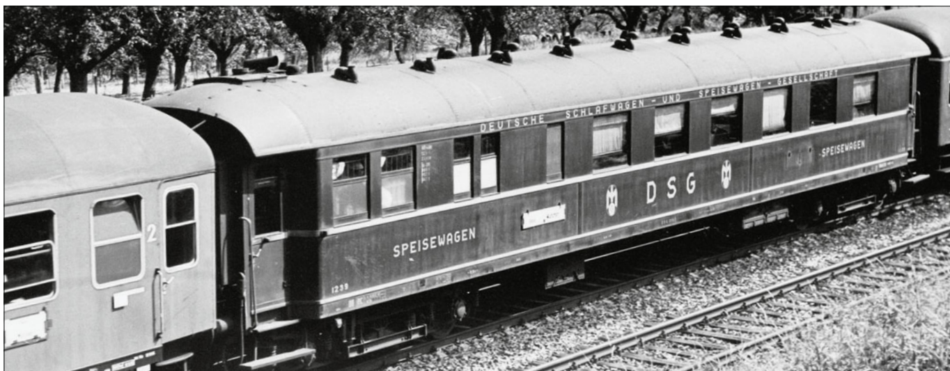
Speisewagen DSG 1239 WR4ü; Dach weißaluminium, Wagenkasten rot, Brüstungsleiste, Zierstreifen und Anschriften gelb, Langträgerverkleidung und Drehgestelle schwarz (Foto Bonames 1966 Franz Burkhardt)
