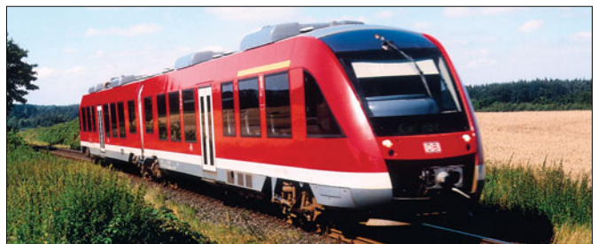
Nahverkehrstriebwagen DB AG 648; Wagenkasten verkehrsrot, Zierstreifen und Türen lichtgrau, Schürzen und Dachaufbauten fenstergrau, Kennzeichnungsstreifen goldgelb (Werkfoto Salzgitter)
