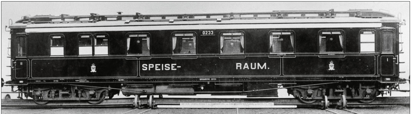
Schnellzugwagen mit Speiseraum Preußen 0233 Bromberg ABBü; Wagenkasten grün, Langträgerverkleidung, Brüstungsleisten und Deckschienen schwarz, Absetzlinien gelb, Anschriften gelb; bemerkenswert auch hier wieder das noch weiße Dach (Werkfoto 1905 Görlitz)
