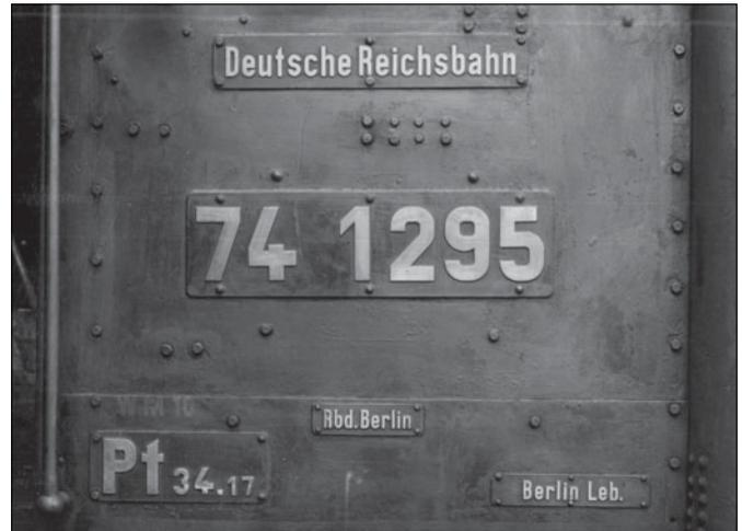
Lok 74 1295 zeigt die Regelanordnung von Eigentums-, Betriebsnummern-, Direktions-, Heimat- und Gattungsschildern auf der rechten Lokseite, zusätzlich ist das Lagermetall der Stangenlager angeschrieben
