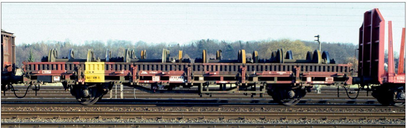
Niederbordwagen DB Kls-x 448, 42 80 346 7 030-0 als Wagen für Radsätze mit gelbem Feld (Foto Kranichstein 1996 Hans Ulrich Diener)
