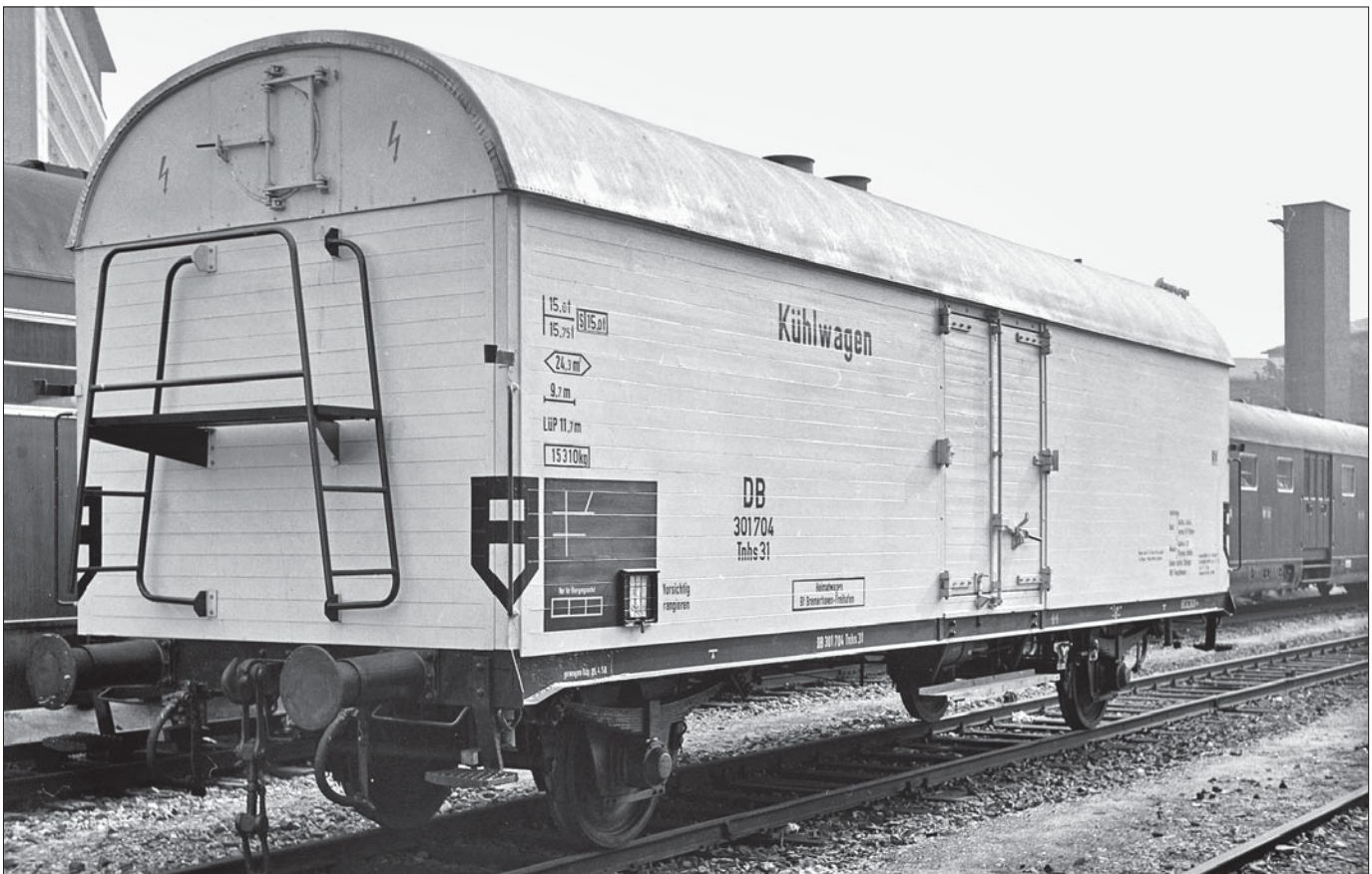
Dieser 1958 aufgenommene Kühlwagen 301 704 der Bauart Tnhs 31 trägt noch die älteren Angaben zu Ladegewicht und Tragfähigkeit im liegenden T. Daneben ist die Angabe S mit Ladegewicht für den Einsatz in schnelfahrenden Zügen zu erkennen. Beide Anschriften waren bis 1959 durch den Lastgrenzraster zu ersetzen. (Foto Stuttgart 1958 Fritz Willke)
