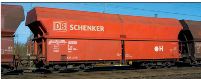
Schüttgutwagen Falns 121 der DB Schenker Rail AG, 81 80 6646 194-3 (Foto Koblenz-Lützel 2014 Armin Schwarz)
