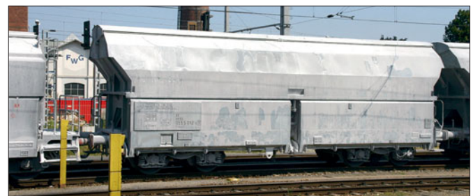
Durch Kalkbeförderung verschmutzter Schüttgutwagen Talns 968, 83 80 066 5 012-4 mit ausgeschnittenen „Anschriften“ (Foto Bebra 2005 Rudolf Ossig)
