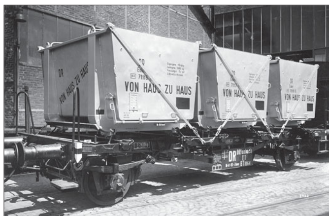
Die Deutsche Bundesbahn führte mit der neuen Wagengattung BT (Behälter-Tragwagen) auch den neuen Gattungsbezirk „Offenbach“ ein. An dem hier abgebildeten Wagen sind die entsprechenden Anschriften gut zu erkennen. (Werkfoto 1951 Siegen, Besser)
