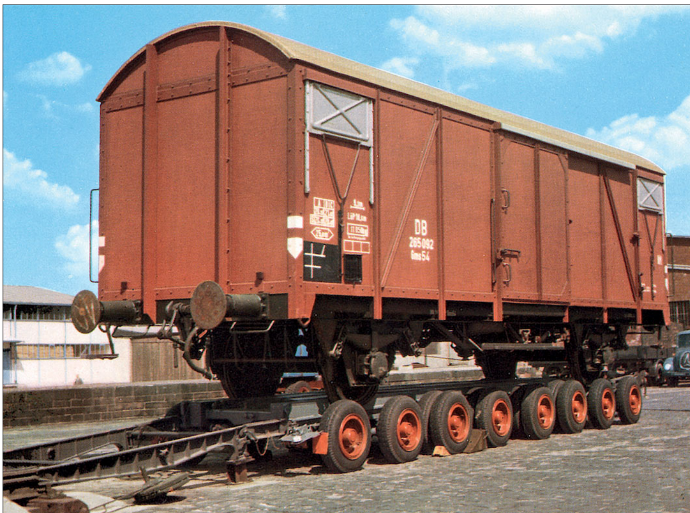
Der gedeckte Güterwagen 295 092 ist hier in der Standardfarbgebung mit gelblich grauem Dachbelag, rotbraunem Wagenkasten und schwarzem Untergestell zu sehen. Die Lüftungsschieber sind weißaluminium, die Schreibflächen und Zettelhalter sowie Schiebergestänge, Türverschlüsse, Türfeststeller und Signalstützen schwarz. (Foto DB Palm, Sammlung Richard Schatz)
