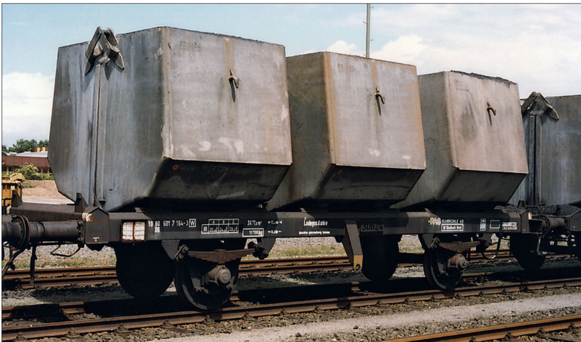
Kübelwagen DB 10 80 601 7 164-3 der Ruhrkohle AG mit dem Kennzeichen W für Werkwagen (Foto Duisburg-Ruhrort 2003 Thomas Losh)
