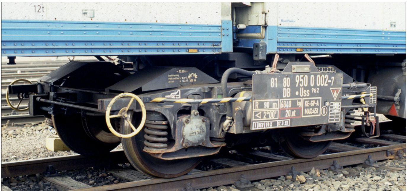
Auch ein Güterwagen: Das Drehgestell für den „RoadRailer“ der Uss 982 DB 81 80 950 0 002-7 ist weitestgehend nach den Regeln der DB beschriftet, die Ziffern der Wagen- und Bauartnummer sind bereits nach DIN 1451, Teil 2, Schriftform A ausgeführt. Die Kreisfläche vor dem Gattungszeichen ist überflüssig. (Foto Kranichstein 1994 Hans Ulrich Diener)
