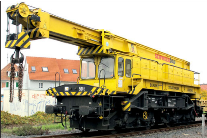
Kranwagen EGK 300/5, Nr. 97 82 31 501 17-9 D-SBAU des privaten Bahnbauunternehmens Schweerbau mit der Betriebsnummer nach dem Schema für die Nummerierung nach dem Nummernschlüssel für Nebenfahrzeuge der DB AG 205 (Foto Reinheim 2015)
