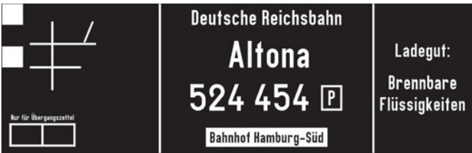
Tafel für amtliche Anschriften an Kesselwagen 1922 (1:25)
