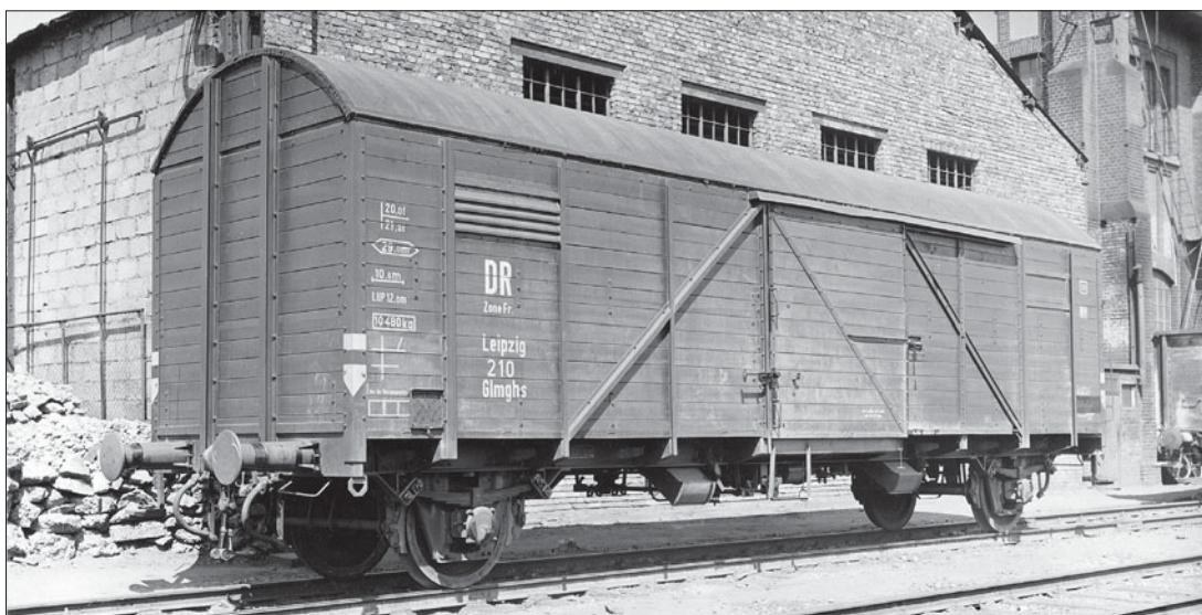
Der gedeckte Güterwagen Leipzig 210 Glmghs gehörte zum Bestand der Südwestdeutschen Eisenbahnen (SWDE, Nachfolgerin der Deutschen Reichsbahn in der französischen Besatzungszone) und führte deshalb das Zonenzeichen Zone Fr. (Foto Osnabrück 1949 Rudolf Klitscher)
