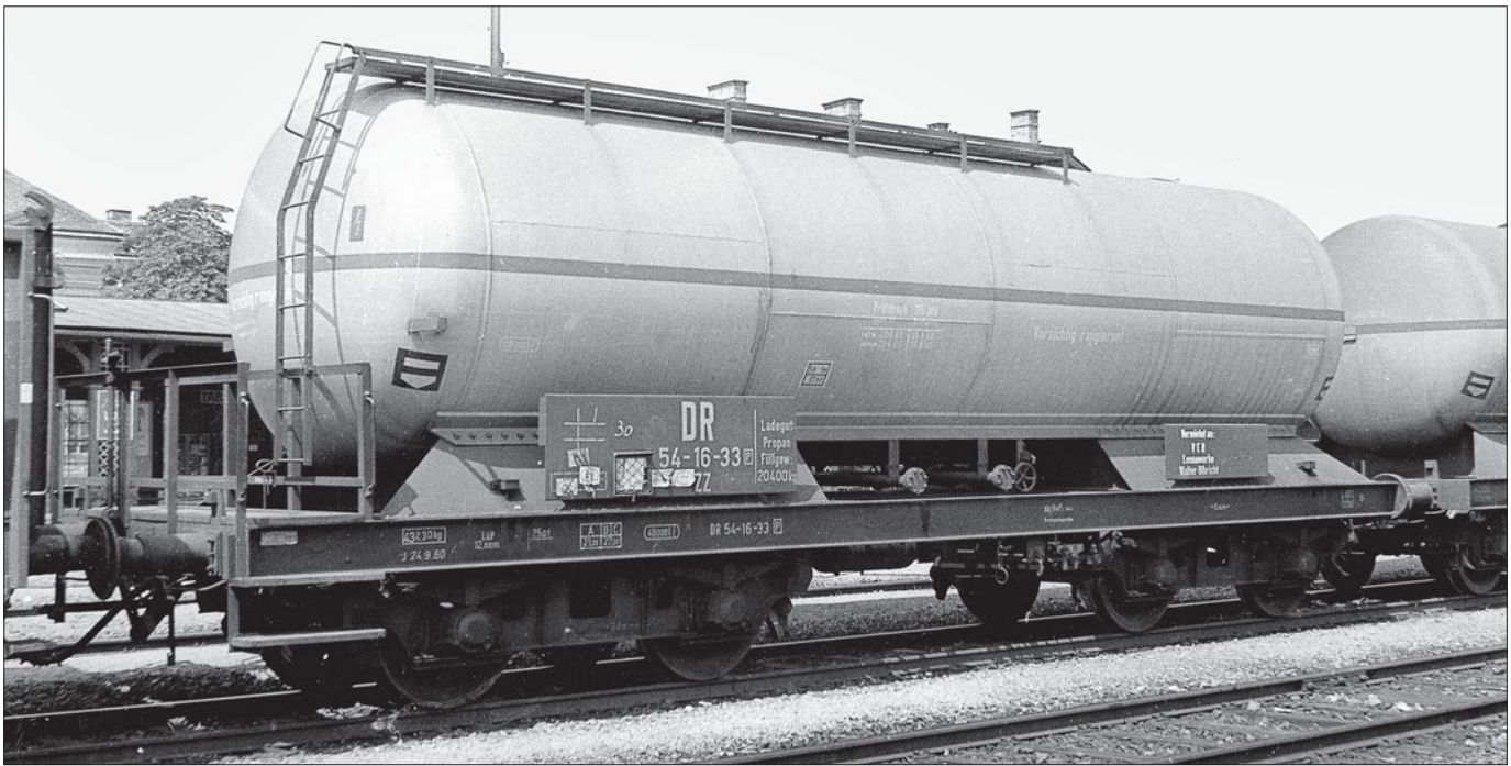
Druckgaskesselwagen DR 54-16-33 ZZ, vermietet an VEB Leunawerke Walter Ulbricht, Ladegut Propan, roter Erkennungsstreifen in Kesselmitte (Foto 1960, Sammlung Hermann Heless)
