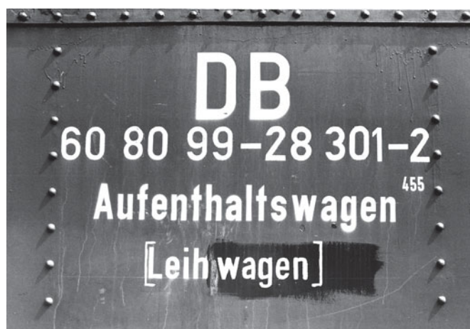
Anschrift am Aufenthaltswagen 455, DB 60 80 99-28 301-2; die Anschrift „Leihwagen“ weist darauf hin, dass dieser Wagen vom AW Limburg für den leihweisen Austausch gegen auszubessernde Wagen bereitgehalten wird. (Foto Limburg 1977 Johannes Glöckner)
