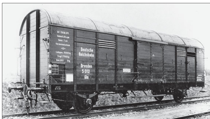
Am 27. September 1922 erhielt die Deutsche Reichsbahn diesen großräumigen gedeckten Güterwagen. Seine Anschriften sind bereits nach den Vorschriften des Arbeitsplanes für die Umzeichnung der Güterwagen ausgeführt. (Foto 1922)
