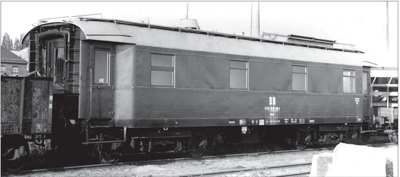
Der Heizwagen 57 50 99-60 165-3 hat als Bahndienstwagen der Personenwagenbauart einen grünen Wagenkastenanstich, das Dach ist hellgrau, Langträgerverkleidung und Rahmen sind schwarz gestrichen. (Foto Reichenbach 1979 Günter Meyer)
