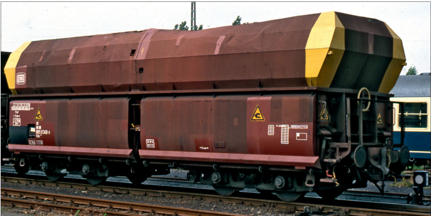
Übergangswagen Fals 175 Nr. 82806650349-5 mit automatischer Schraubenkupplung und der dazugehörigen Kennzeichnung durch Anstrich an den oberen Wagenecken (Foto Emden 1993 Harald Westermann)
