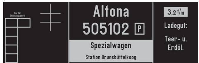
Tafel für amtliche Anschriften an Kesselwagen 1913 (1:25)
