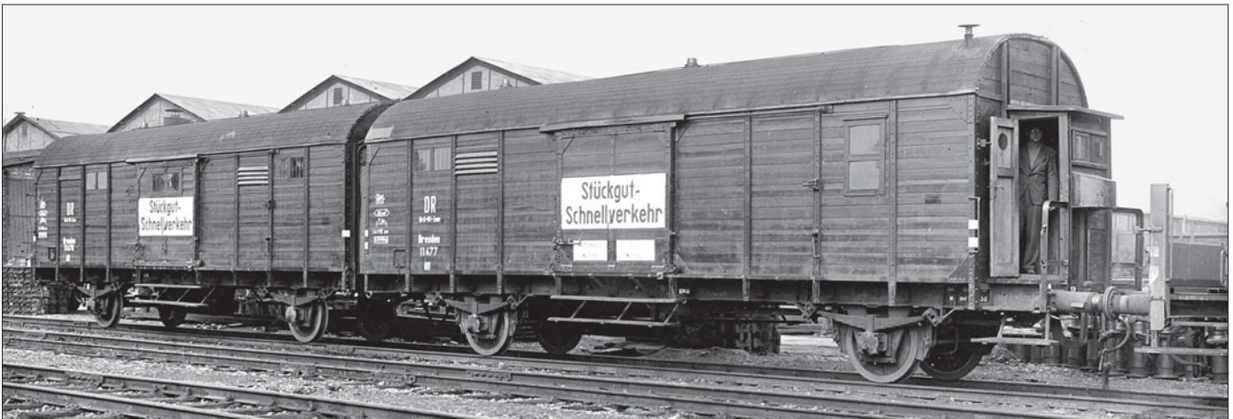
Dresden 11477 + 11478 Gll: Zur auffälligen Kennzeichnung der Leigeinheiten wurde die Anschrift Stückgut-Schnellverkehr zunächst auf den Schiebetüren angebracht. (Foto Osnabrück 1950 Rudolf Klitscher)
