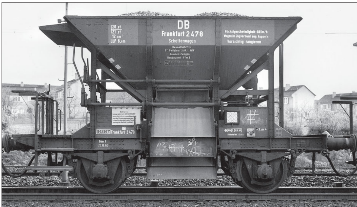
Schotterwagen der Deutschen Bundesbahn Frankfurt 2478, Neubauamt Ffm 3 (Foto Frankfurt [M] 1966 Franz Burkhardt)
