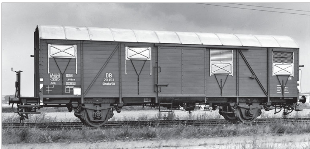
Die Regelschriften eines gedeckten Bundesbahn-Güterwagens sind auf diesem Bild des Glmehs 50 gut zu erkennen. (Werkfoto 1954 Braunschweig)
