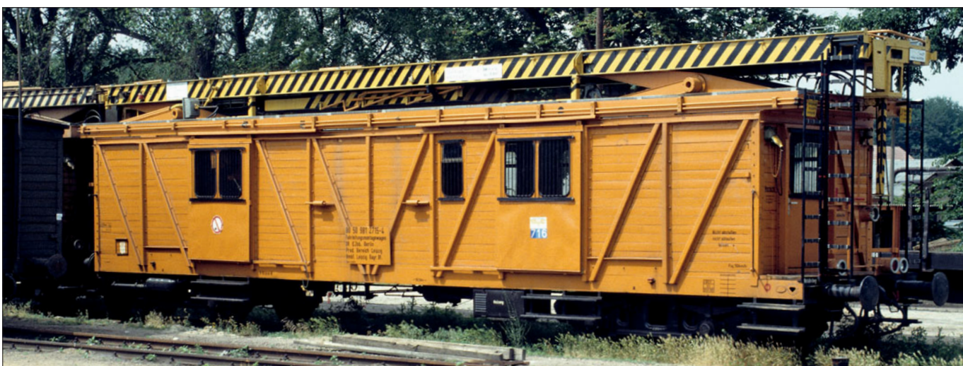
Fahrleitungsmontagewagen DR 80 50 981 2715-4 mit orangegelbem Anstrich (Foto Wiesenburg 1992 Hans Ulrich Diener)
