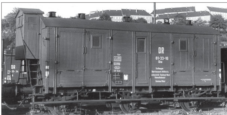
Stoffwagen DR 81-33-16 des Oberbauwerks Wülknitz, früher Stallungswagen (Foto Aue 1965 Günter Meyer)
