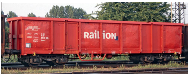
Offener Güterwagen Eaos-x 075 der Railion AG, 31 80 536 0 160-1 mit Railion-Zeichen Ausführung 2 (Foto Mannheim 2004 Hans Ulrich Diener)
