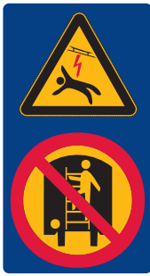
Warnzeichen Gefahr durch Fahrdraht, Verbot Wagen zu besteigen (1:10)
