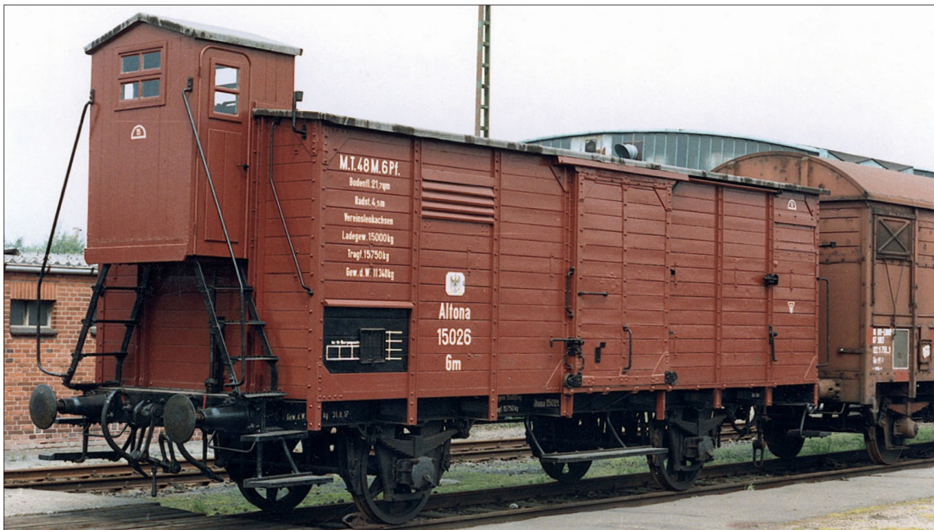
Dieser gedeckte Güterwagen Altona 15026 Gm wurde ebenfalls anlässlich des Jubiläums der deutschen Eisenbahnen im Jahre 1985 restauriert und 1991 neu lackiert und beschriftet. Er ist im Zustand des Jahres 1917 mit dem Anstrich und den Anschriften nach den Regeln des Deutschen Staatsbahnwagenverbands versehen. Die schwarzen Streifen an den Eckprofilen des Wagenkastens und des Bremserhauses sind nicht vorhanden. Regelwidrig sind das Ladegewichtszeichen (weiß statt schwarz auf weißem Grund) und die Form des Gitters für die Gestellungszeiten. Der Zettelkasten ist überflüssig. (Foto Hamburg 1991 Benno Wiesmüller)
