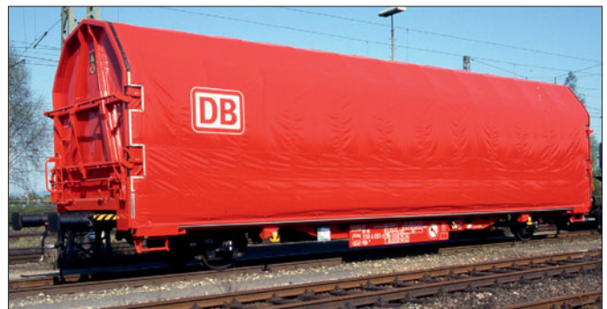
Flachwagen mit Plane Kijls 450 der DBAG, 41 80 338 4 091-3 mit einfachem DB-Zeichen (Foto Mannheim 2002 Hans Ulrich Diener)
