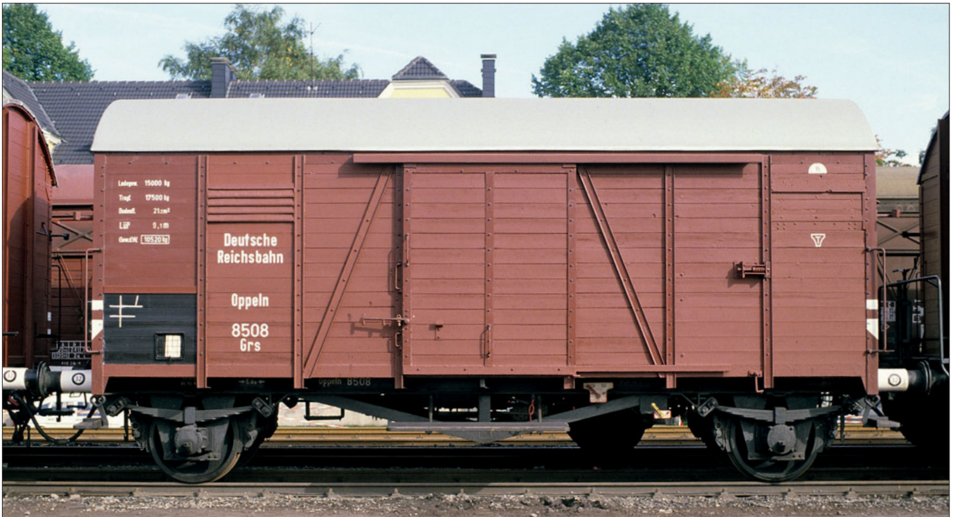
Ein weiterer Museumswagen der Deutschen Bundesbahn empfindet die Reichsbahnzeit nach: Der Oppeln 8508 Grs hat ebenfalls einen rotbraunen Wagenkasten und schwarzes Untergestell sowie schwarzes Feld für Kreideanschriften. Die Pufferhülsen sind weiß gestrichen, um den Wagen als Umsetzwagen zu kennzeichnen. Die Anschriften sind auf dunklem Grund weiß und auf hellem Grund schwarz ausgeführt. Das hellgraue Dach ist für diesen mit Dachdecke eingedeckten Wagen denkbar. Die Beschlagteile am Wagenkasten müssten schwarz gestrichen sein (Foto Dahlhausen 1985).
