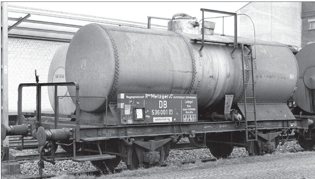
Kesselwagen für Wein, nasse Schlempe und Obstsaft DB 536 001 der Firma Robert Metzger & Co (Foto Frankfurt [M] 1966 Franz Burkhardt)
