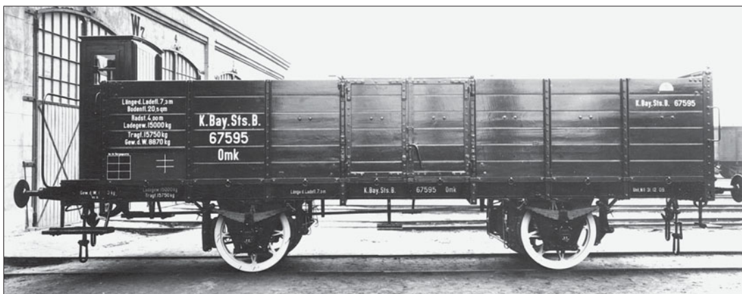
Der 1908 gelieferte offene Güterwagen 67595 Omk besitzt schließlich Anschriften, die formal nicht mehr von den preußischen Musterzeichnungen abweichen. (Werkfoto 1908 Nürnberg)
