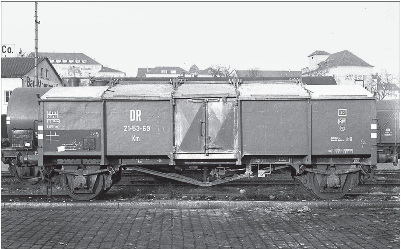
Die Güterwagen der Deutschen Reichsbahn in der DDR wurden 1951 mit neuen Wagennummern beschriftet, die sich aus drei zweistelligen Zahlen, getrennt durch Bindestriche, zusammensetzten. Dieses Bild zeigt einen Klapptopfwagen der Bauart Km-21 mit den entsprechenden Anschriften. (Foto Stuttgart 1955 Fritz Willke)
