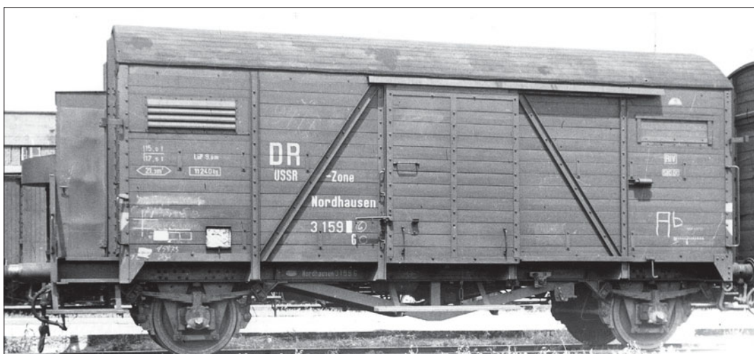
Der gedeckte Güterwagen des Gattungsbezirks Nordhausen entstammt einer Nachkriegslieferung an die Deutsche Reichsbahn in der Sowjetischen Besatzungszone. Der Wagen wurde nach 1948 aufgenommen und trägt das Zonenzeichen „USSR-Zone“, um ihn als dem Wagenpark der DR in der sowjetischen Besatzungszone zugehörig zu kennzeichnen. (Foto um 1949 Fritz Willke)
