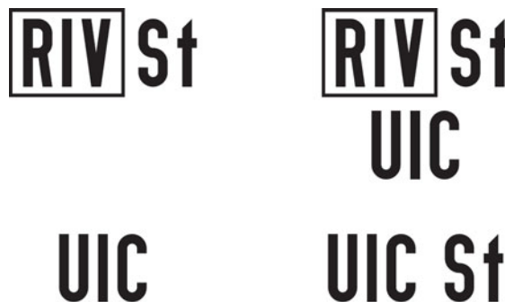
Zeichen für Einheitsgüterwagen (links) und Standardgüterwagen (rechts), bis 1977 (oben) und ab 1977 (unten) (1:10)
