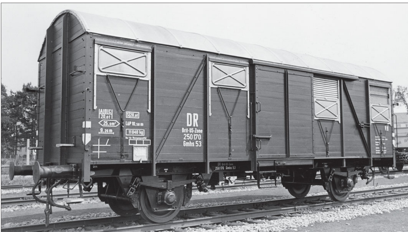
Noch 1953 wurden neue Wagen der DB wie dieser Gmhs 53 mit dem Eigentumszeichen DR Brit-US-Zone, aber bereits mit neuer Wagennummer und Gattungs- und Bauartbezeichnung abgeliefert. (Foto Minden 1953 DB, Bustorff)
