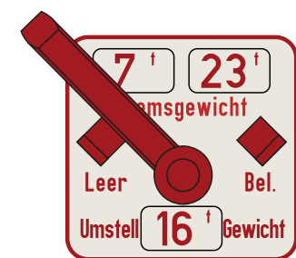
Schildlager für die Bremsumstellung leer - beladen, mit Brems- und Umstellgewichten (1:5)
