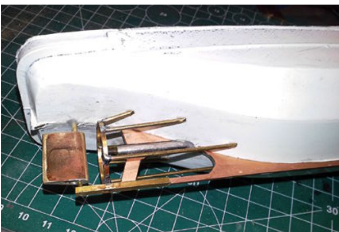
Aufbau des Eiskäfigs und des Ruders
