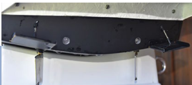
Funktionstüchtige Trimmklappen gekoppelt an die Ruderstellung
