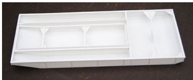
Der Aufbau des Rumpfes erfolgt aus Polystyrolplatten
