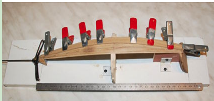
Einpassen der Planken auf den Spant und die Endpunkte
