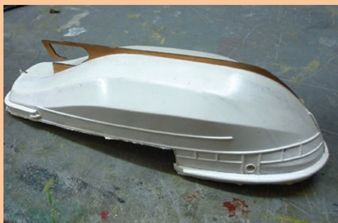
Der GFK-Rumpf mit einlaminierter Ruderhacke
