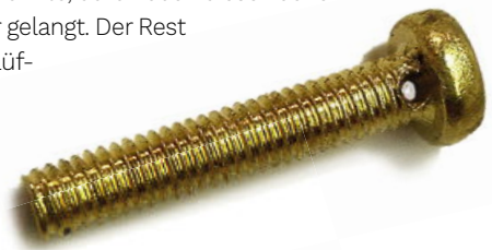
Die Messingschrauben werden mit einer Bohrung versehen
