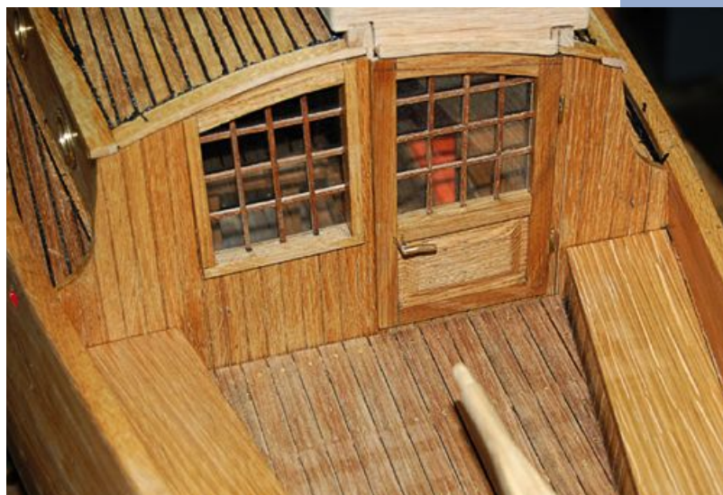
Die Plicht im Bau, die Kalfaternähte trocknen noch
