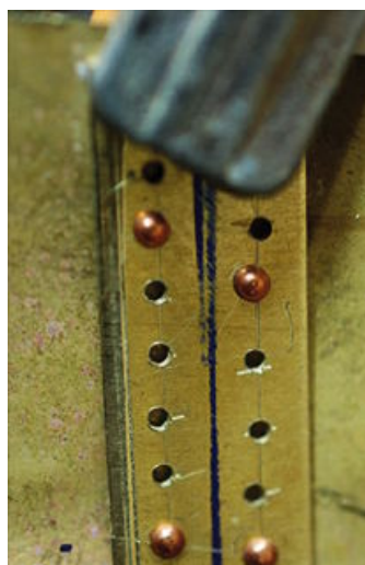
Innenbord-Doppelung eines Plankenstoßes
