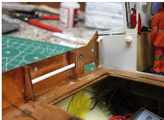
Verstärkungen um die Speigatten werden aus Draht einfach aufgelötet – und der Steuermann hat auch schon seinen Platz
