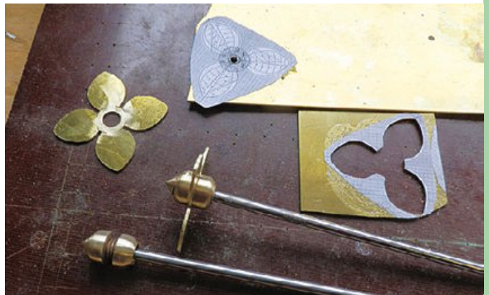
Die montierten Propeller – die Flügel werden jetzt noch mit der entsprechenden Steigung versehen und alles weich verlötet
