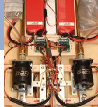
Die neue Antriebsanlage: bürstenlose Außenläufer, dazwischen die Controller. Vor den beiden Fahrakkus die LiPo-Saver
