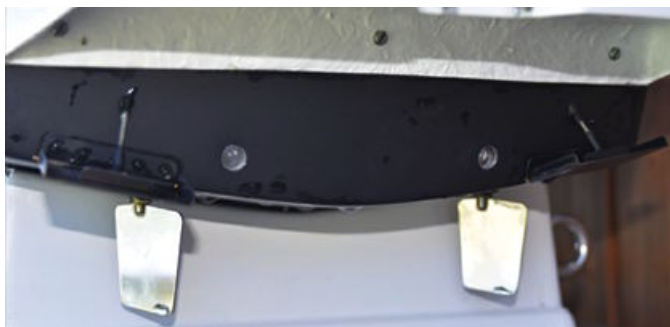
Funktionstüchtige Trimmklappen gekoppelt an die Ruderstellung
