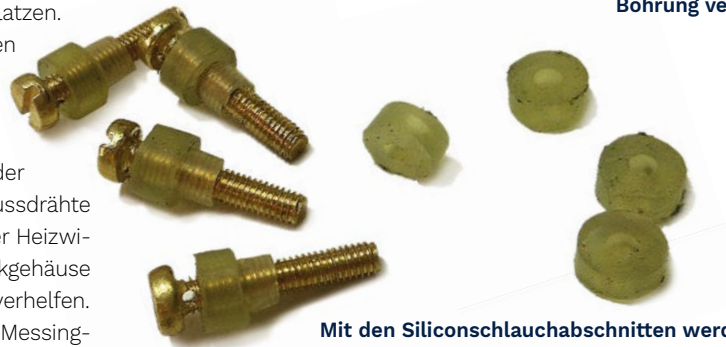
Die Messingschrauben werden mit einer Bohrung versehen
