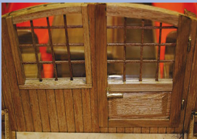
Achterschott im Bau
