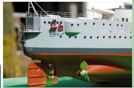
Die montierten Propeller – die Flügel werden jetzt noch mit der entsprechenden Steigung versehen und alles weich verlötet
