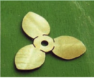
Drei- und vierflügeliger Propeller aus Messingblech ausgesägt
