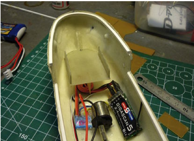
Eine Akkutasche aus GFK-Platten ...
