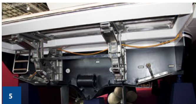
5 Die Mechanik der absenkbaren Badeplattform an einer AZIMUT 80'
