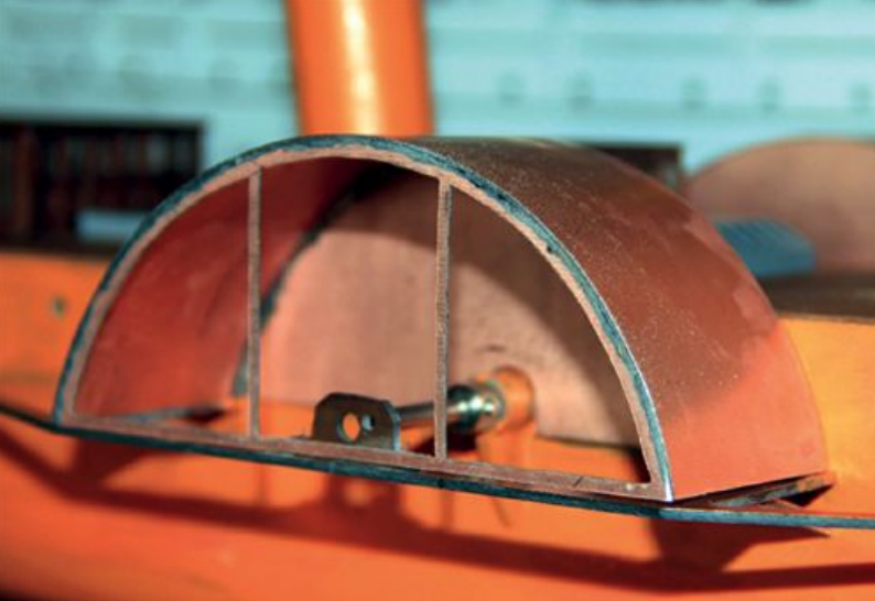
▲ Die Radkästen bestehen aus Leiterplattenmaterial. Die hier noch nicht montierten äußeren Abdeckungen sind geätzt
