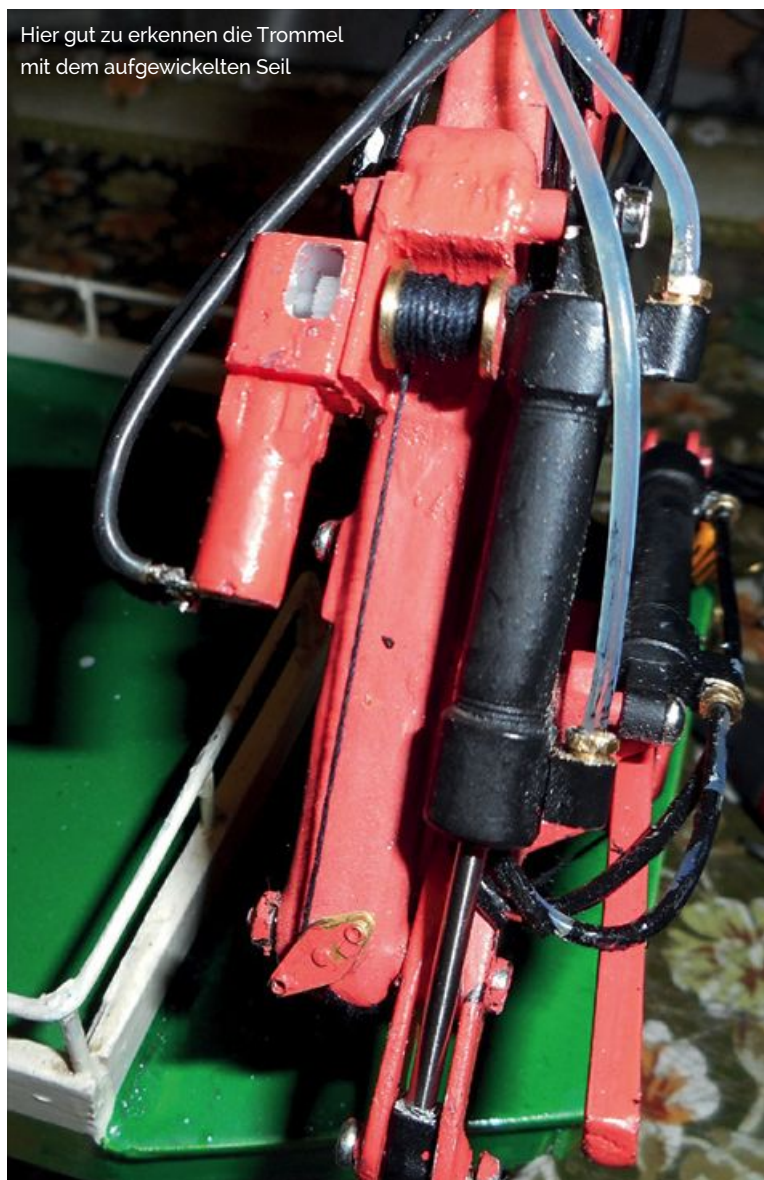
Die Seiltrommel mit dem links daneben zu sehenden Motor mit Getriebe
