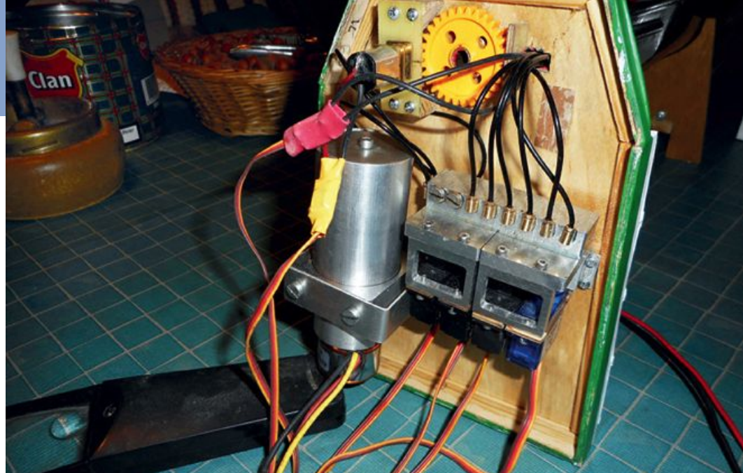
▲ Oben zu erkennen der neue Drehantrieb des Krans mittels Micropile-Getriebemotor
