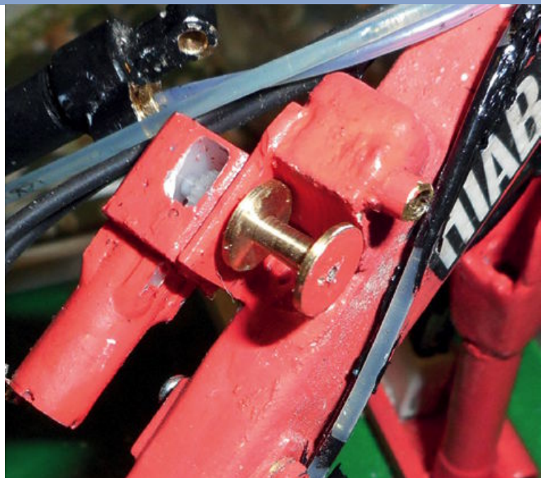
Die Seiltrommel mit dem links daneben zu sehenden Motor mit Getriebe
