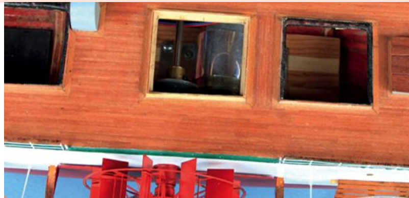
▲ Die Schaufelräder sind auf einer durchgehenden Achse befestigt
