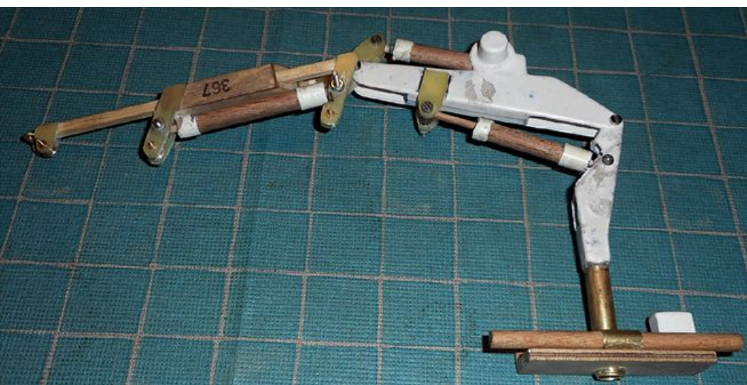
Für die Ermittlung der Abmessungen der Zylinder wurden provisorische Zylinder aus Holz und Kunststoff angefertigt
