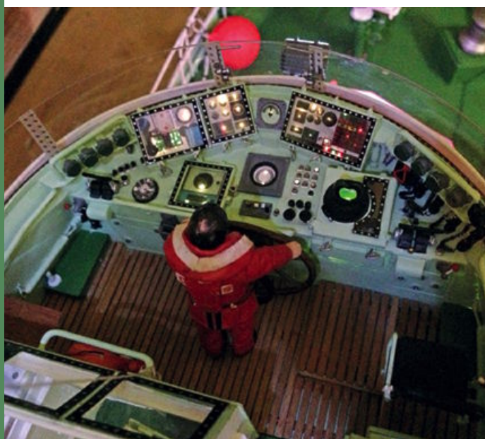
Die Instrumente sind mit Lichtleitfasern beleuchtet
