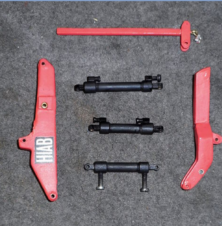
Kranteile und die Hydraulikzylinder
