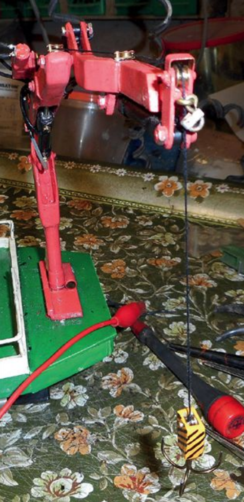
▲ Oben zu erkennen der neue Drehantrieb des Krans mittels Micropile-Getriebemotor
