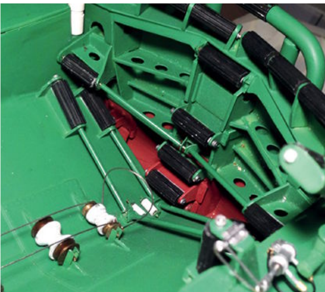
Mit dieser Drahtschlaufe wird das Tochterboot eingefangen
